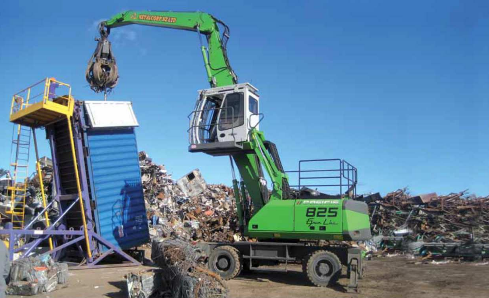
825 M - Ausrüstung K12 - 600 Liter Mehrschalengreifer - Neuseeland 825 M - equipment K12 - 600 litre orange-peel grab - New Zealand
