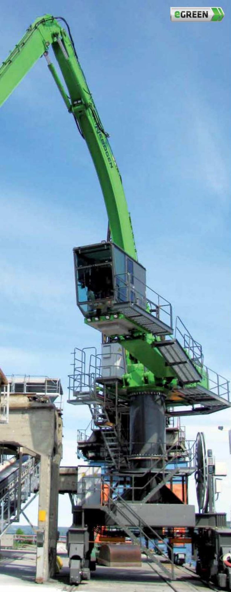
870 mit Schienenportalunterwagen und spiralig wickelnder Motorleistungstrommel als Energiezuführung 870 with rail gantry and monospiral motorized cable reel as energy supply
