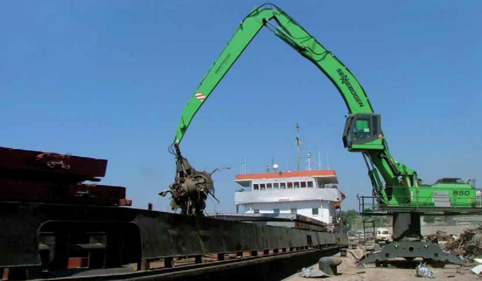
850 M spezial - 1,5 m Pylon - Ausrüstung B20 - 1.200 Liter Mehrschalengreifer - Russland 850 M special - 1.5 m pylon - equipment B20 - 1,200 litre orange-peel grab - Russia
