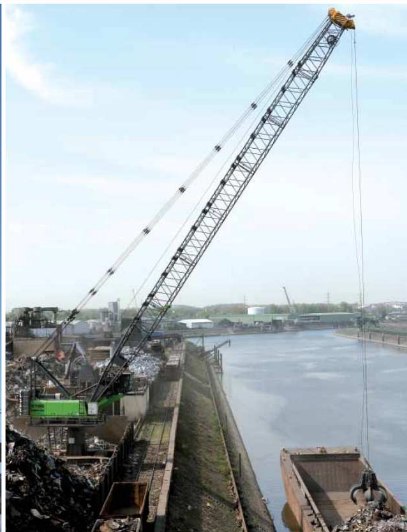
6180 HCC - 4 m Pylon - 46,7 m Auslegerlänge - 6.500 Liter Mehrschalengreifer - Deutschland 6180 HCC - 4 m pylon - 46,7 m boom length - 6,500 litre orange-peel grab - Germany
