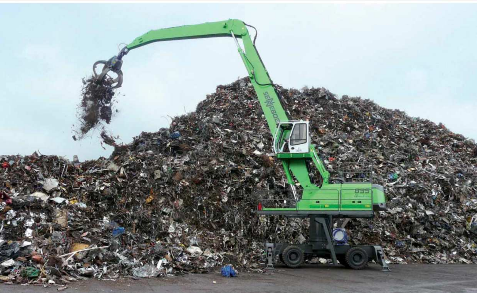
835 M spezial – 1,5 m Pylon – Ausrüstung K18 – 1.000 Liter Mehrschalengreifer – Belgien 835 M special – 1.5 m pylon – equipment K18 – 1,000 litre orange-peel grab – Belgium
