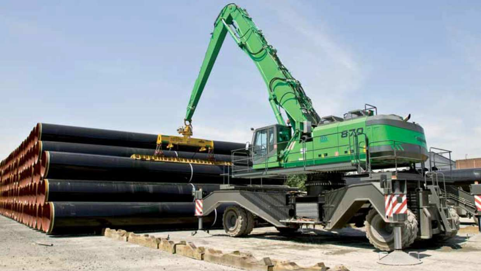
870 M spezial mit Unterwagen MS100 – Ausrüstung K18 – Vakuumtraverse – Deutschland 870 M special with undercarriage MS100 – equipment K18 – vacuum lifting device – Germany
