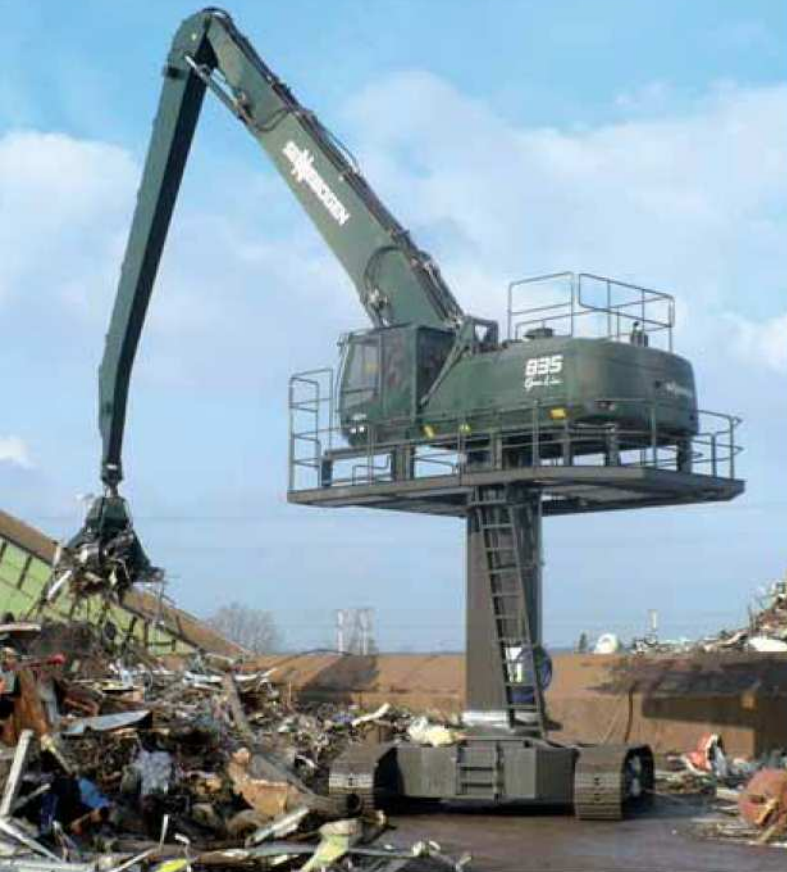
835 R spezial - 5 m Pylon - Ausrüstung K20 - 800 Liter Mehrschalengreifer - Frankreich 835 R special - 5 m pylon - equipment K20 - 800 litre orange-peel grab - France
