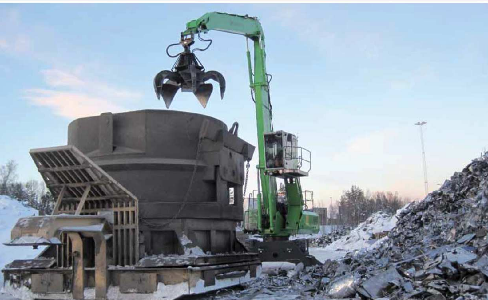
830 M – Ausrüstung K15 – 800 Liter Mehrschalengreifer – Schweden 830 M – equipment K15 – 800 litre orange-peel grab – Sweden
