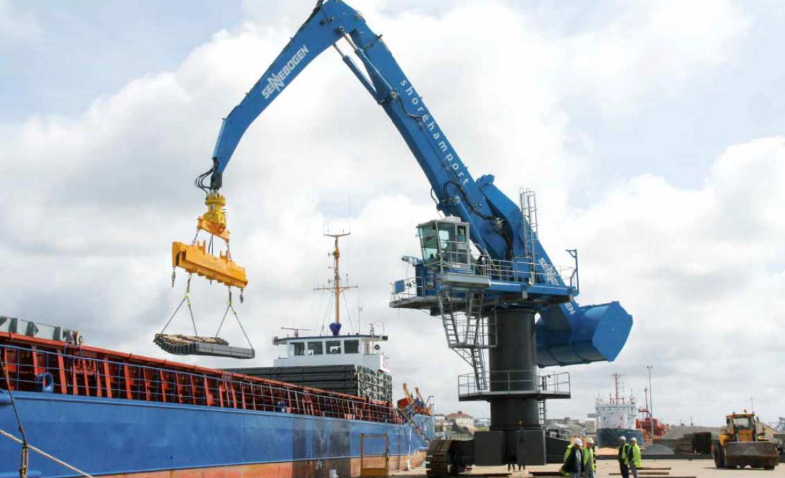
880 EQ R spezial – 6 m Pylon – Ausrüstung K25 – Multitool mit Traverse – Großbritannien 880 EQ R special – 6 m pylon – equipment K25 – Multitool with lifting device – Great Britain
