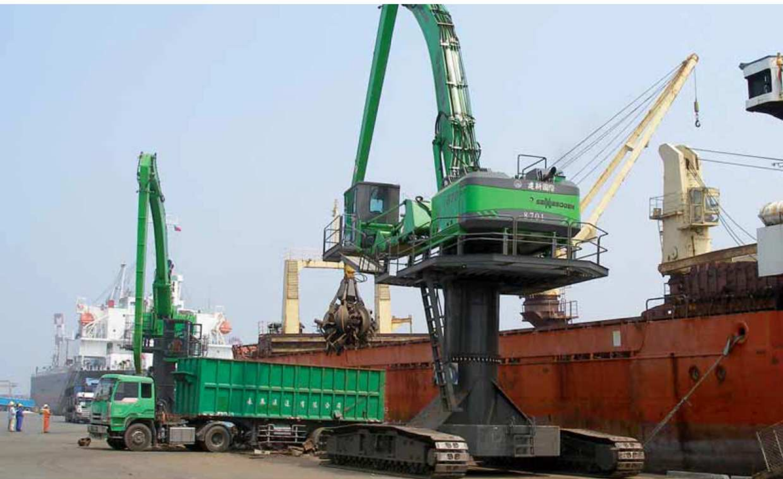
870 R spezial – 5 m Pylon – Ausrüstung B23 – 1.500 Liter Mehrschalengreifer – Taiwan 870 R special – 5 m pylon – equipment B23 – 1,500 litre orange-peel grab – Taiwan
