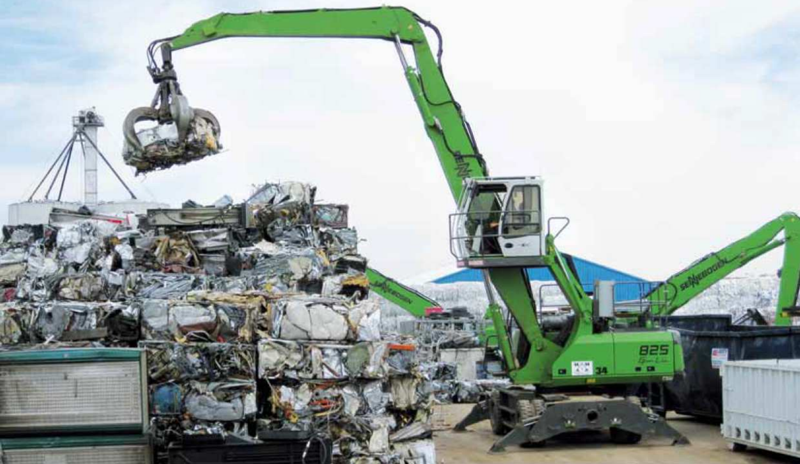
825 M – Ausrüstung K13 – 600 Liter Mehrschalengreifer – USA 825 M – equipment K13 – 600 litre orange-peel grab – USA
