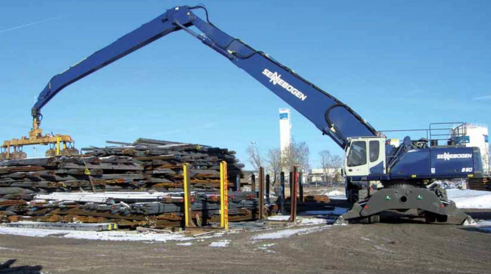
860 M – Ausrüstung K21 – Magnettraverse – Deutschland 860 M – equipment K21 – magnet device – Germany
