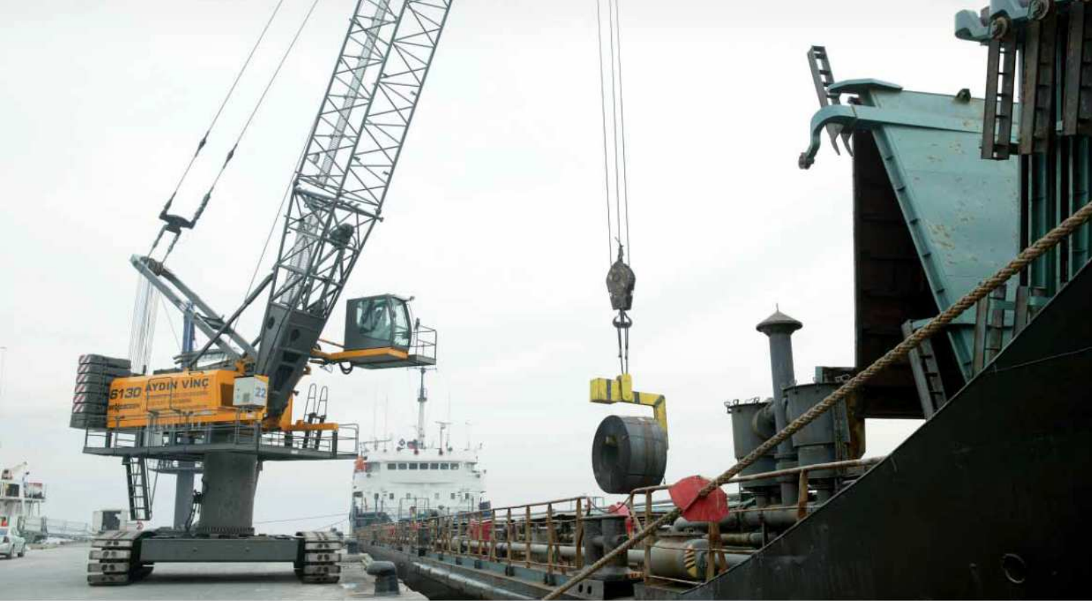
6130 HCC - 3 m Pylon - 30 m Auslegerlänge - Stahlcoil im Hakenbetrieb - Türkei 6130 HCC - 3 m pylon - 30 m boom length - steel coil in hook operation - Turkey
