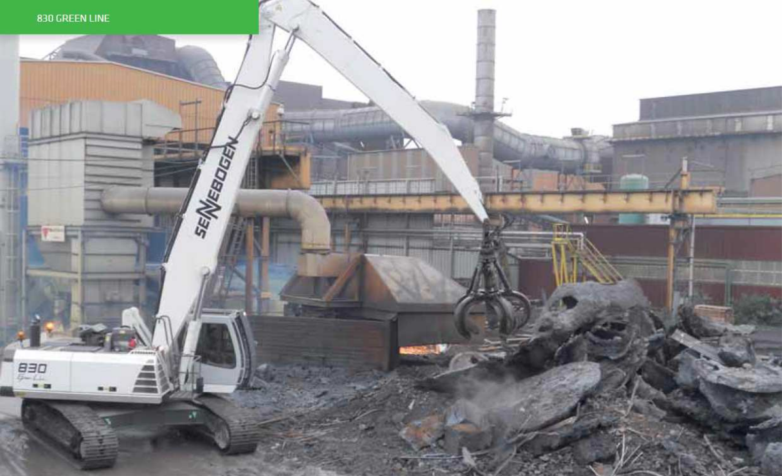
830 R – Ausrüstung K15 – 600 Liter Mehrschalengreifer – Frankreich 830 R – equipment K15 – 600 litre orange-peel grab – France
