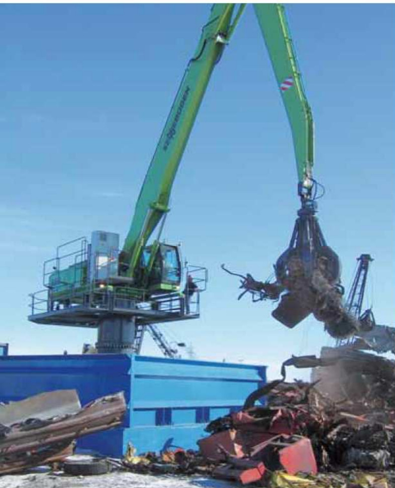
850 A spezial – 5 m Pylon – Ausrüstung K21 – 1.200 l Mehrschalengreifer – Kanada 850 A special – 5 m pylon – equipment K21 – 1,200 l orange-peel grab – Canada
