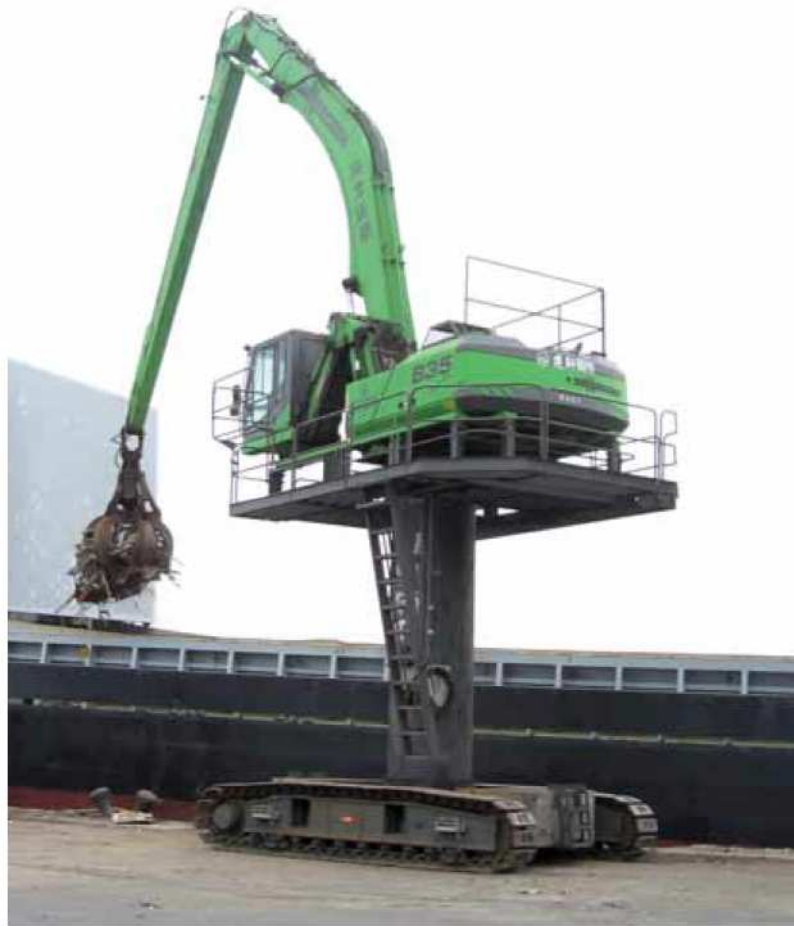
835 R spezial - 5 m Pylon - Ausrüstung B19 - 1.200 Liter Mehrschalengreifer - Taiwan 835 R special - 5 m pylon - equipment B19 - 1,200 litre orange-peel grab - Taiwan
