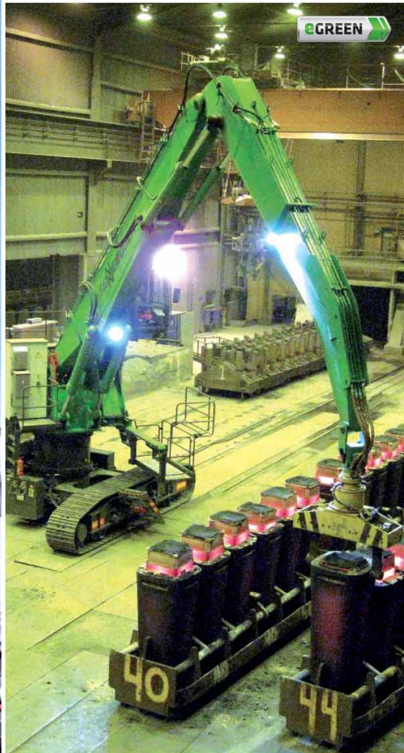
870 mit Raupenunterwagen und Schleppkabel als Energiezuführung 870 with crawler undercarriage and trailing cable as flexible energy supply
