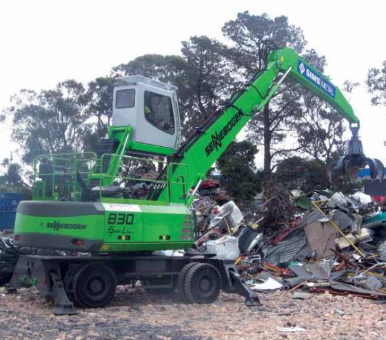
830 M – Ausrüstung K15 – 800 Liter Mehrschalengreifer – Australien 830 M – equipment K15 – 800 litre orange-peel grab – Australia
