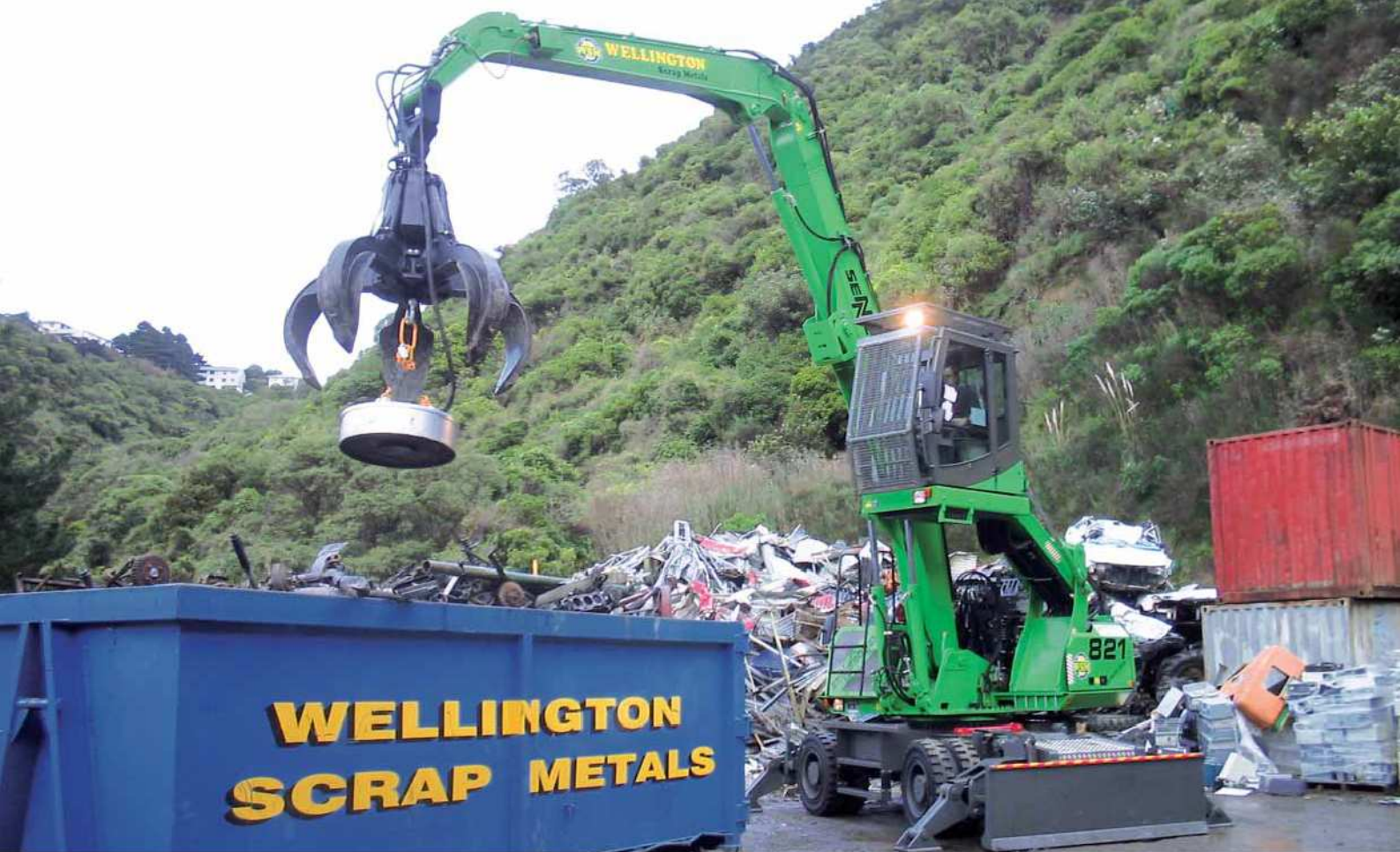
821 M – Ausrüstung K11 – 600 Liter Mehrschalengreifer mit Magnetplatte – Neuseeland 821 M – equipment K11 – 600 litre orange-peel grab with magnet plate – New Zealand
