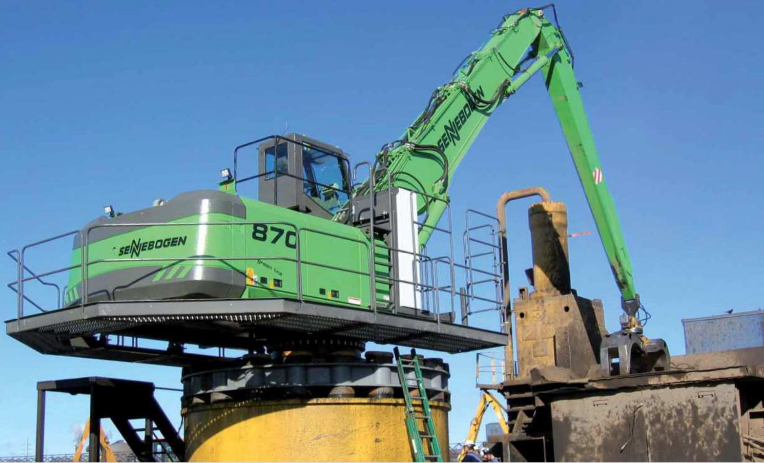
870 spezial mit Elastiklager - Ausrüstung K18 - Spezialgreifer - USA 870 special with elastic bearing - equipment K18 - special grab - USA
