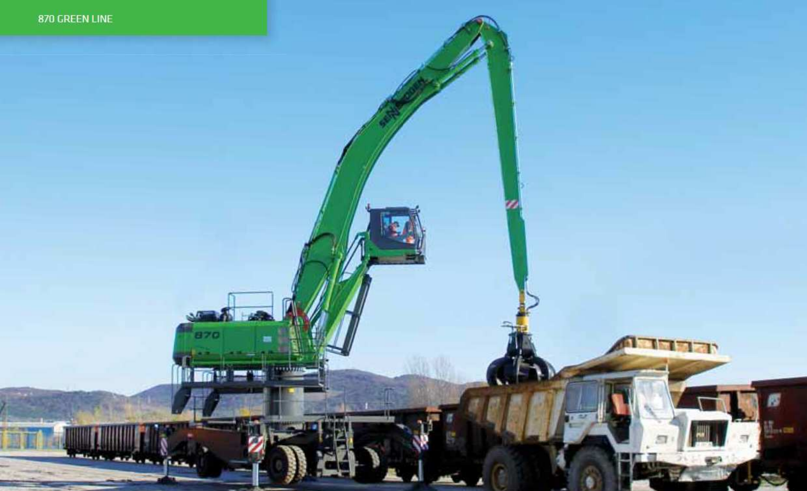
870 M spezial mit Unterwagen MS100 – 2 m Pylon – Ausrüstung B23 – 20 Tonnen Multitool – Italien 870 M special with undercarriage MS100 – 2 m pylon – equipment B23 – 20 tons Multitool – Italy
