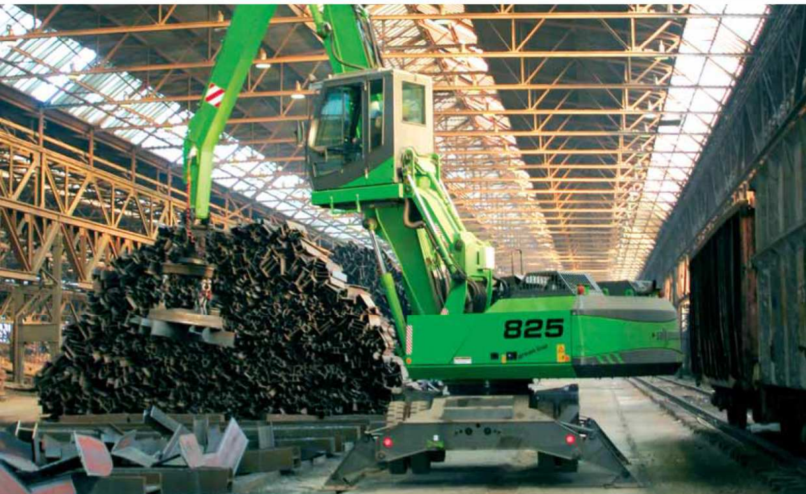
825 M - Ausrüstung K13 - Magnetplatte - Deutschland 825 M - equipment K13 - magnet plate - Germany
