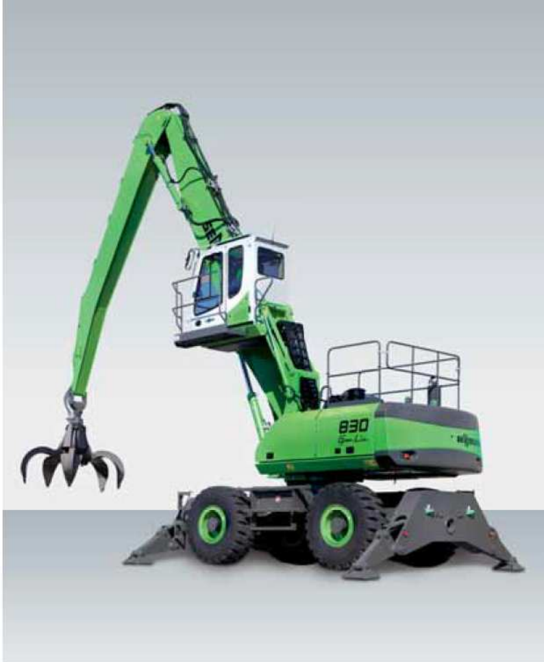
830 M-HDS: Heavy Duty Ausführung mit großer Einfach-Bereifung 4 x 16.00-25 830 M-HDS: Heavy Duty design with large single tires 4 x 16,00-25
