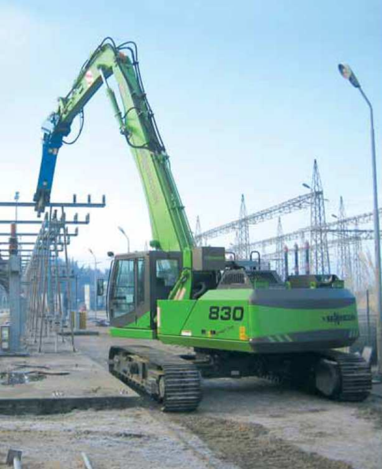
830 R – Sonderausrüstung K12 ULM – Schrottschere – Italien 830 R – special equipment K12 ULM – scrap shear – Italy
