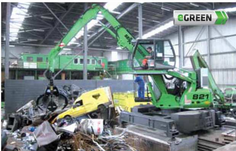
821 mit stationär montiertem Untergestell mit fester Elektro-Installation als Energiezuführung 821 with stationary 4-point underframe with fixed electro installation
