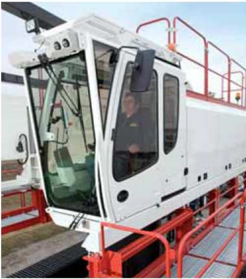
Kabine maXcab Industrie: mit durchgehender Panzerglas-Frontscheibe für Industrie- und Hafeneinsätze Cabin maXcab industry: with continuous bullet-proof front window for industrial and port applications
