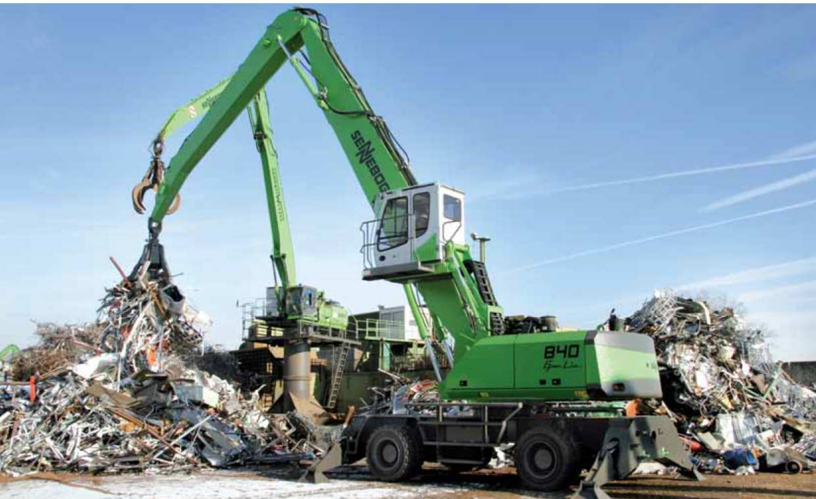
840 M – Ausrüstung K18 – 800 Liter Mehrschalengreifer – Deutschland 840 M – equipment K18 – 800 litre orange-peel grab – Germany
