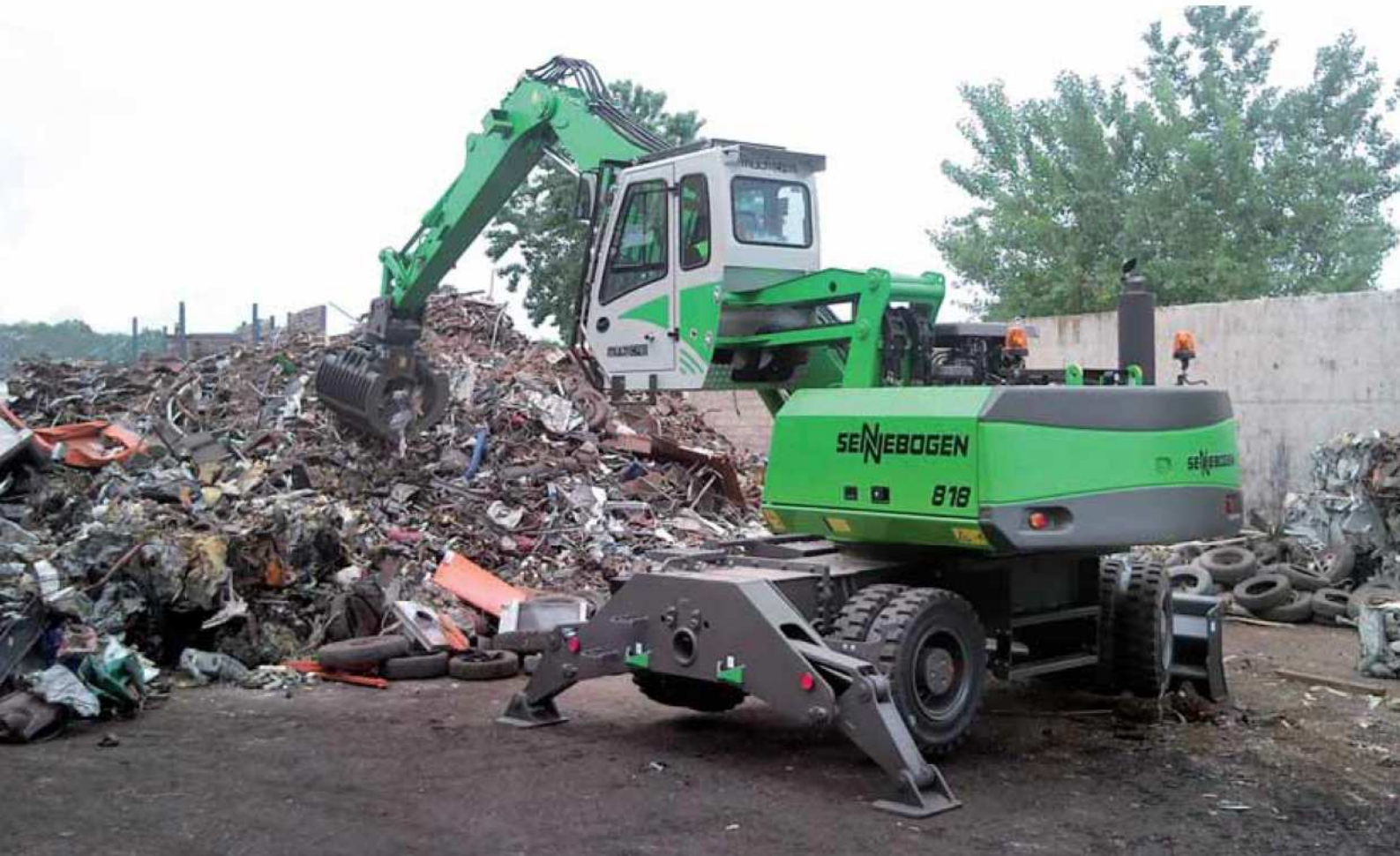
818 M – Ausrüstung K9 ULM – 400 Liter Sortiergreifer – Spanien 818 M – equipment K9 ULM – 400 litre sorting grab – Spain
