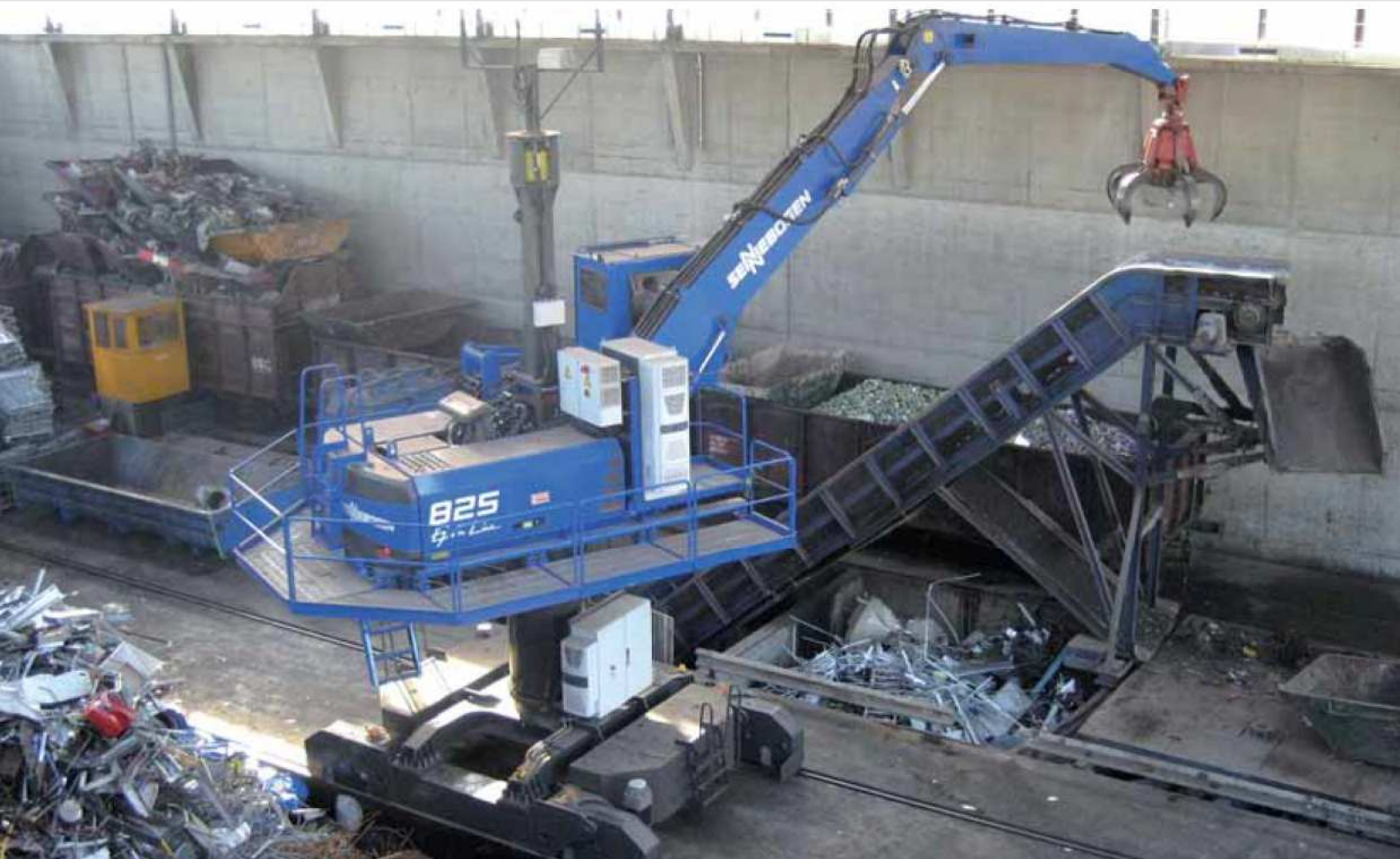
825 A spezial - Elektro auf Schienenunterwagen - 2,5 m Pylon - Ausrüstung K12 - 600 Liter Mehrschalengreifer - Schweiz 825 A special - electro on rail undercarriage - 2.5 m pylon - equipment K12 - 600 litre orange-peel grab - Switzerland
