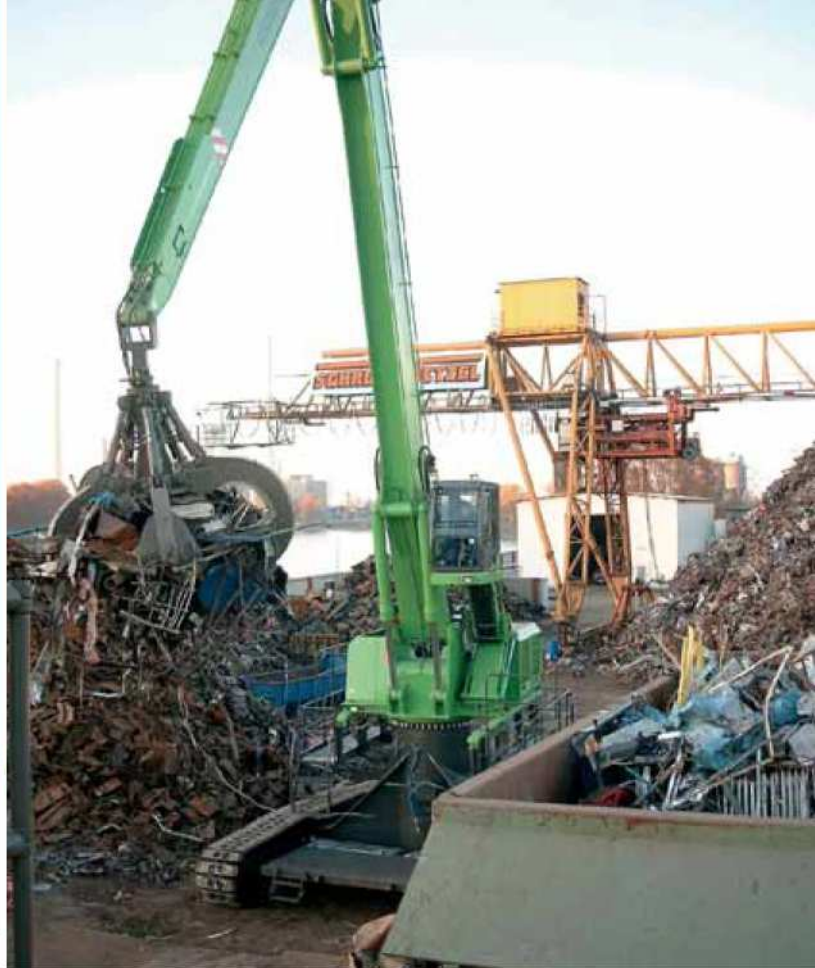
870 R special - 2 m Pylon - Sonderausrüstung K26 - 2.500 l Mehrschalengreifer - Deutschland 870 R special - 2 m pylon - special equipment K26 - 2,500 l orange-peel grab - Germany
