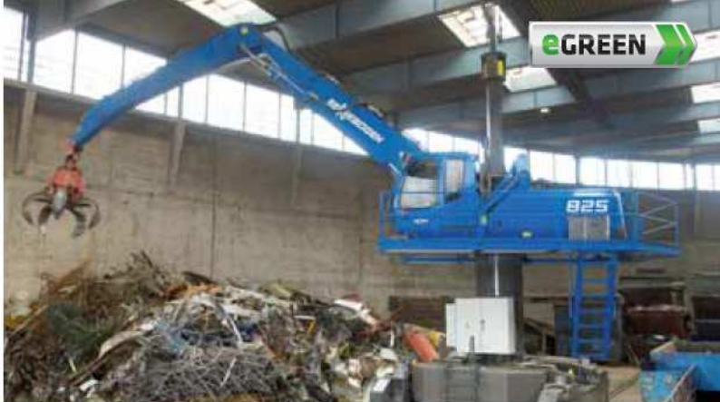
825 mit Schienenunterwagen und Pylon, Energiezuführung über Schleifleitungen und Schleifringkörper von der Hallendecke 825 with rail mounted undercarriage and slip ring body from ceiling above
