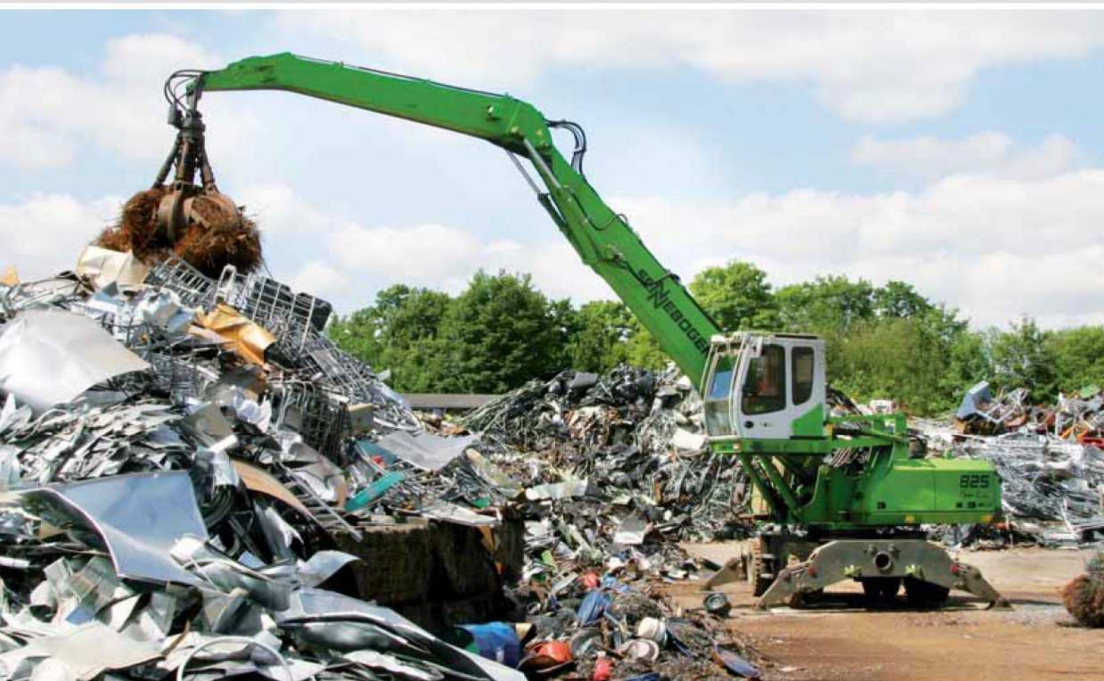
825 M – Ausrüstung K12 – 600 Liter Mehrschalengreifer – Deutschland 825 M – equipment K12 – 600 litre orange-peel grab – Germany
