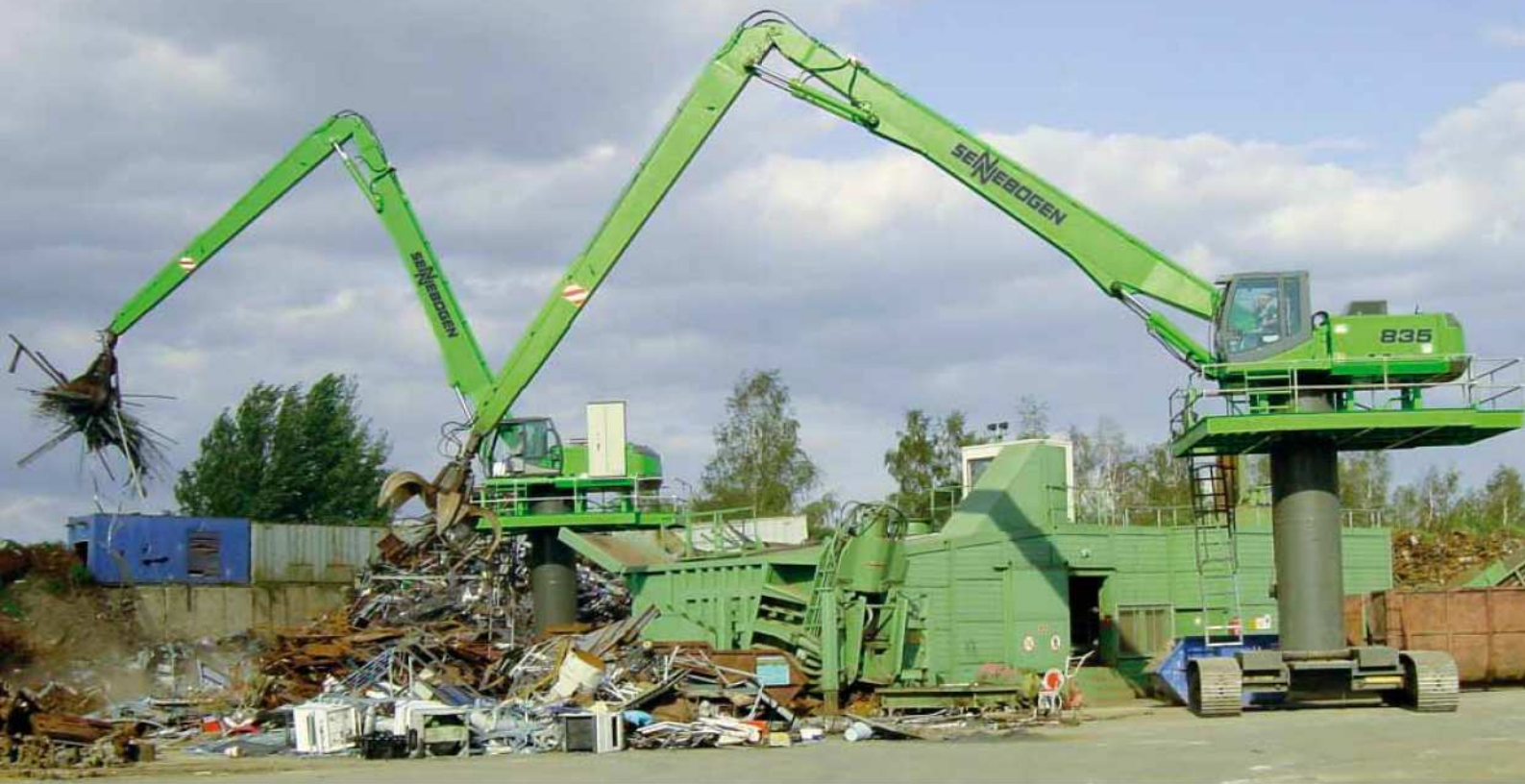
835 R spezial – 5 m Pylon – Ausrüstung K21 – 600 Liter Mehrschalengreifer – Deutschland 835 R special – 5 m pylon – equipment K21 – 600 litre orange-peel grab – Germany
