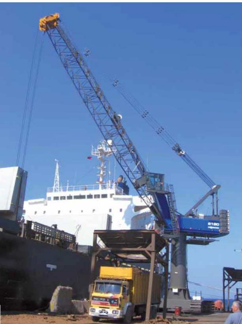
6180 HCC - 7 m Pylon - 33 m Auslegerlänge - 60 Tonnen Drehhaken mit 10.000 Liter Mehrschalengreifer - Türkei 6180 HCC - 7 m pylon - 33 m boom length - 60 tons motor swivel hook with 10,000 litre orange-peel grab - Turkey
