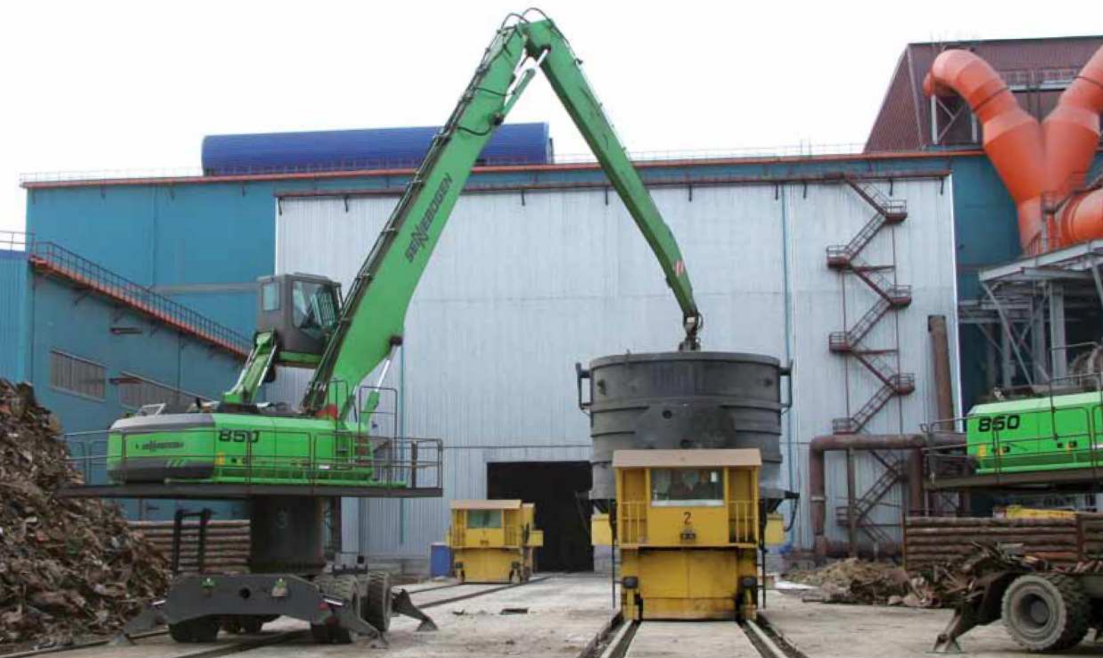
850 M spezial – 1,5 m Pylon – Ausrüstung K21 – 2.000 Liter Mehrschalengreifer – Russland 850 M special – 1.5 m pylon – equipment K21 – 2,000 litre orange-peel grab – Russia
