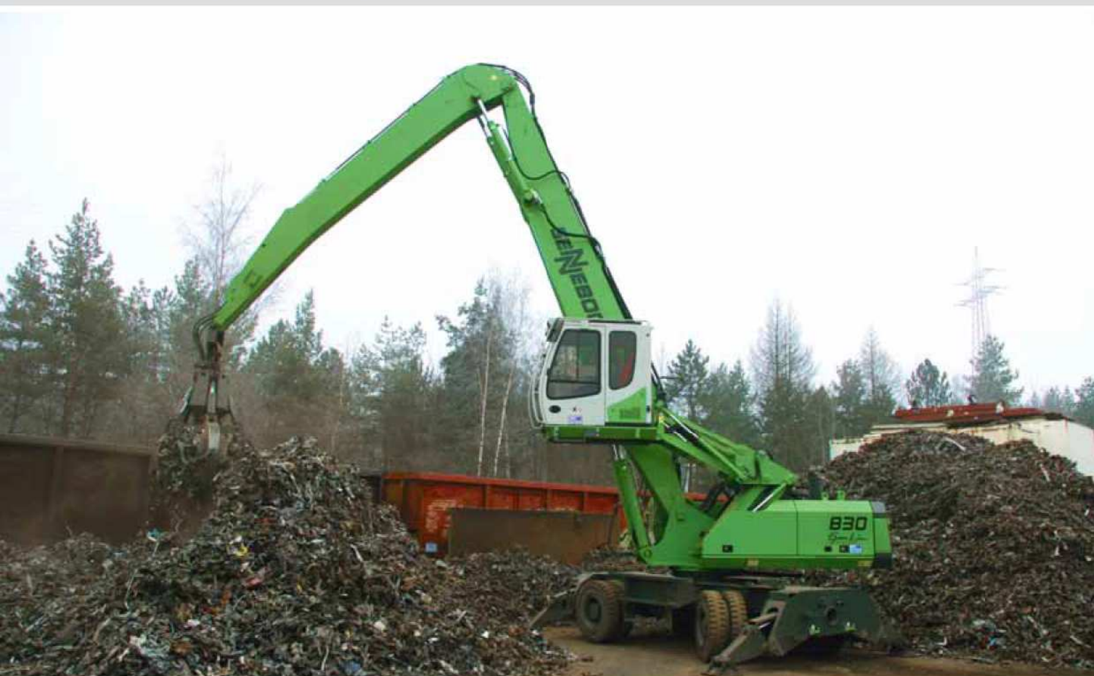
830 M – Ausrüstung K15 – 800 Liter Mehrschalengreifer – Deutschland 830 M – equipment K15 – 800 litre orange-peel grab – Germany
