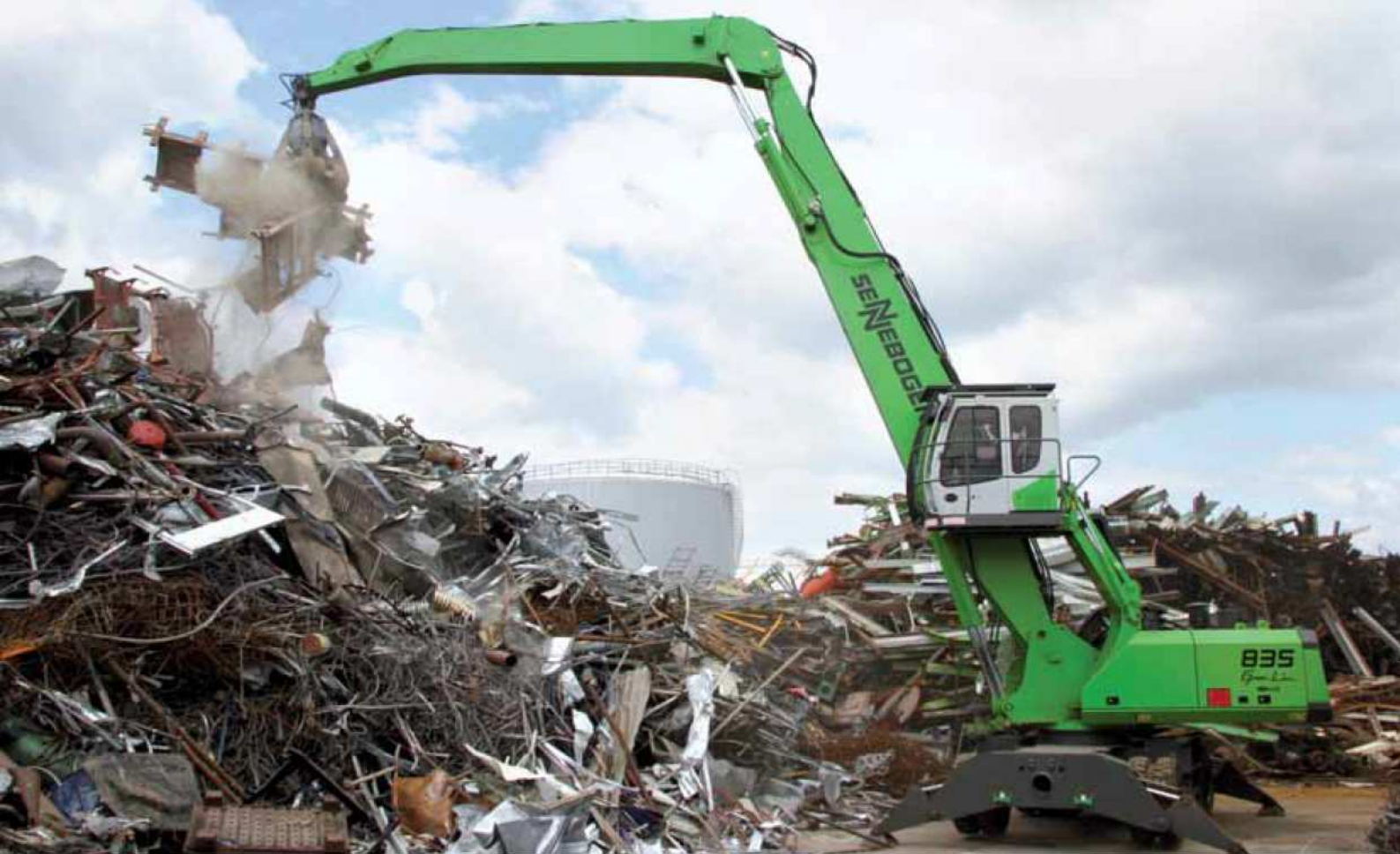
835 M – Ausrüstung K18 – 400 Liter Mehrschalengreifer – Deutschland 835 M – equipment K18 – 400 litre orange-peel grab – Germany
