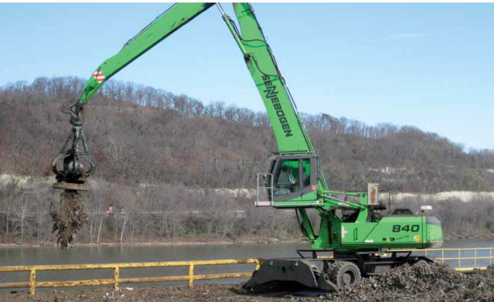
840 M – Ausrüstung K17 – 1.200 Liter Mehrschalengreifer inkl. Magnet mit Greiferaufnahmedorn – USA 840 M – equipment K17 – 1,200 litre orange-peel grab incl. magnet with grab attachment device – USA
