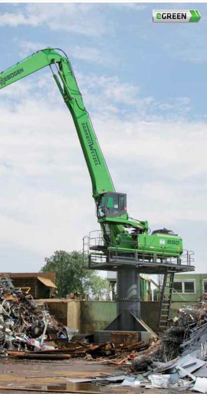
850 mit stationärem Untergestell und fester Elektro-Installation als Energiezuführung 850 with stationary 4-point underframe with fixed electro installation
