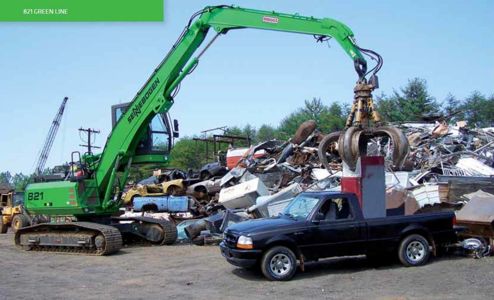
821 R – Ausrüstung K11 – 400 Liter Mehrschalengreifer – USA 821 R – equipment K11 – 400 litre orange-peel grab – USA
