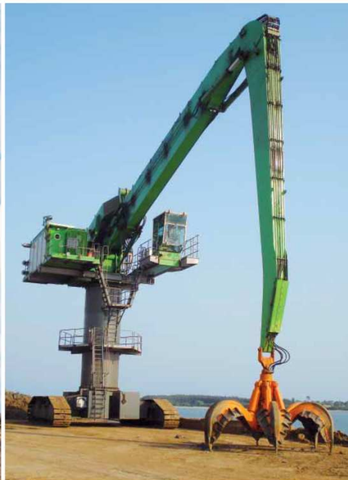
880 EQ R spezial – 7 m Pylon – Ausrüstung K33 – 7.000 Liter Mehrschalengreifer – Indien 880 EQ R special – 7 m pylon – equipment K33 – 7,000 litre orange-peel grab – India
