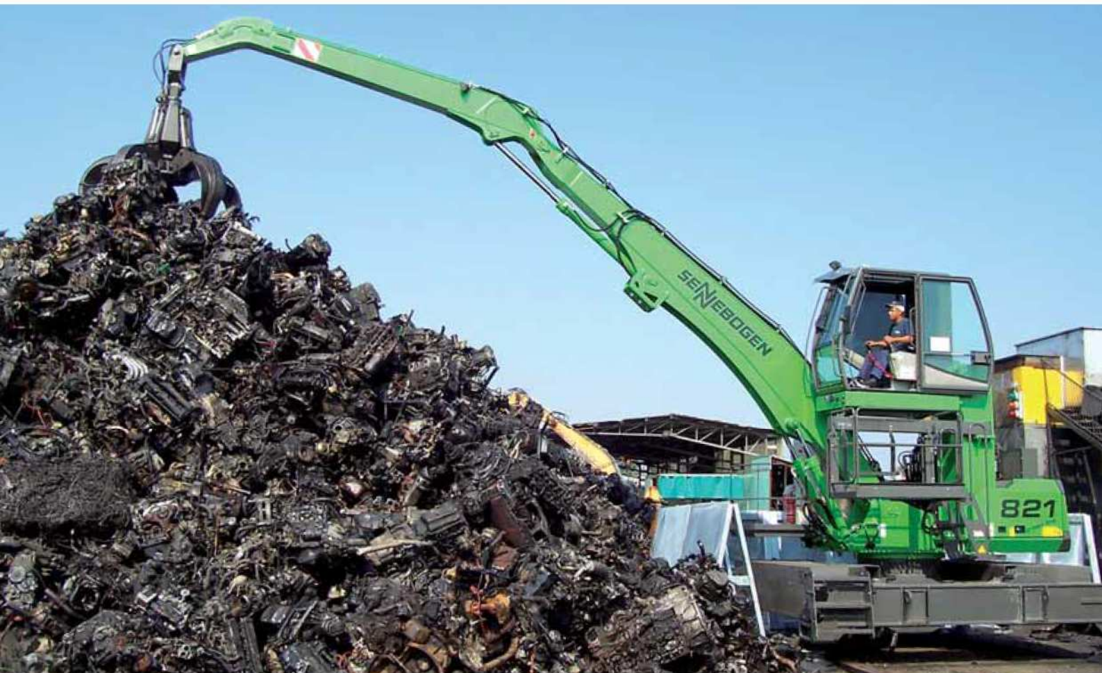
821 A spezial – stationär Elektro – Ausrüstung K12 – 600 Liter Mehrschalengreifer – Italien 821 A special – stationary electro – equipment K12 – 600 litre orange-peel grab – Italy
