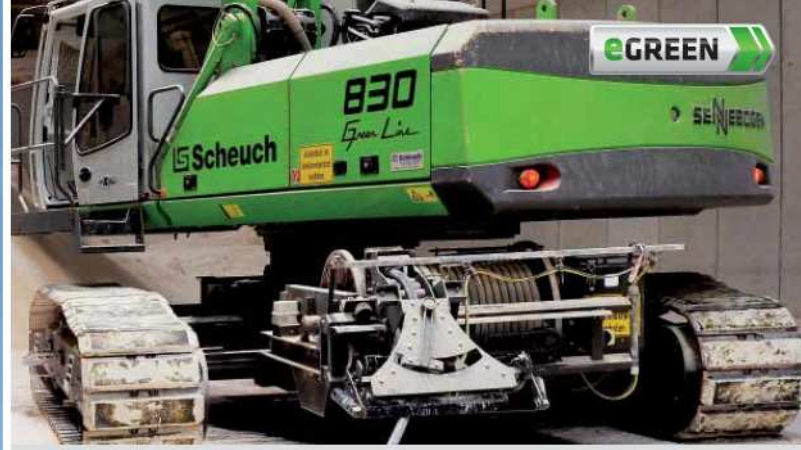
830 mit Raupenunterwagen – Energiezuführung über zylindrisch wickelnde Motorleistungstrommel mit Wickeleinrichtung und Leitungseinführrichter 830 with crawler undercarriage, energy supply via cylindrical motorized cable reel with spooling device
