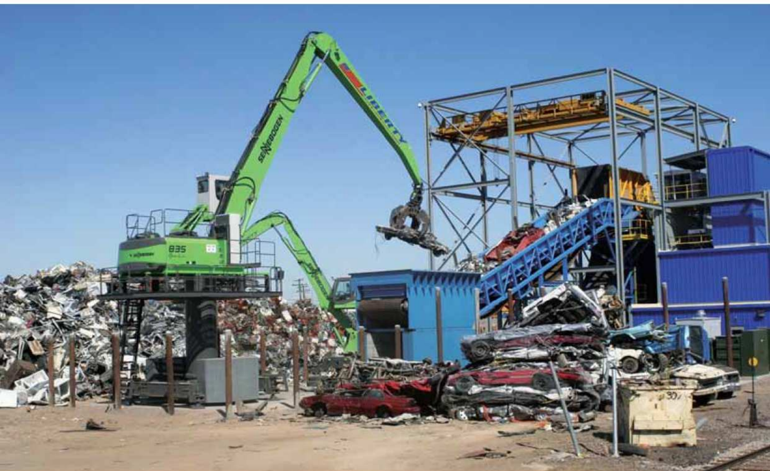
835 A spezial – 4 m Pylon – Sonderausrüstung K20 – 600 Liter Mehrschalengreifer – USA 835 A special – 4 m pylon – special equipment K20 – 600 litre orange-peel grab – USA
