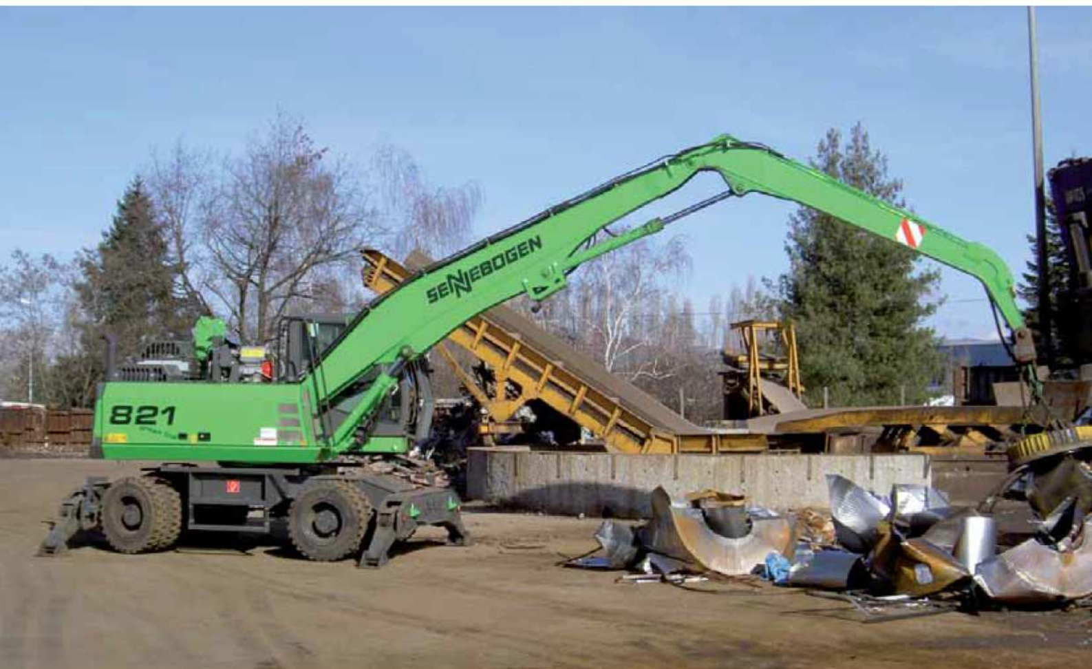
821 M – Ausrüstung K11 – Magnetplatte – Frankreich 821 M – equipment K11 – magnet plate – France
