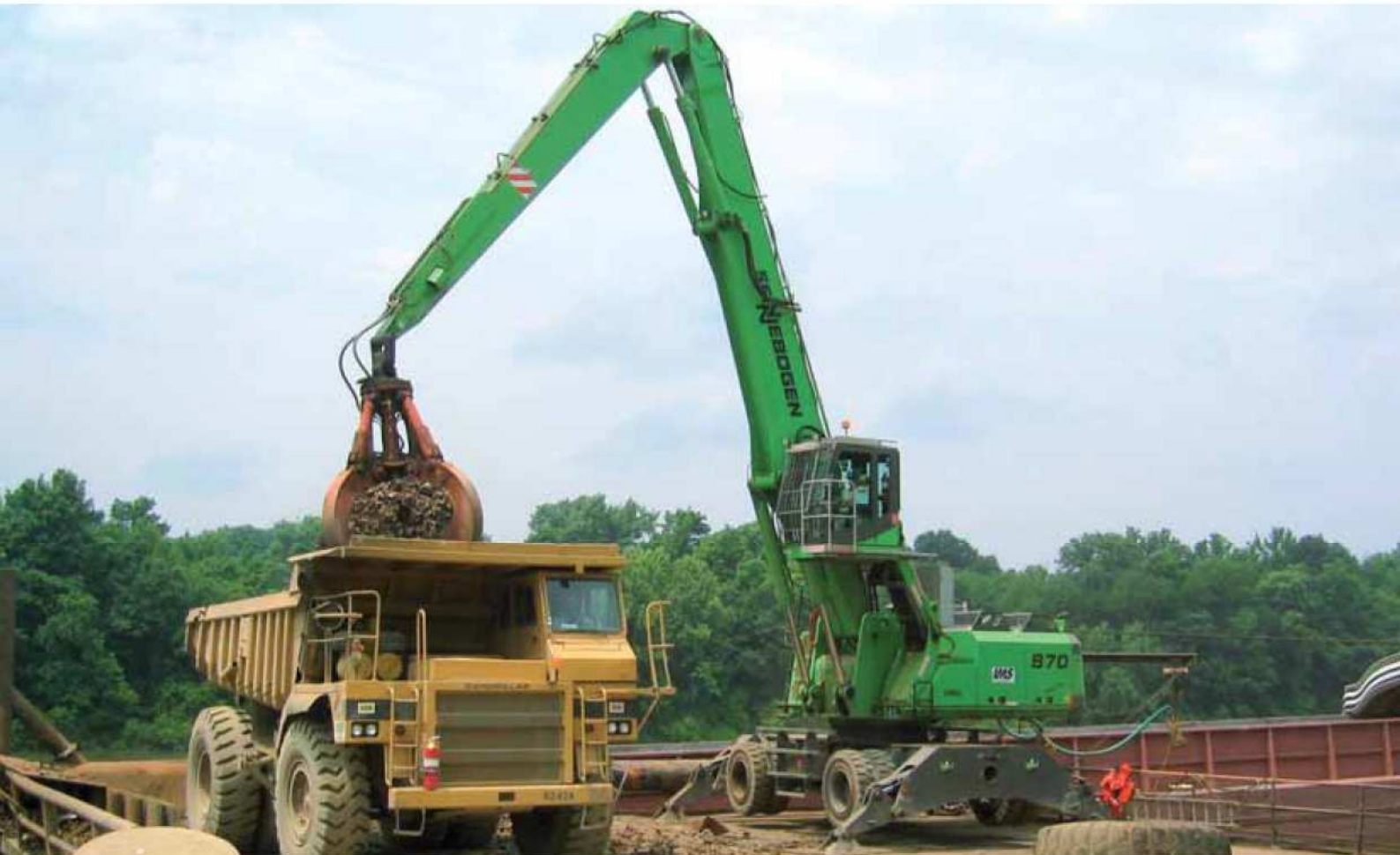
870 M - Ausrüstung K18 - 3.000 Liter Mehrschalengreifer - USA 870 M - equipment K18 - 3,000 litre orange-peel grab - USA
