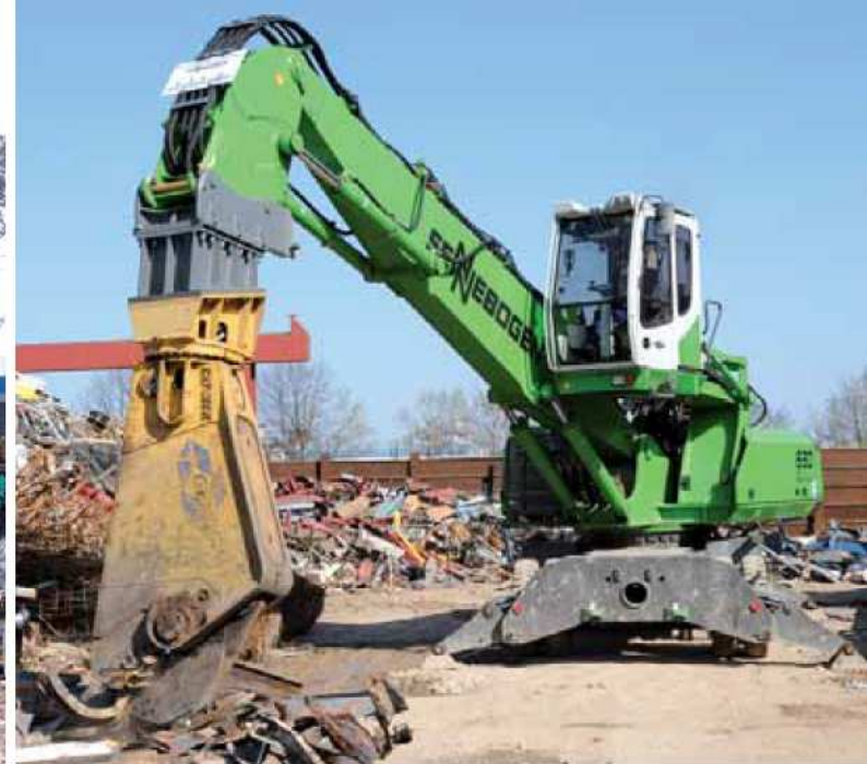
830 M – Vario Tool – Ausrüstung K13 – Schrottschere – Deutschland 830 M – vario tool – equipment K13 – scrap shear – Germany
