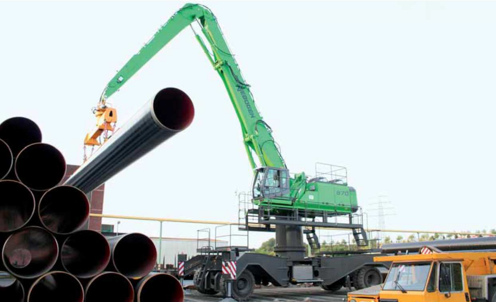
870 M spezial mit Unterwagen MS100 – 2 m Pylon – Ausrüstung K18 – Vakuumtraverse – Deutschland 870 M special with undercarriage MS100 – 2 m pylon – equipment K18 – vacuum lifting device – Germany
