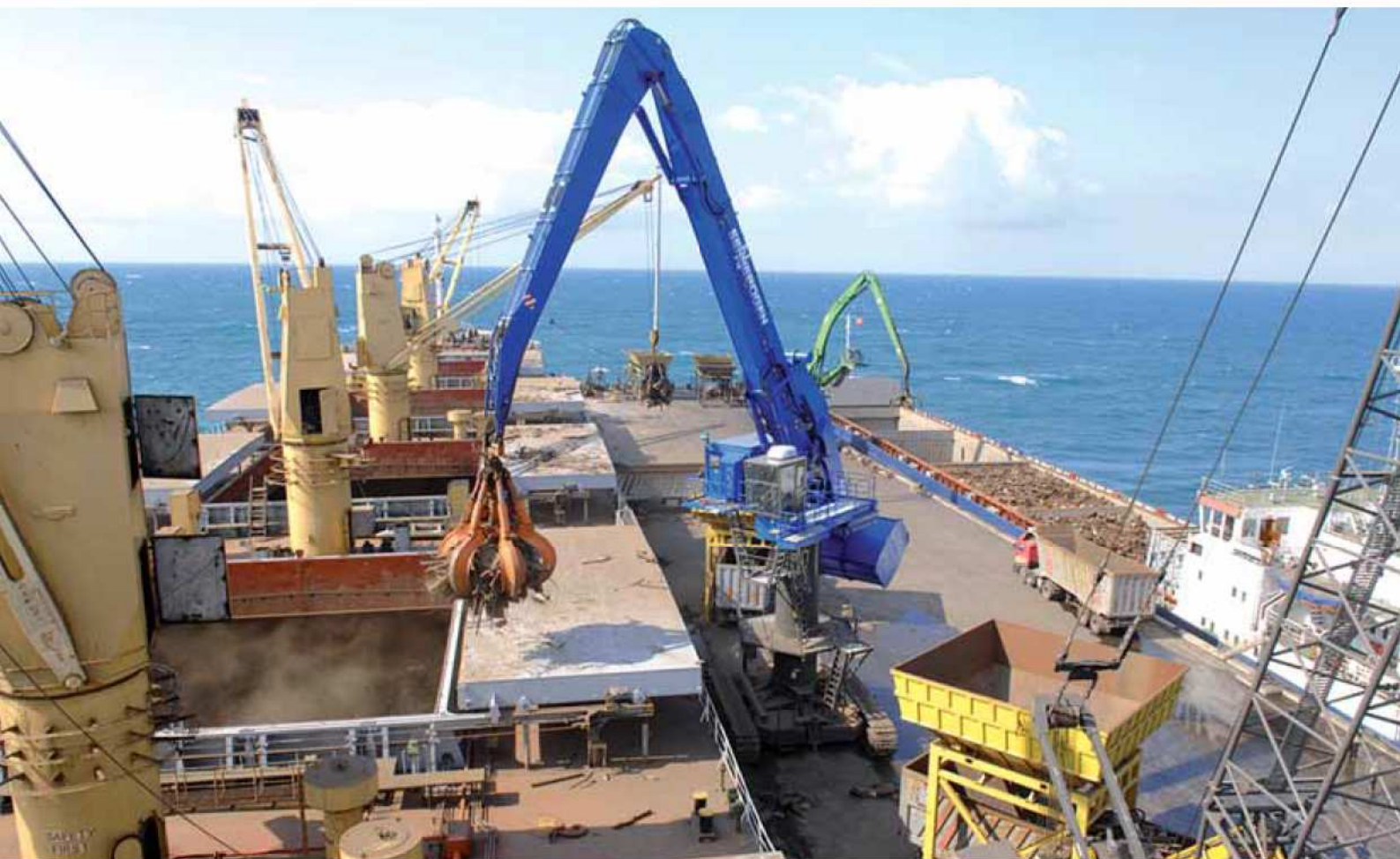
880 EQ R spezial - 7 m Pylon - Ausrüstung K30 - 8.000 Liter Mehrschalengreifer - Türkei 880 EQ R special - 7 m pylon - equipment K30 - 8,000 litre orange-peel grab - Turkey
