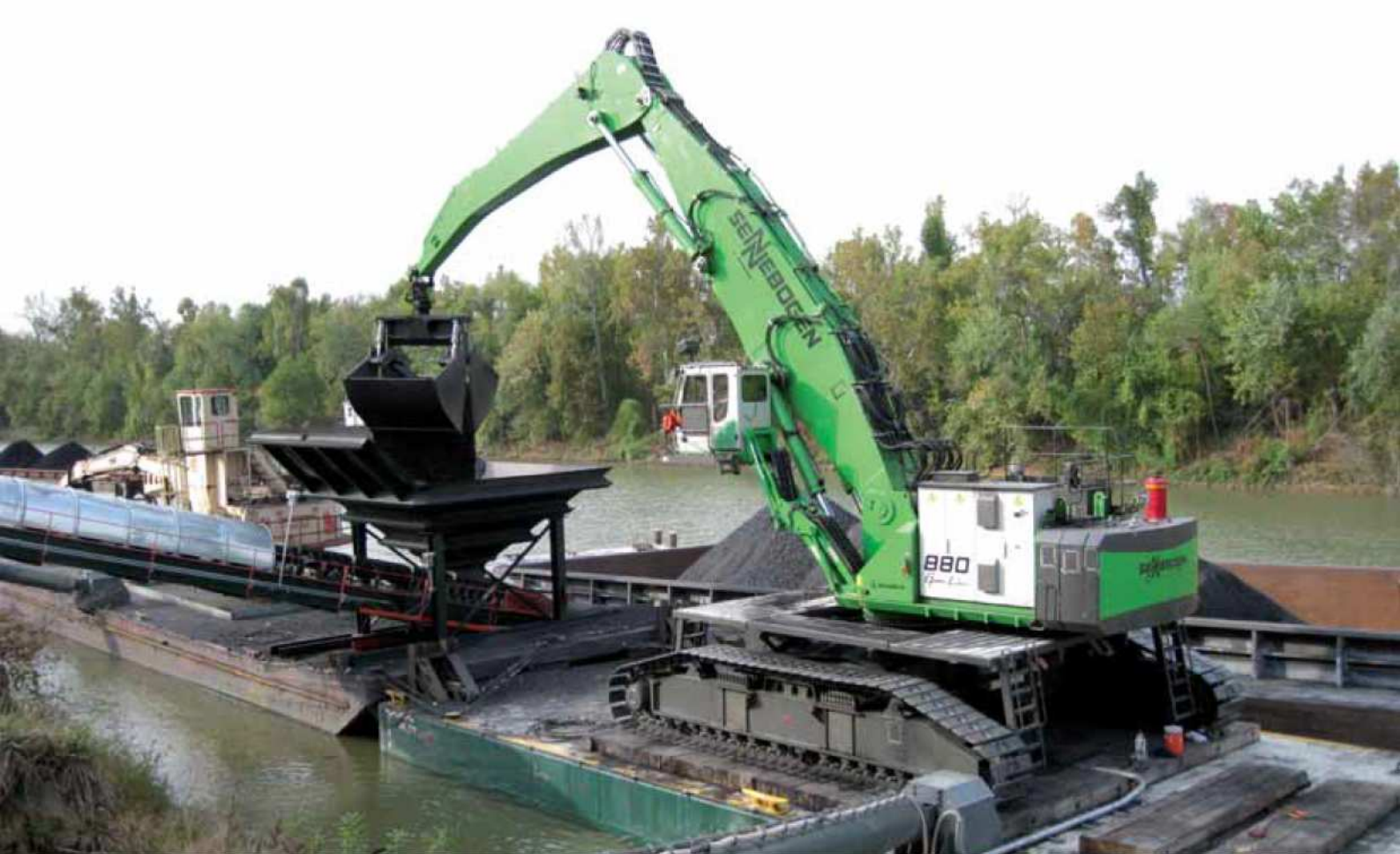
880 R-HD – Elektro – Ausrüstung K20 – 10.500 Liter Zweischalengreifer – USA 880 R-HD – electro – equipment K20 – 10,500 litre clamshell grab – USA
