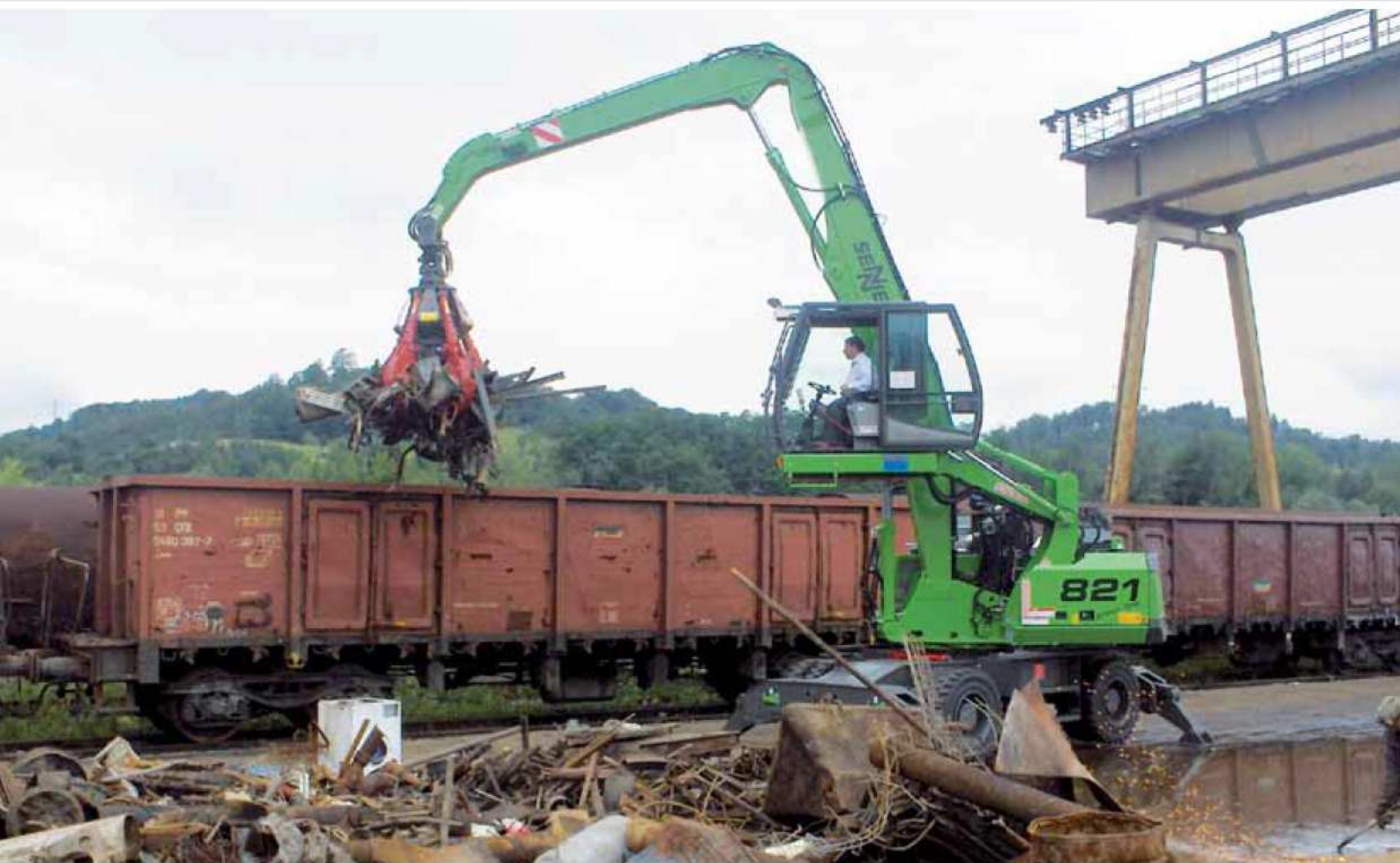
821 M – Ausrüstung K12 – 600 Liter Mehrschalengreifer – Rumänien 821 M – equipment K12 – 600 litre orange-peel grab – Romania
