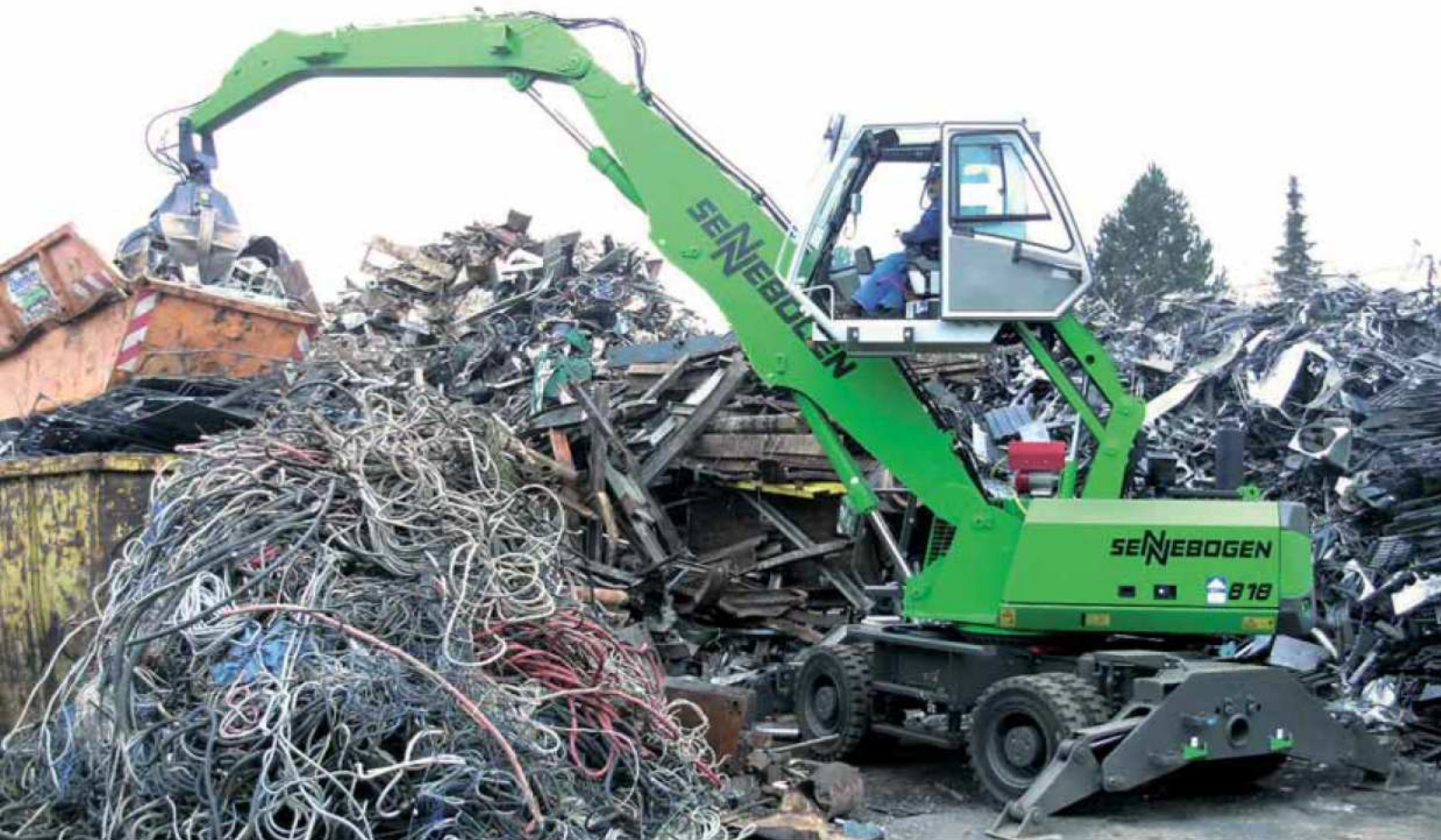
818 M – Ausrüstung K9 – 450 Liter Mehrschalengreifer – Deutschland 818 M – equipment K9 – 450 litre orange-peel grab – Germany
