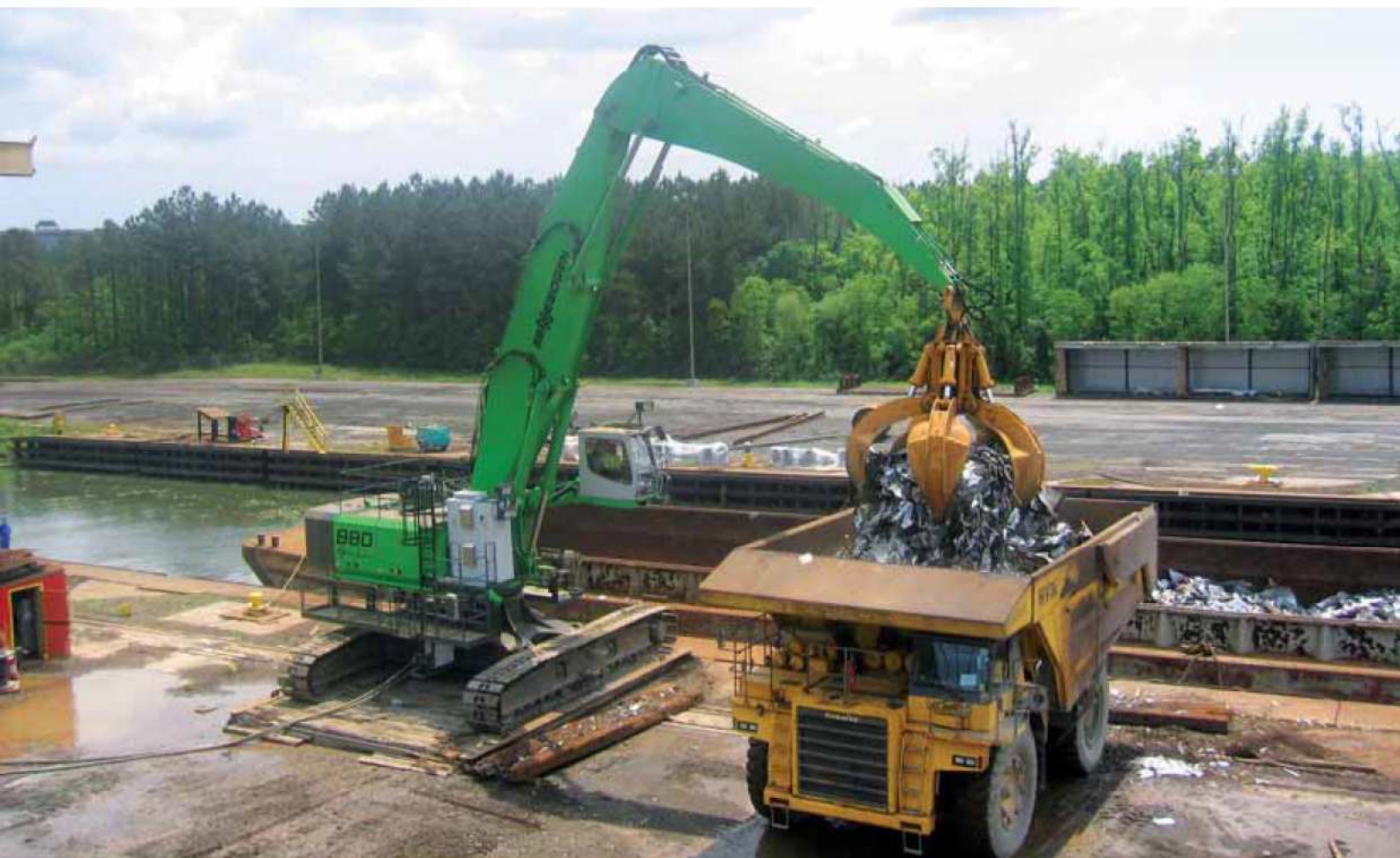
880 R – Elektro – Ausrüstung K20 – 8.000 Liter Mehrschalengreifer – USA 880 R – electro – equipment K20 – 8,000 litre orange-peel grab – USA
