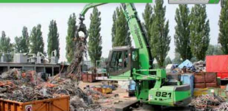
821 mit stationär montiertem Untergestell mit fester Elektro-Installation als Energiezuführung 821 with stationary 4-point underframe with fixed electro installation
