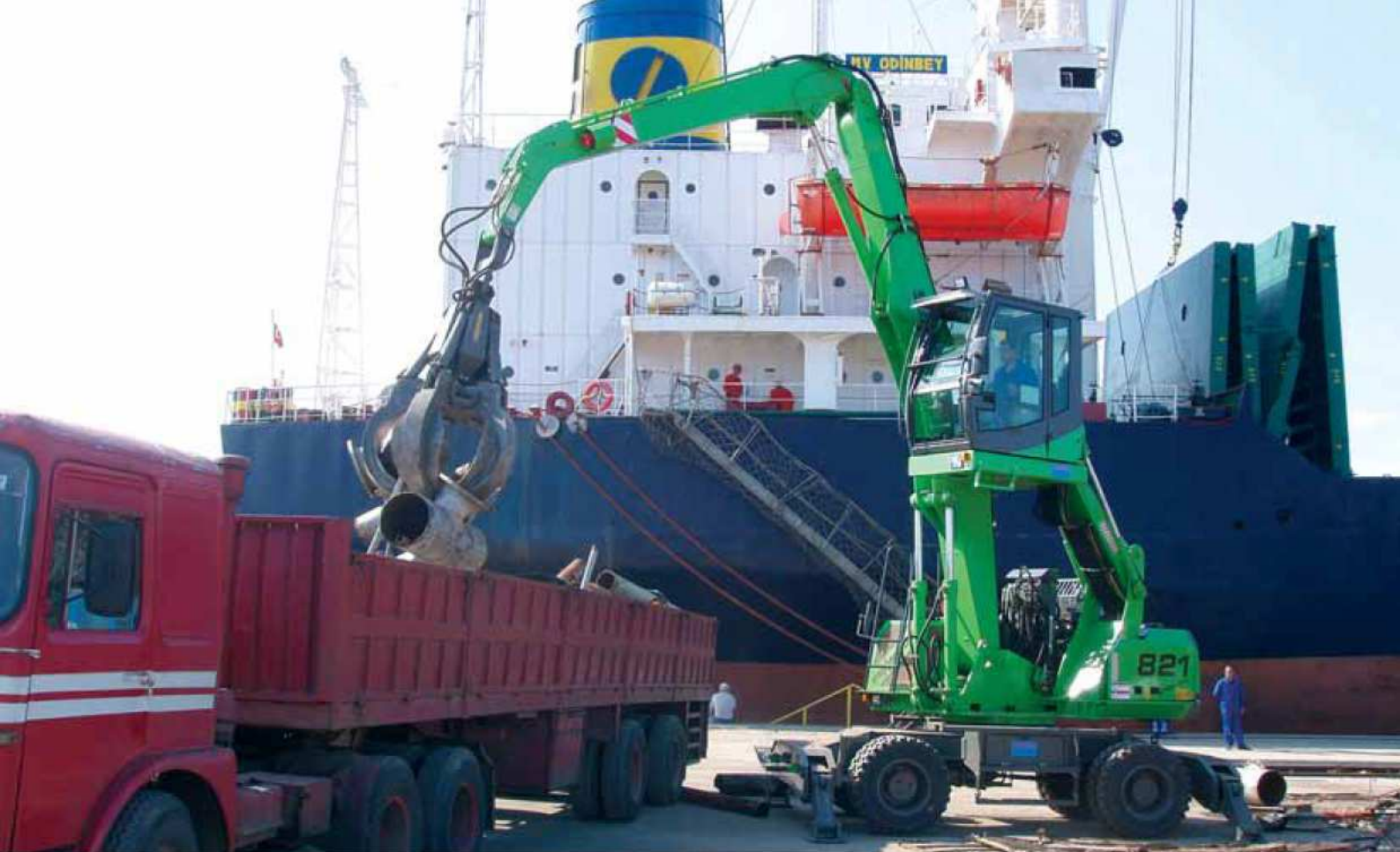
821 M – Ausrüstung K12 – 600 Liter Mehrschalengreifer – Bulgarien 821 M – equipment K12 – 600 litre orange-peel grab – Bulgaria
