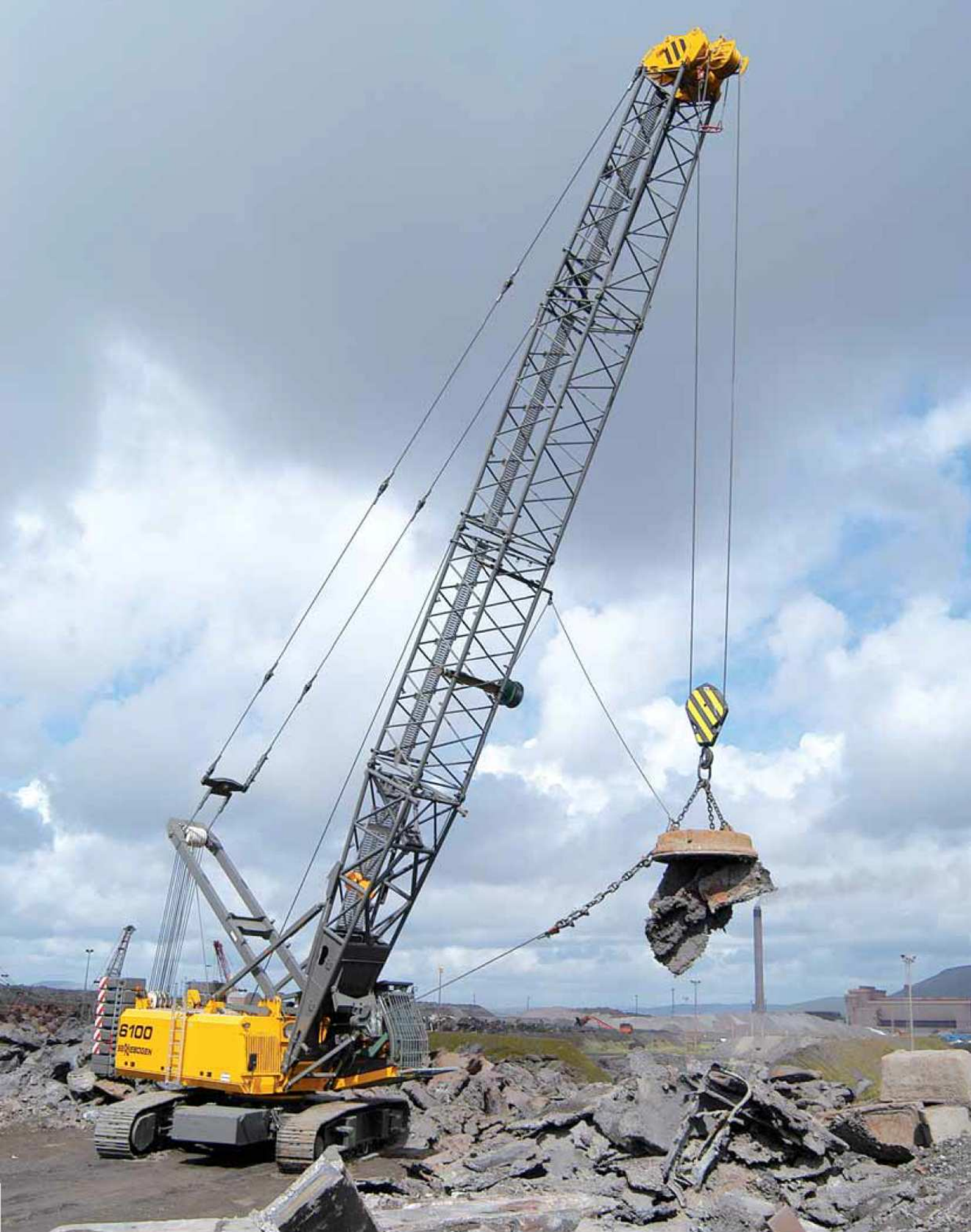
6100 HD - 24,3 m Auslegerlänge - Schlackeverladung mit Magnetplatte - Großbritannien 6100 HD - 24.3 m boom length - slag handling with magnet plate - Great Britain
