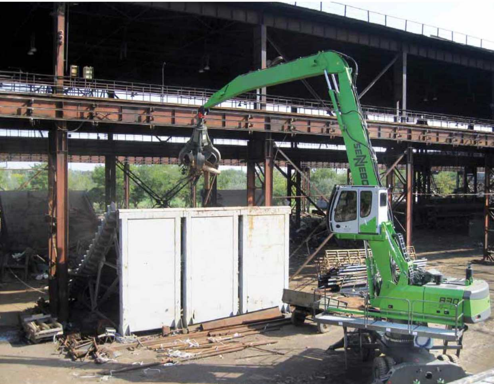
830 M spezial – 1 m Pylon – Ausrüstung K15 – 600 Liter Mehrschalengreifer – Ukraine 830 M special – 1 m pylon – equipment K15 – 600 litre orange-peel grab – Ukraine
