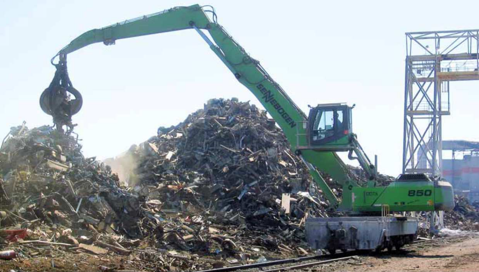
850 A spezial – Schienenunterwagen – Ausrüstung K17 – 1.200 Liter Mehrschalengreifer – USA 850 A special – rail undercarriage – equipment K17 – 1,200 litre orange-peel grab – USA
