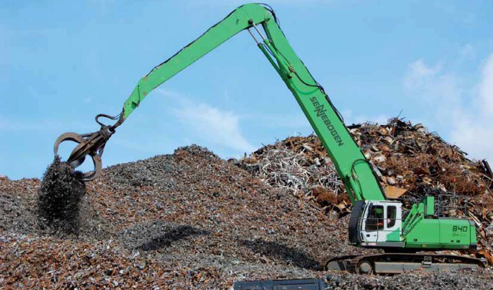
840 R – Ausrüstung K18 – 1.000 Liter Mehrschalengreifer – USA 840 R – equipment K18 – 1,000 litre orange-peel grab – USA
