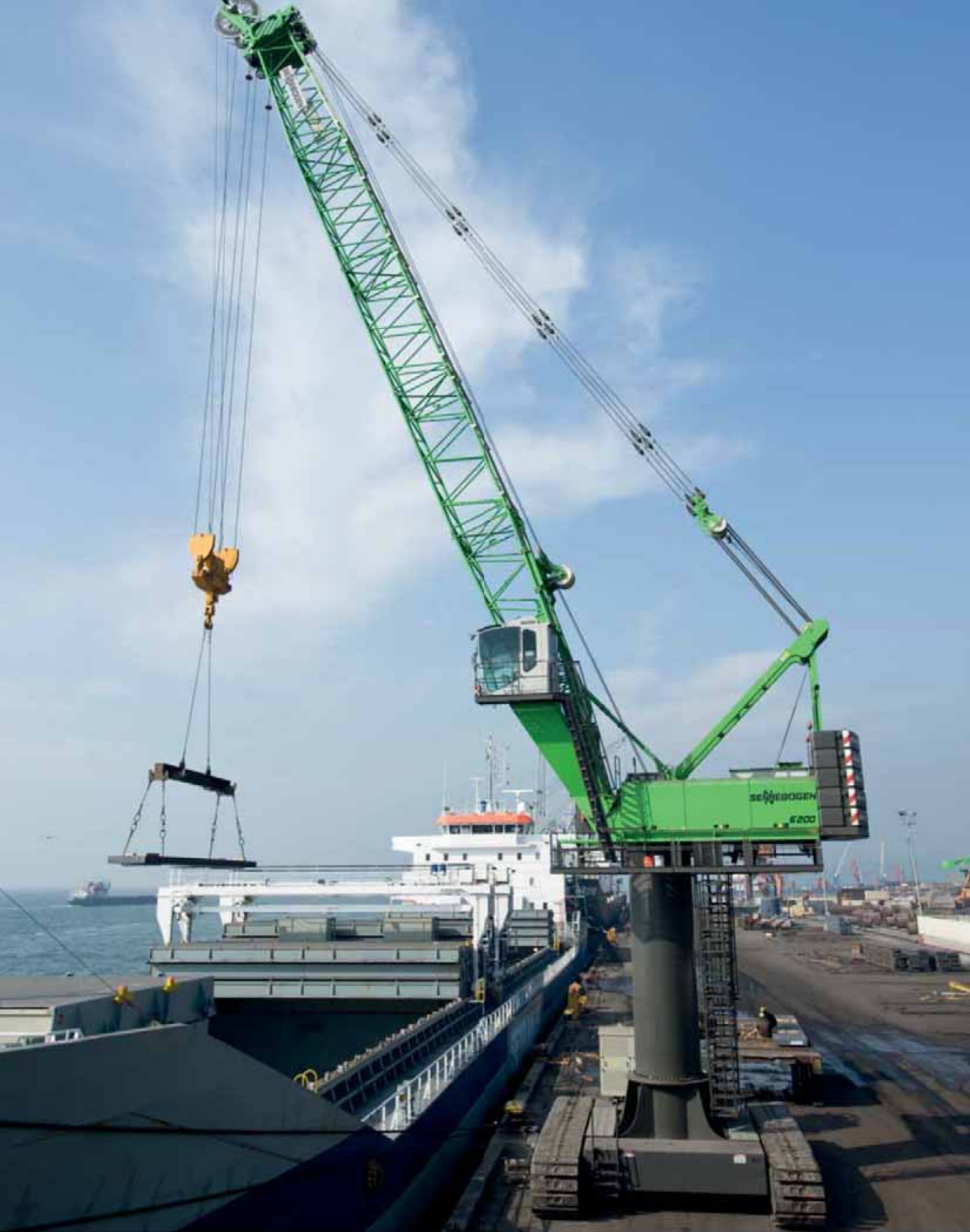
6200 HCC - cargo handling with lifting frame; Turkey 6200 HCC - Stückgutumschlag mit Hubtraverse; Türkei
