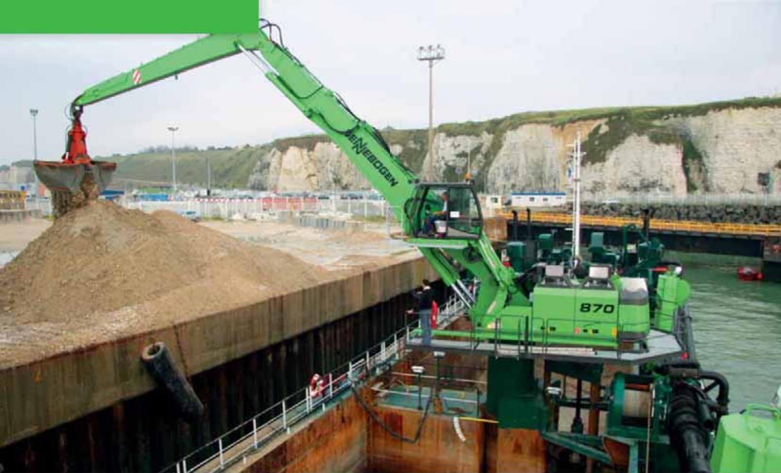
870 Schiffsaufbau - excavating and unloading, gravel and sand dredging; Netherlands 870 Schiffsaufbau - Ausbaggern und Entladen, Sand- und Kiesgewinnung; Niederlande
