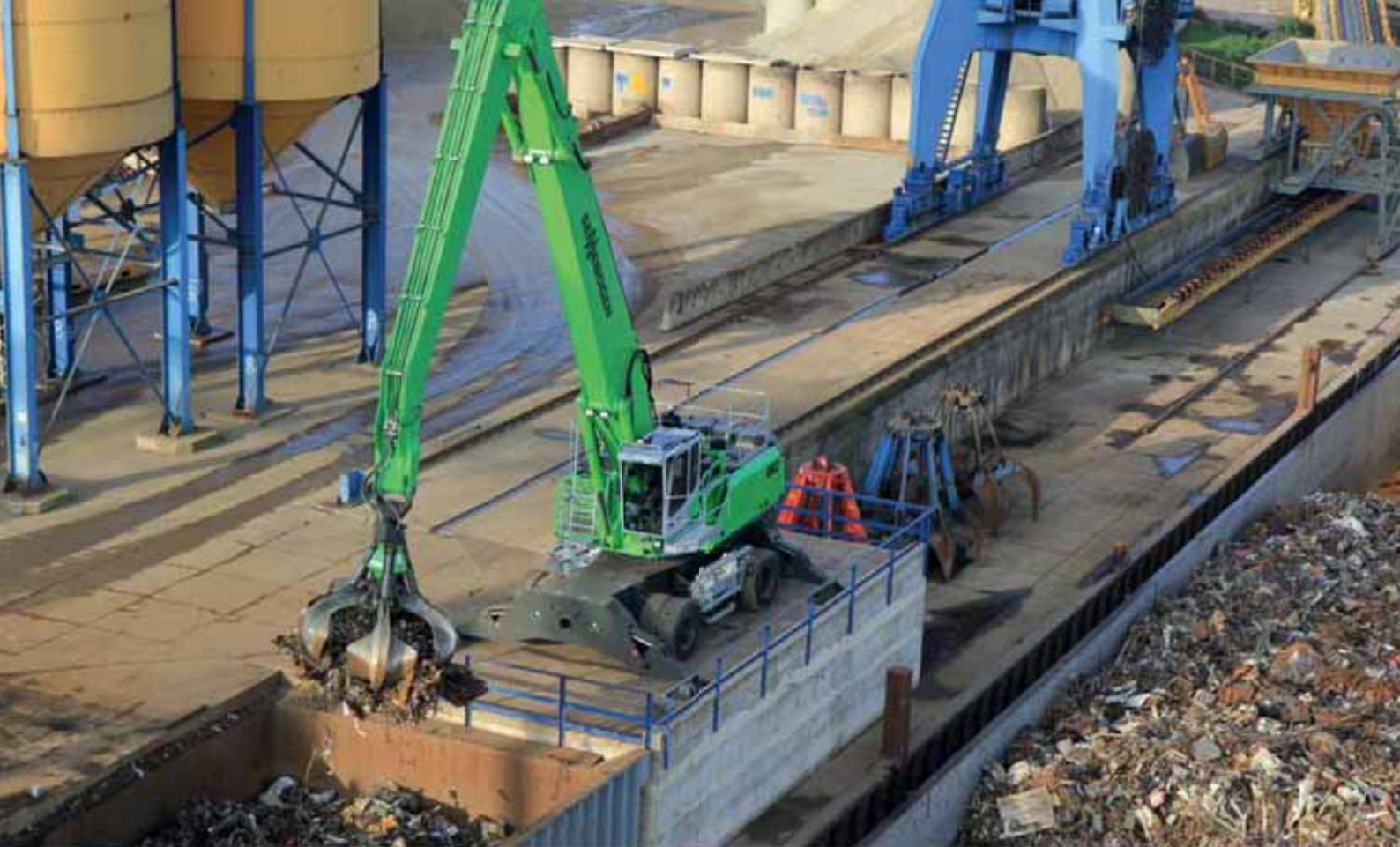
860 Mobile - Biooil, K20-equipment, scrap handling; Germany 860 Mobil - Bioöl, Ausrüstung K20, Schrottschlag; Deutschland
