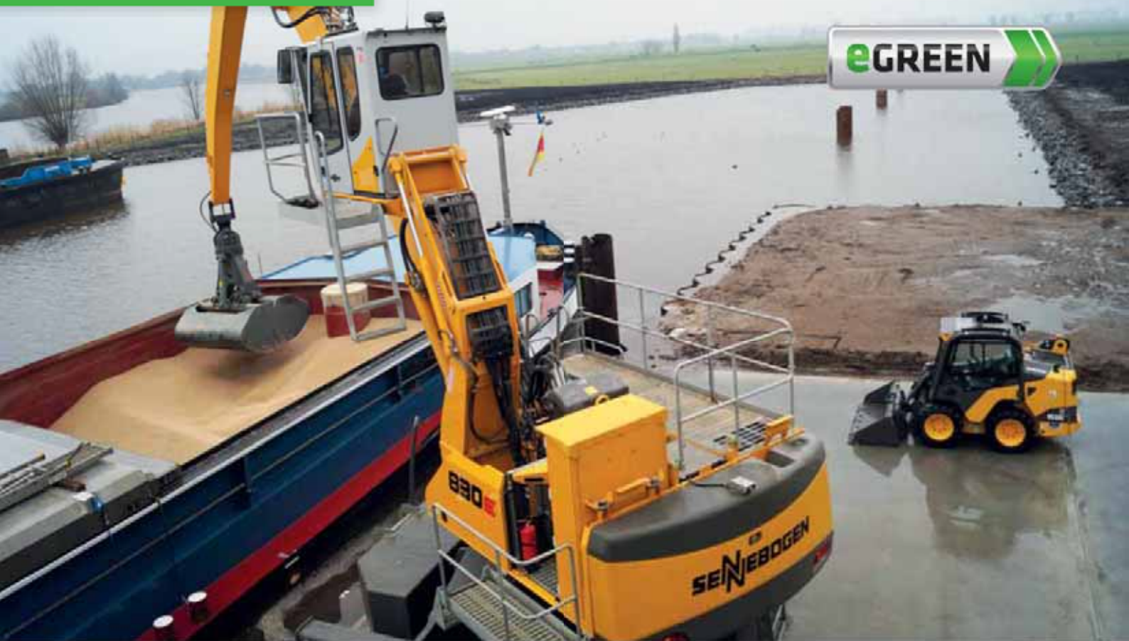
830 Electro on 4-point-pedestal - K17-equipment with clamshell grab, fodder handling; Netherlands 830 Elektro auf 4-Punkt-Untergestell - Ausrüstung K17 mit Zweischalengreifer, Futtermittelumschlag; Niederlande
