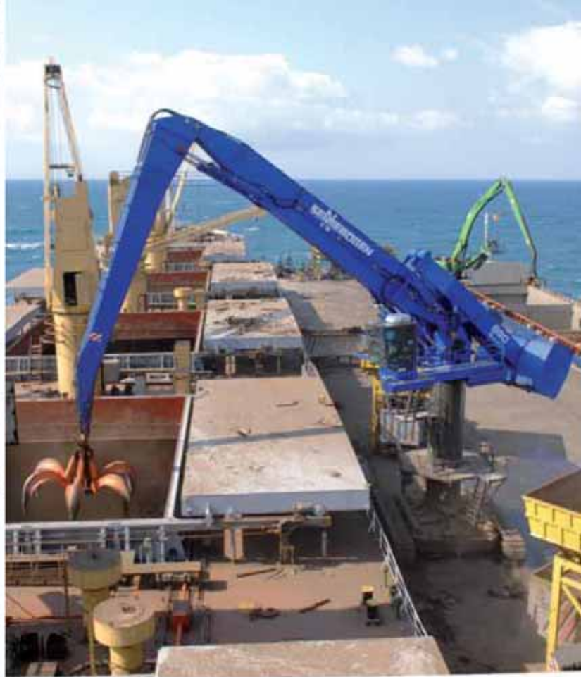
880 EQ Crawler - K30-equipment with orange peel grab, scrap handling; Turkey 880 EQ Raupe - Ausrüstung K30 mit Mehrschalengreifer, Schrotturnschlag; Türkei
