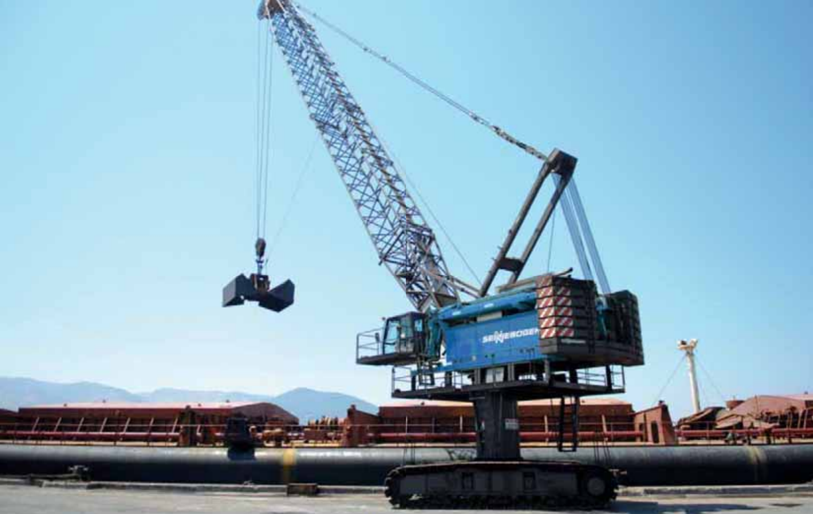
6130 HCC with pylon - coil handling with electro-hydraulic clamshell grab on the hook, grab control winch; Turkey 6130 HCC mit Pylon - Kohleumschlag mit elektro-hydraulischem Zweischalengreifer am Haken, Greiferberuhigungswinde; Türkei
