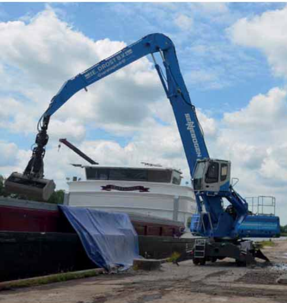
835 Mobile - K18-equipment, gravel handling in 14 m hopper; Netherlands 835 Mobil - Ausrüstung K18, Kiesverladung in 14 m hohen Trichter; Niederlande
