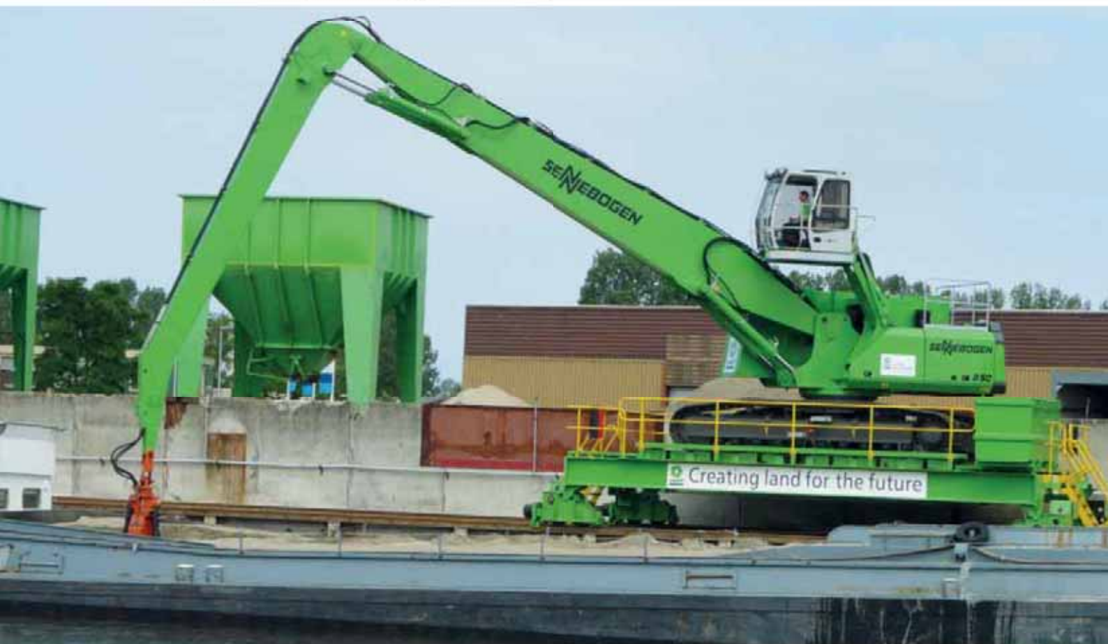
850 Crawler on rail wagon - B20-equipment with clamshell grab, sand handling; Netherlands 850 Raupe auf Schienenunterwagen - Ausrüstung B20 mit Zwischalengreifer, Sandumschlag; Niederlande
