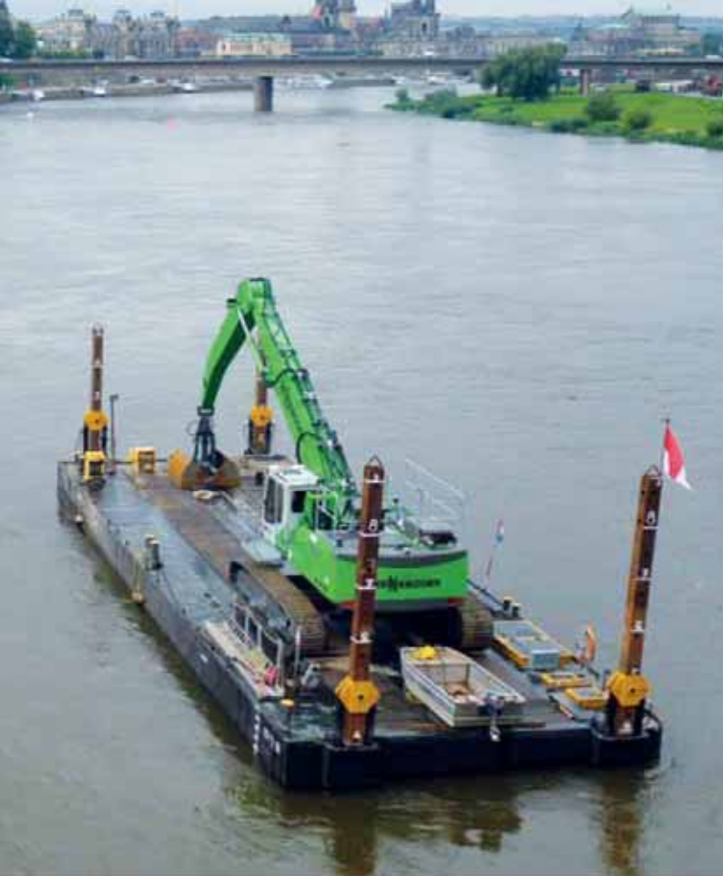
835 Crawler on barge - dredging Elbe water ways; Germany 835 Raupe auf Floß - Ausbaggern von Wasserwegen der Elbe; Deutschland
