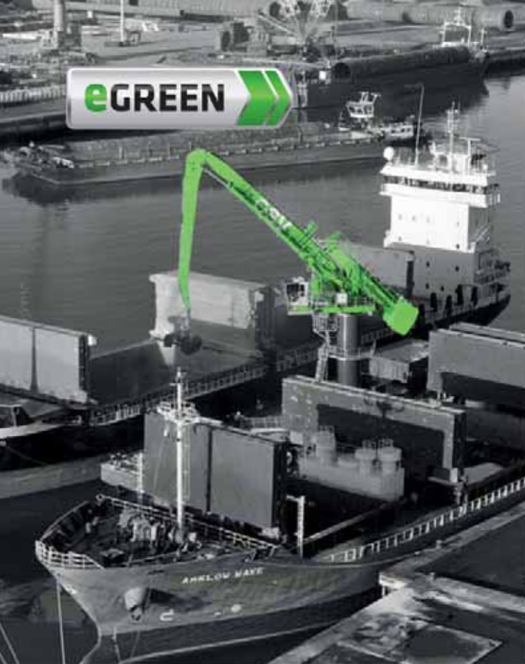
880 EQ Electro - mounted to pontoon for ship-to-ship-applications; Netherlands 880 EQ Elektro - Pontonaufbau für Ship-to-Ship Applikation; Niederlande
