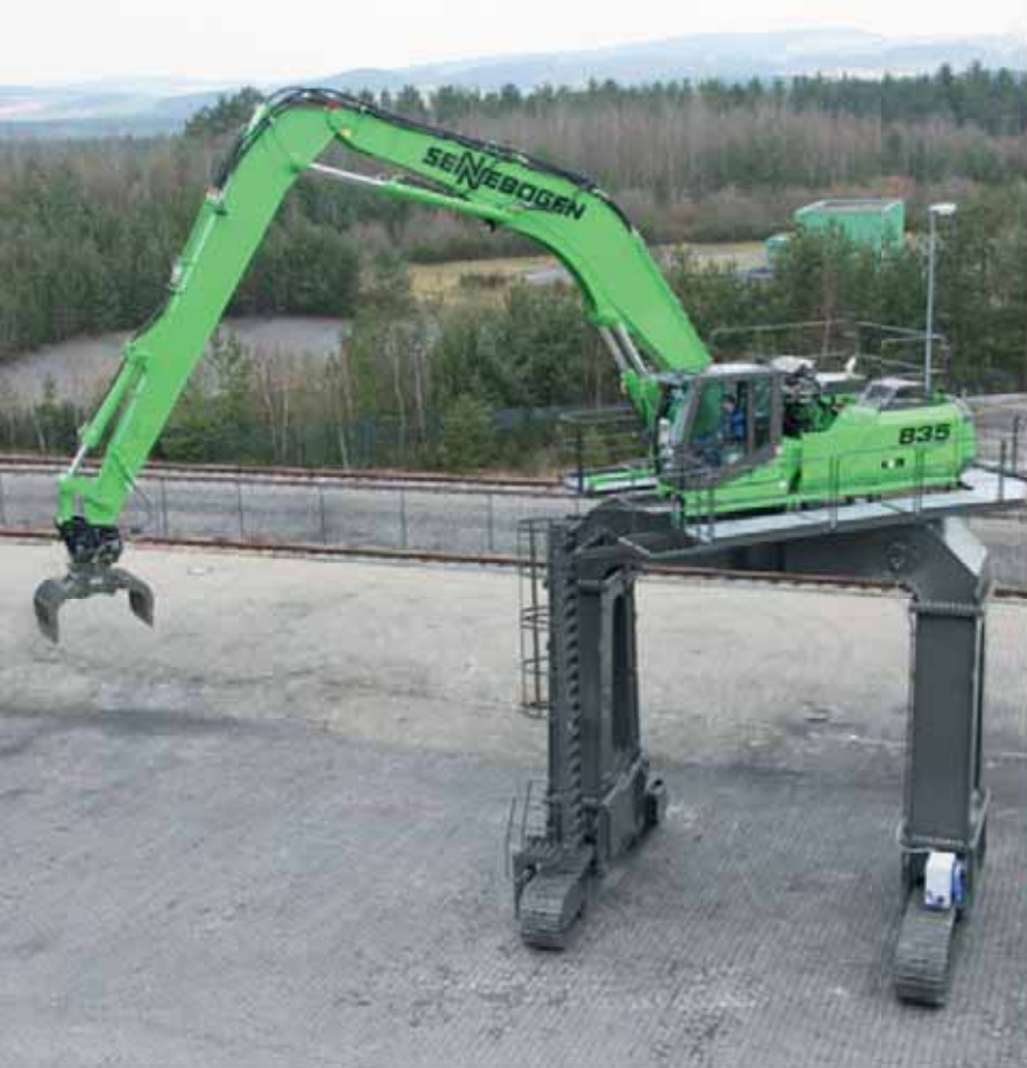
835 Crawler Gantry - B13-equipment, sorting grab; USA 835 Raupe Portal - Ausrüstung B13, Sortlergreifer; USA
