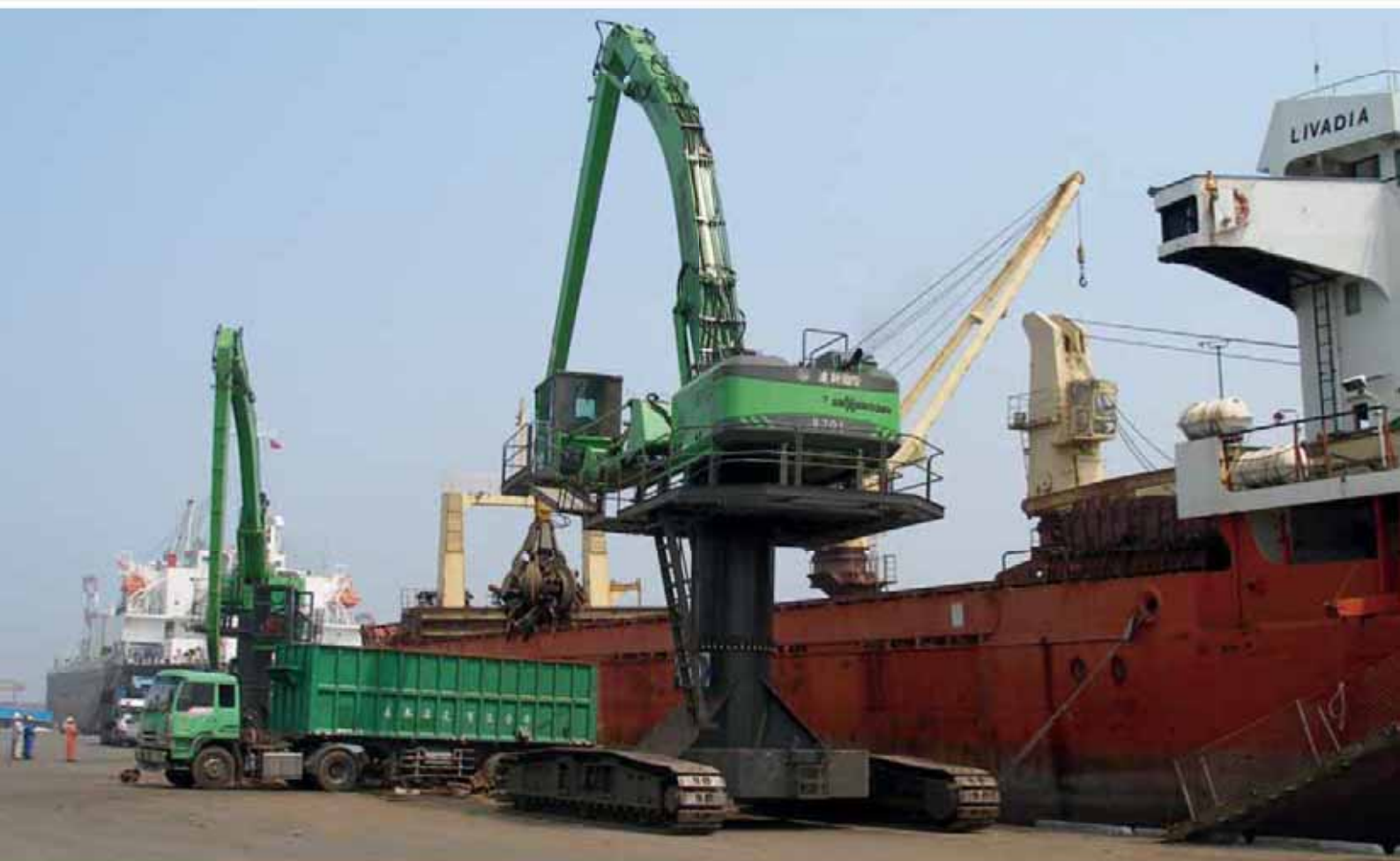
870 Crawler - 3 m pylon, B23-equipment with orange peel grab, scrap handling Taiwan 870 Raupex - 3 m Pylon, Ausrüstung B23 mit Mehrschalengreifer, Schrottschlag; Taiwan
