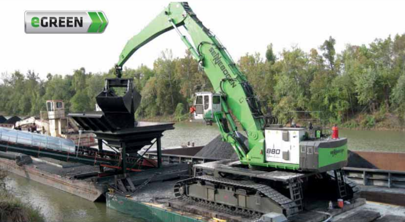
880 classic Crawler HD Electro - K20-equipment, 10.500 l clamshell grab; USA 880 classic Raupe HD Elektro - Ausrüstung K20, 10.500 l Zweischalengreifer; USA
