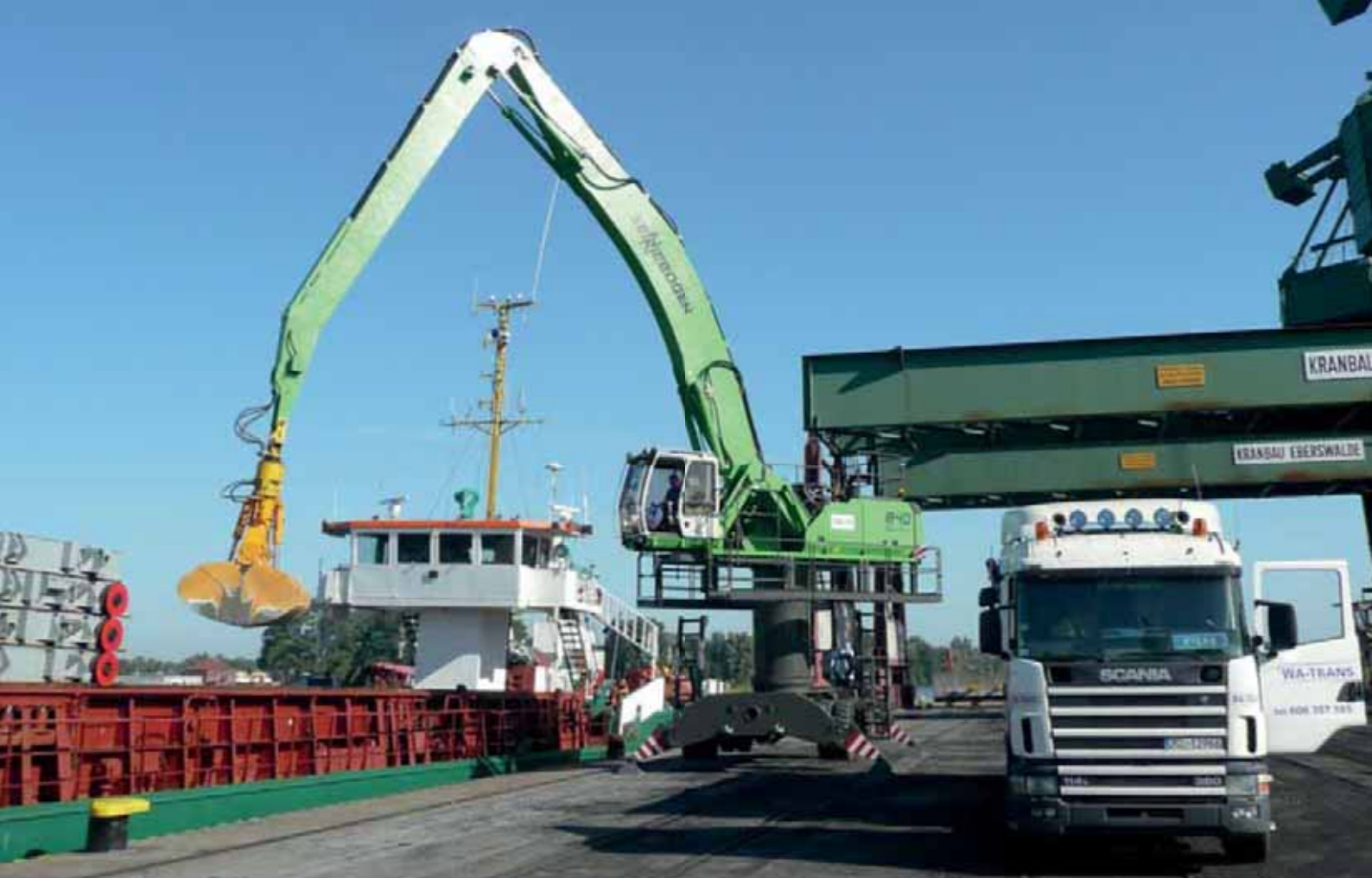
840 Mobile - 2,50 m pylon, B19-equipment, Multitool, gravel handling; Belgium 840 Mobil - 2,50 m Pylon, Ausrüstung B19, Multitool, Kiesverladung; Belgien
