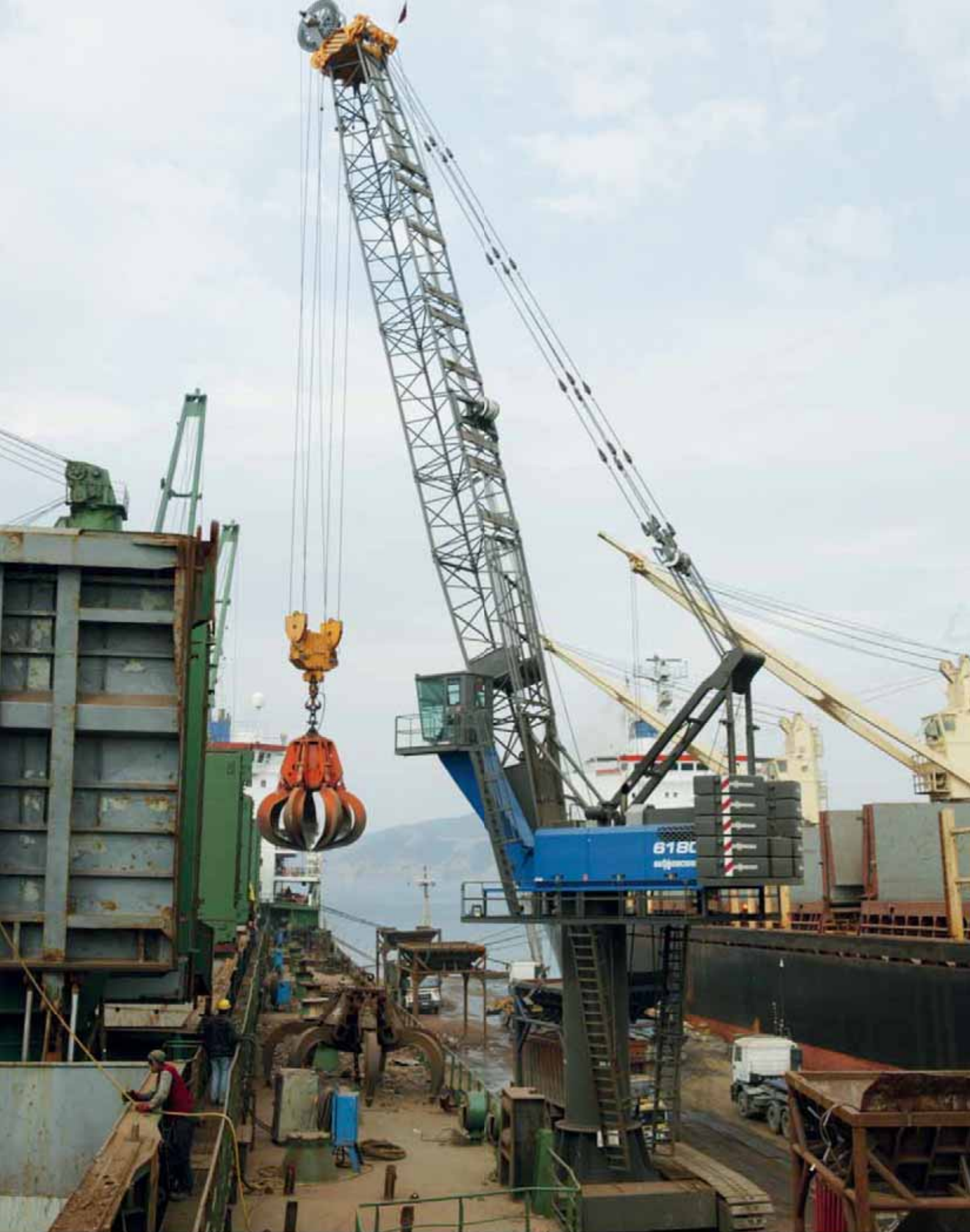
6180 HCC - 8 m pylon, 33 m boom length, scrap handling with orange peel grab on swiveling hook; Turkey 6180 HCC - 8 m Pylon, 33 m Auslegerlänge, Schrottschlag mit Mehrschalenqräfer am Drehhaken; Türkei
