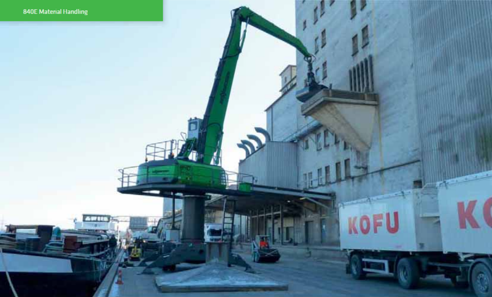
840 Mobile - 2,70 m pylon, K20-equipment, crop handling with light bulk grab; Germany 840 Mobil - 2,70 m Pylon, Ausrüstung K20, Getreideentladung mit Leichtgutgreifer, Deutschland
