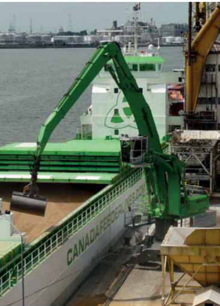
37 860 M - 2 m pylon, B21-equipment, grain handling; Belgium 860 M - 2 m Pylon, Ausrüstung B21, Getreideumschlag, Belgien
