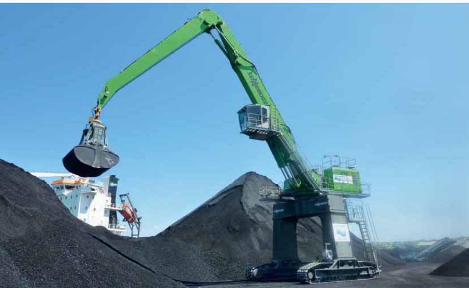
875 Crawler Gantry - K27-equipment with 8 m 3 light-weight clamshell grab, coal handling; Spain 875 Raupe Portal - Ausrüstung K27 mit 8 m 3 Leichtgutgreifer, Kohleumschlag, Spanien
