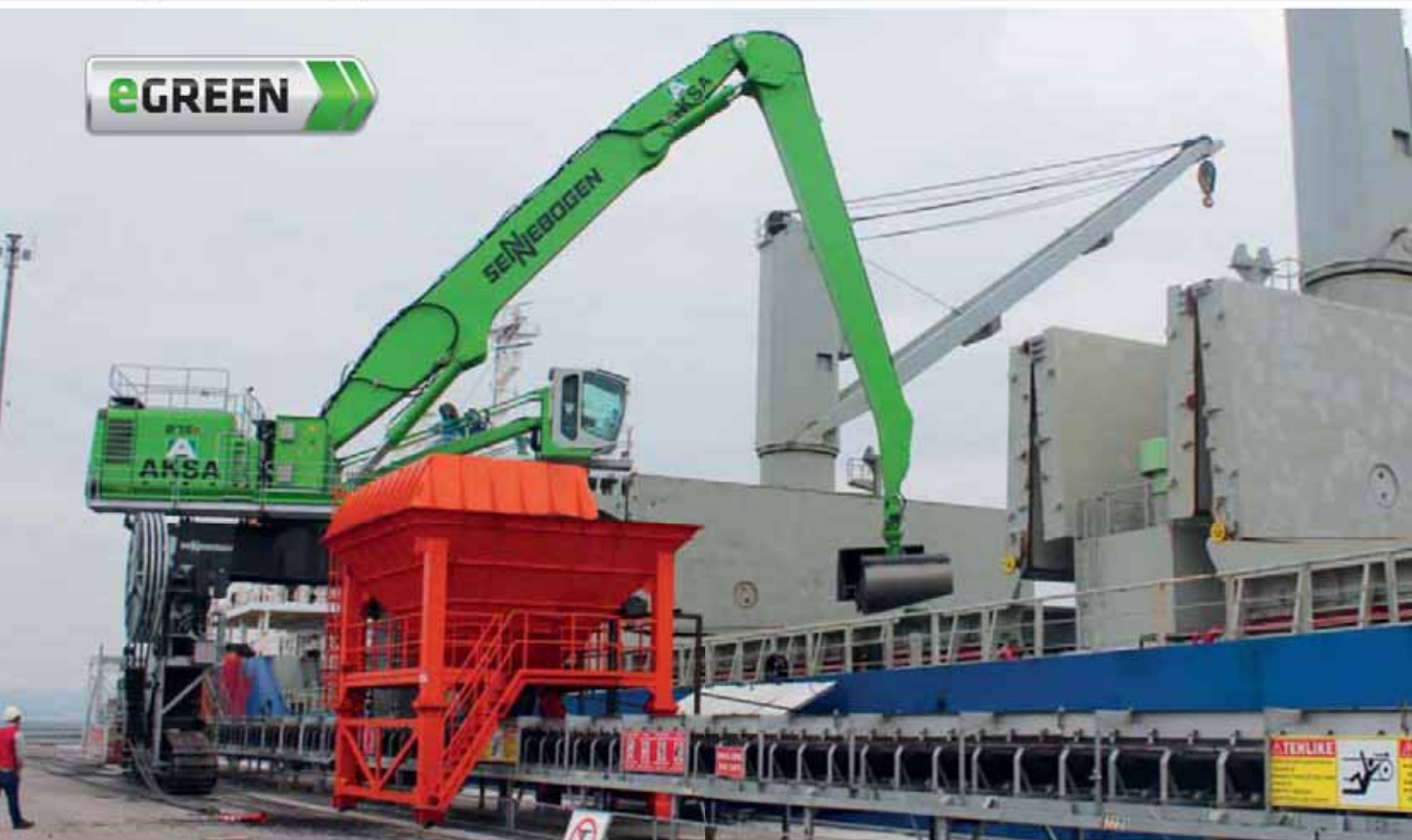
875 Electro Crawler Gantry - coal handling with clamshell grab; Turkey 875 Elektro Raupe Portal - Kohleumschlag mit Zweischaufelgreifer, Türkei
