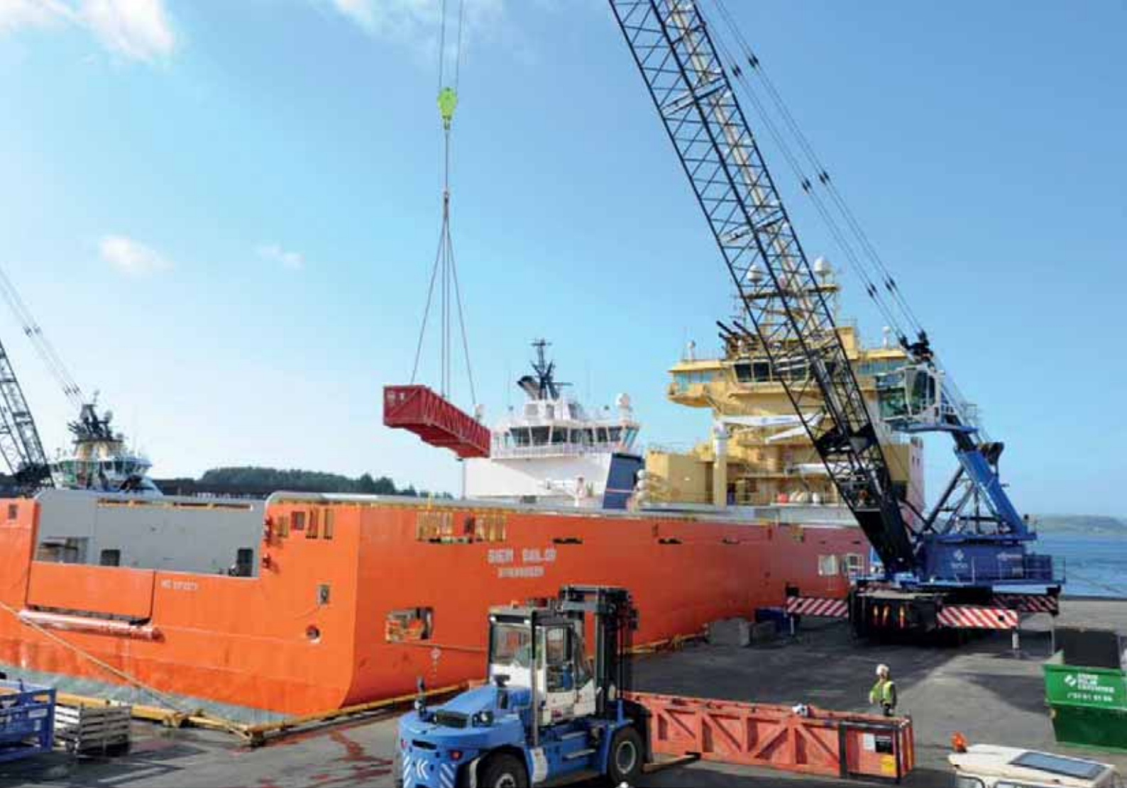
6210 HMC - 53,5 m radius , 2 x 200 kN double winch with speeds up to 103 m/s, loading of supply cargo; Norway 6210 HMC - 53,5 m Ausladung, 2 x 200 kN Doppelwinde mit Geschwindigkeiten bis zu 103 m/s, Verladung von Versorgungsgütern; Norwegen
