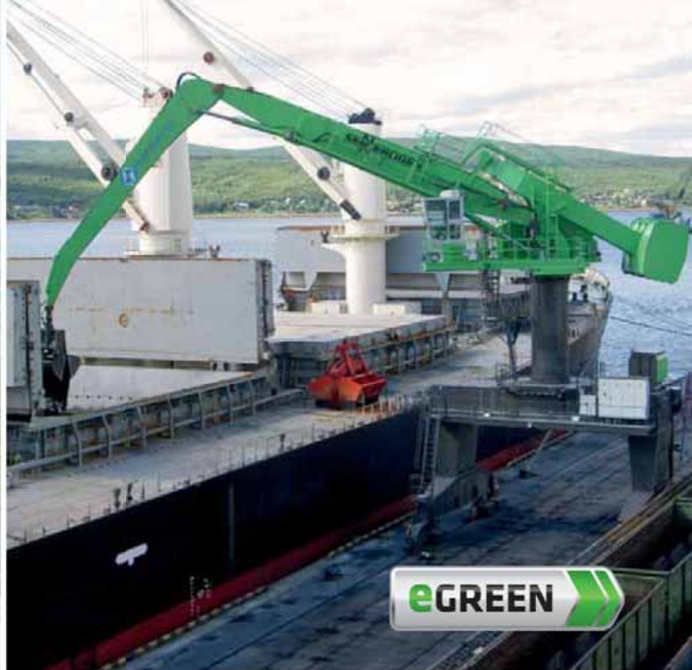
880 EQ Electro Rail Gantry - 6 m clearance height, K30-equipment with 4 m 3 clamshell grab; Russia 880 EQ Elektro Portl auf Schiene - 6 m Durchfahrthöhe, Ausrüstung K30 mit 4 m 3 Zweischalengreifer; Russland
