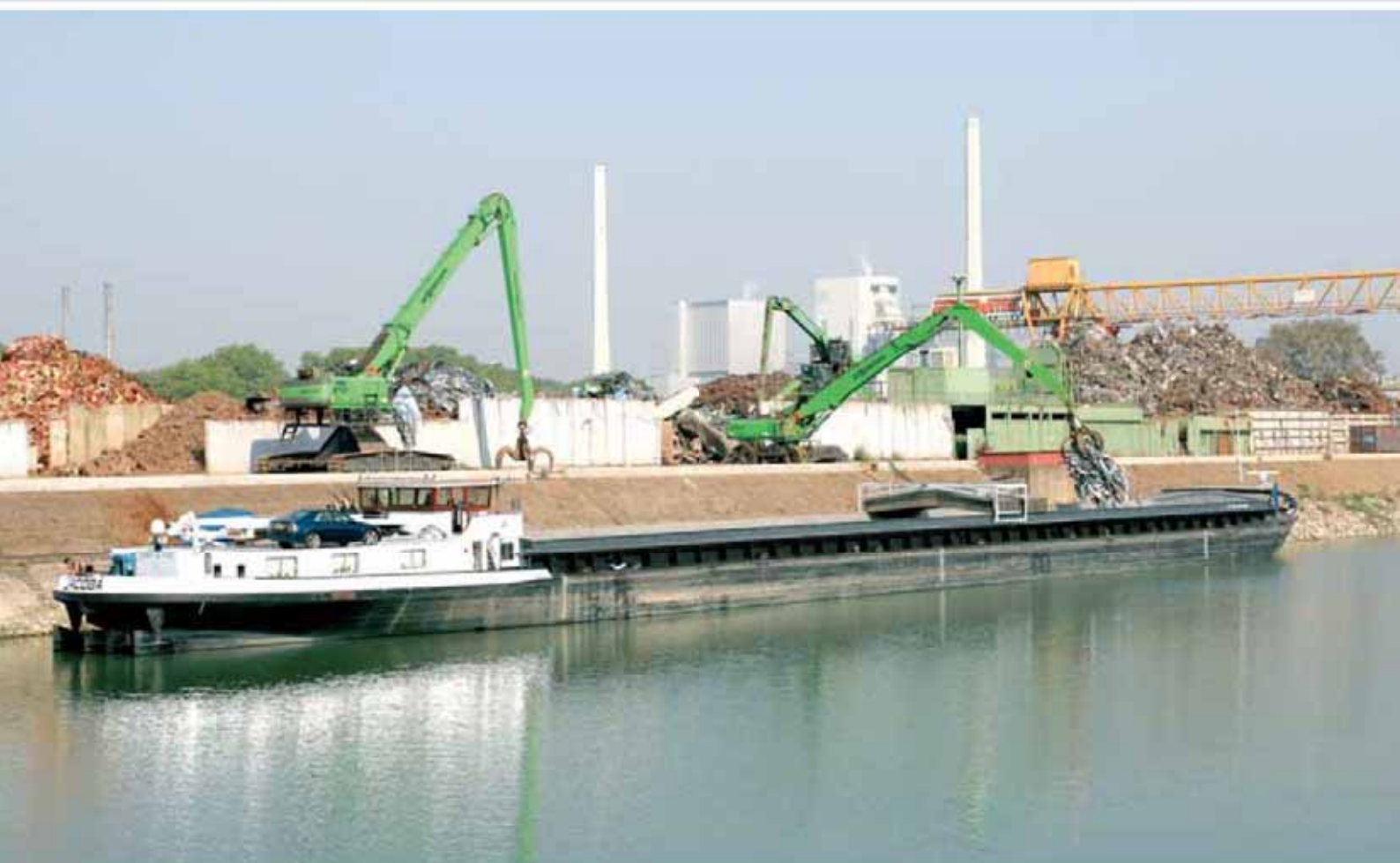
850 Mobile - K21-equipment with orange peel grab, scrap handling; Germany 850 Mobil - Ausrüstung K21 mit Mehrschalengreifer, Schrottumschlag; Deutschland
