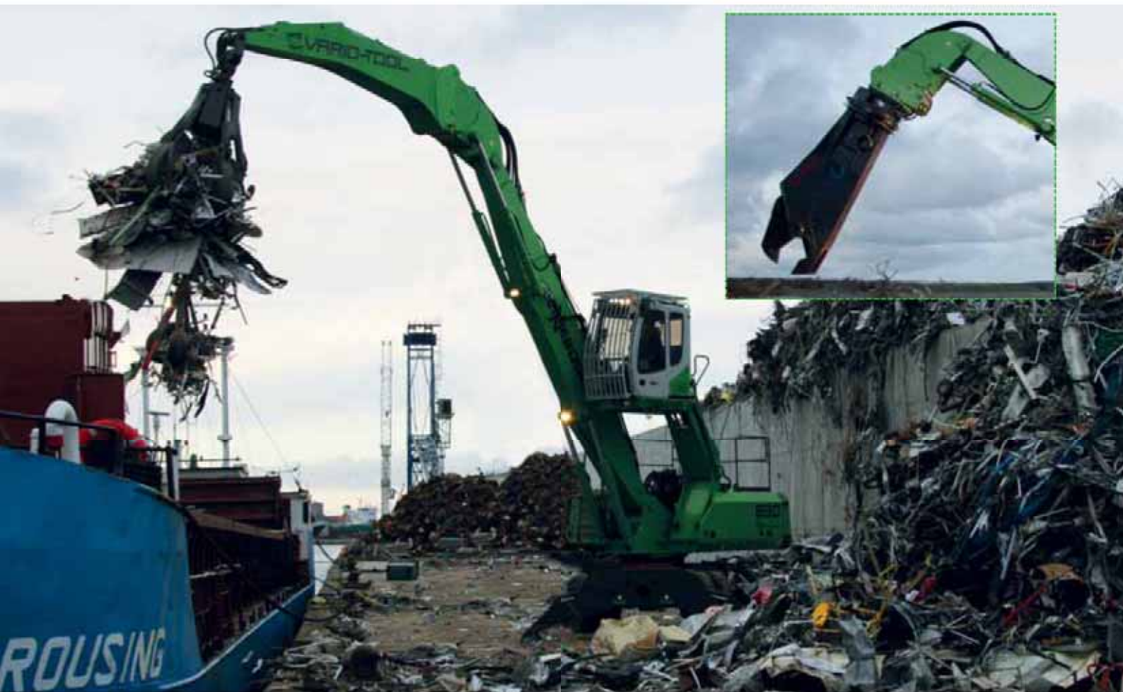
830 Mobile Vario Tool - Change attachment in 2 minutes to scrap metal shear, scrap handling; Denmark 830 Mobil Vario Tool - Werkzeugwechsel in 2 Minuten auf Schrottschere, Schrotturnschlag; Dänemark
