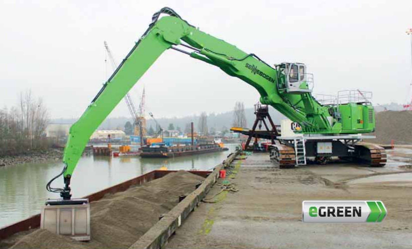
875 Crawler Electro - K21-equipment with clamshell grab, sand and gravel handling; USA 875 Raupe Elektro - Ausrüstung K21 mit Zweischalengreifer, Sand- und Kiesumschlag; USA
