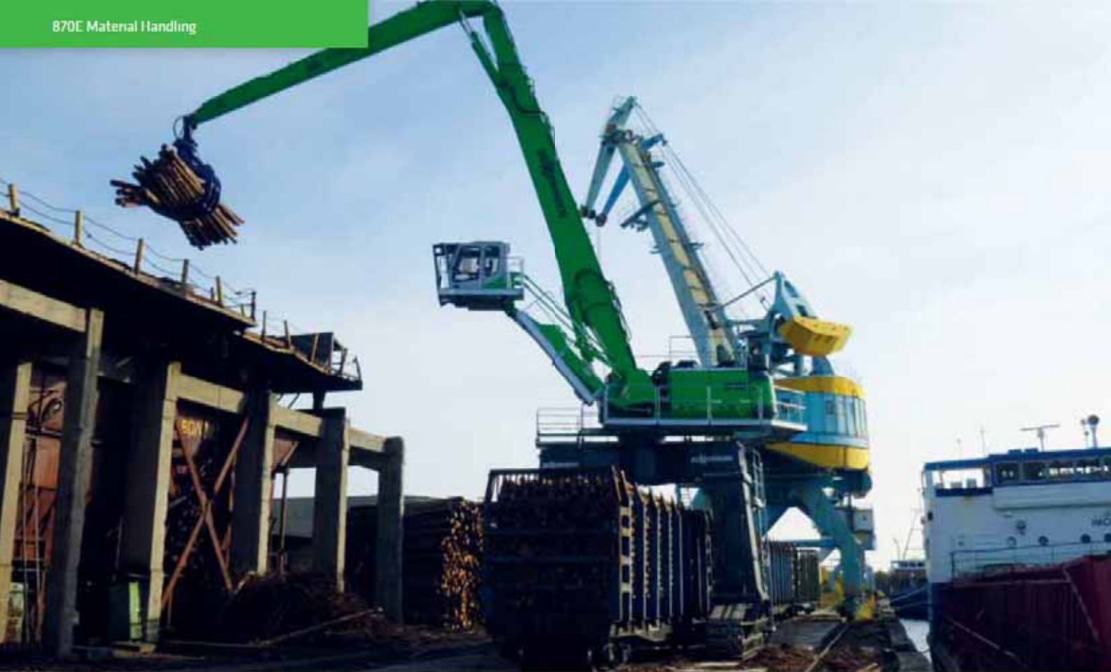
870 Crawler Gantry - K24-equipment, unloading timber from barges and wagons; Russia 870 Raupe Portal - Ausrüstung K24, Holzladung von Binnenschiffen und Waggons; Russland
