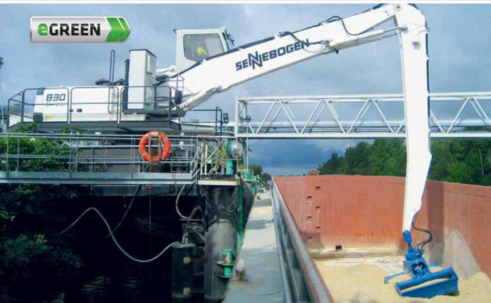
830 Electro on 4-point-pedestal - K15-equipment, sand and gravel handling; France 830 Elektro auf 4-Punkt-Untergestell - Ausrüstung K15, Sand- und Kiesverladung; Frankreich
