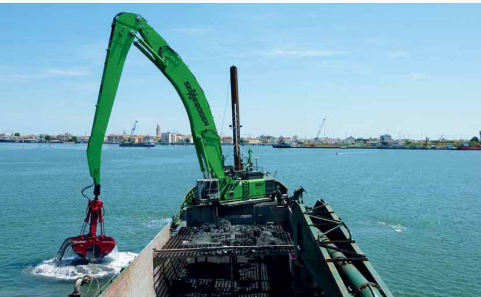
880 classic - mounted to ship, special boom B29, dredging works, sand- and gravel extraction; Italy 880 classic - Schiffsaufbau, Spezialausrüstung B29, Nassbaggerarbeiten, Sand- und Kiesabbau, Italien
