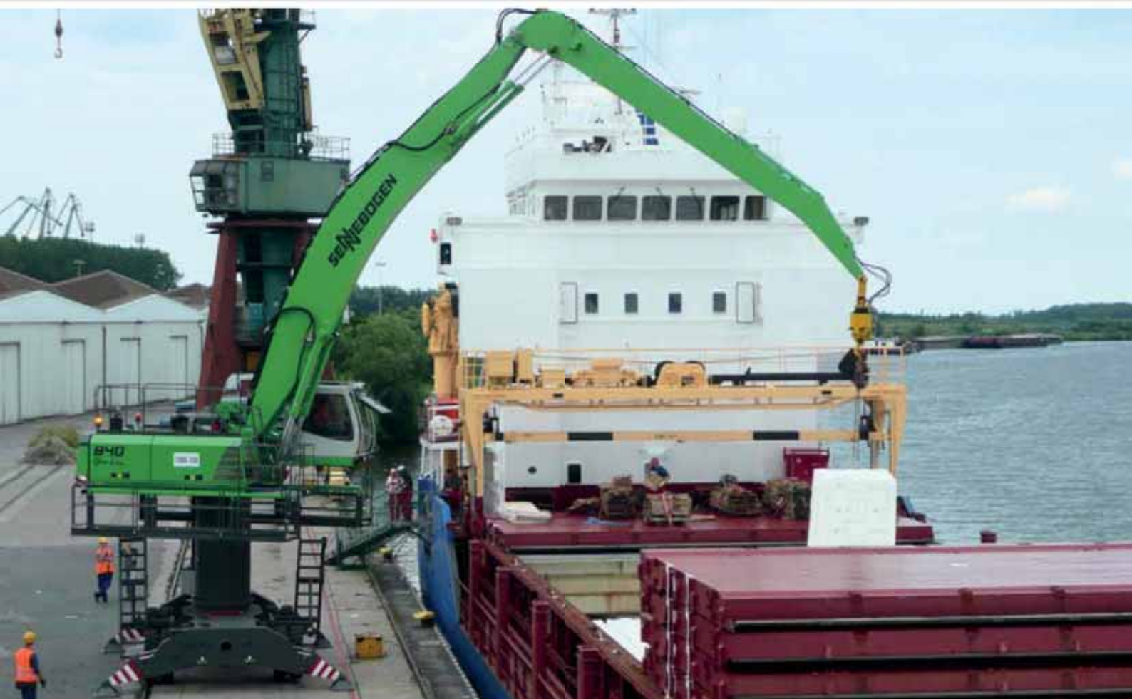
840 Mobile - 2,70 m pylon, B19-equipment, chipboard handling; Poland 840 Mobil - 2,70 m Pylon, Ausrüstung B19, Spanplattenumschlag; Polen
