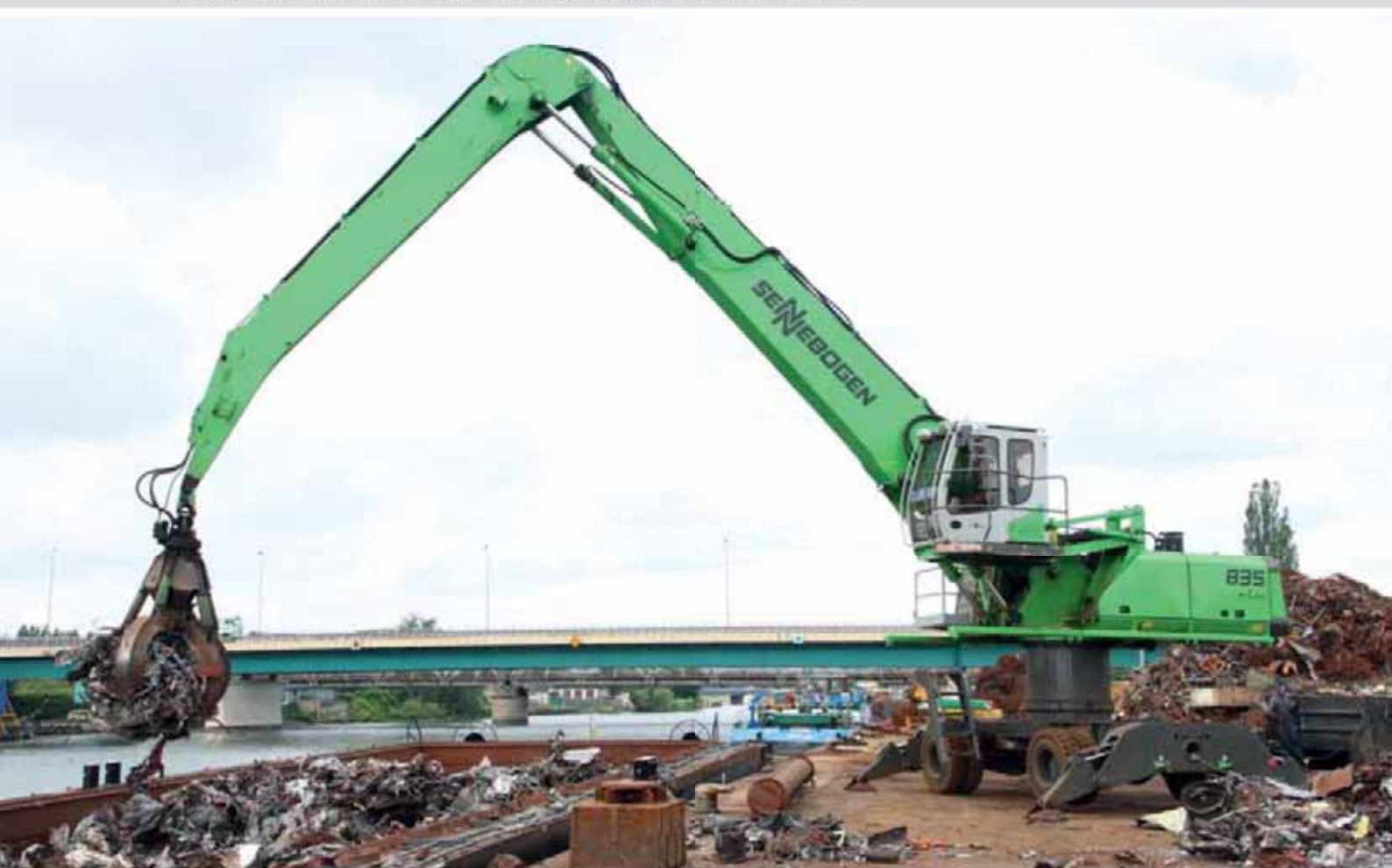
835 Mobile - 1,5 m pylon, K20-equipment, scrap handling; Poland 835 Mobil - 1,5 m Pylon, Ausrüstung K20, Schrottschlag, Polen
