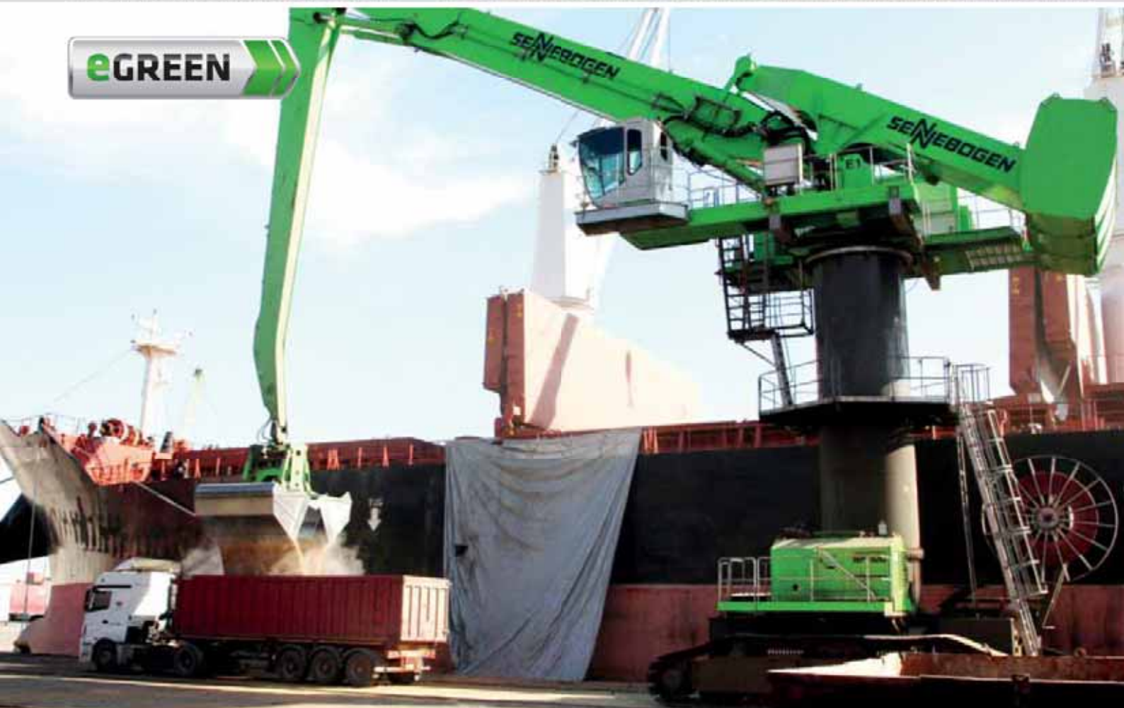
880 EQ Electro with power pack - K35-equipment with light-bulk-grab, grain handling; Turkey 880 EQ Elektro mit Powerpack - Ausrüstung K35 mit Leichtgut-Zweischalengreifer, Getreideumschlag; Türkei
