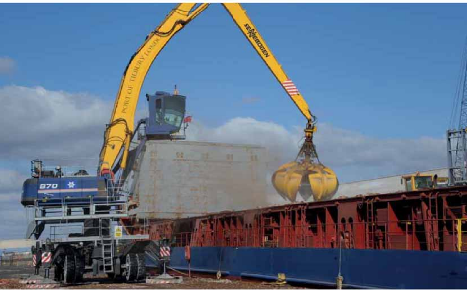
870 Mobile - B23-equipment with large light weight material orange peel grab, wood chip handling, UK 870 Mobil - Ausrüstung B23 mit großem Leichtgut-Mehrschalengreifer, Hackschnitzelumschlag, Großbritannien
