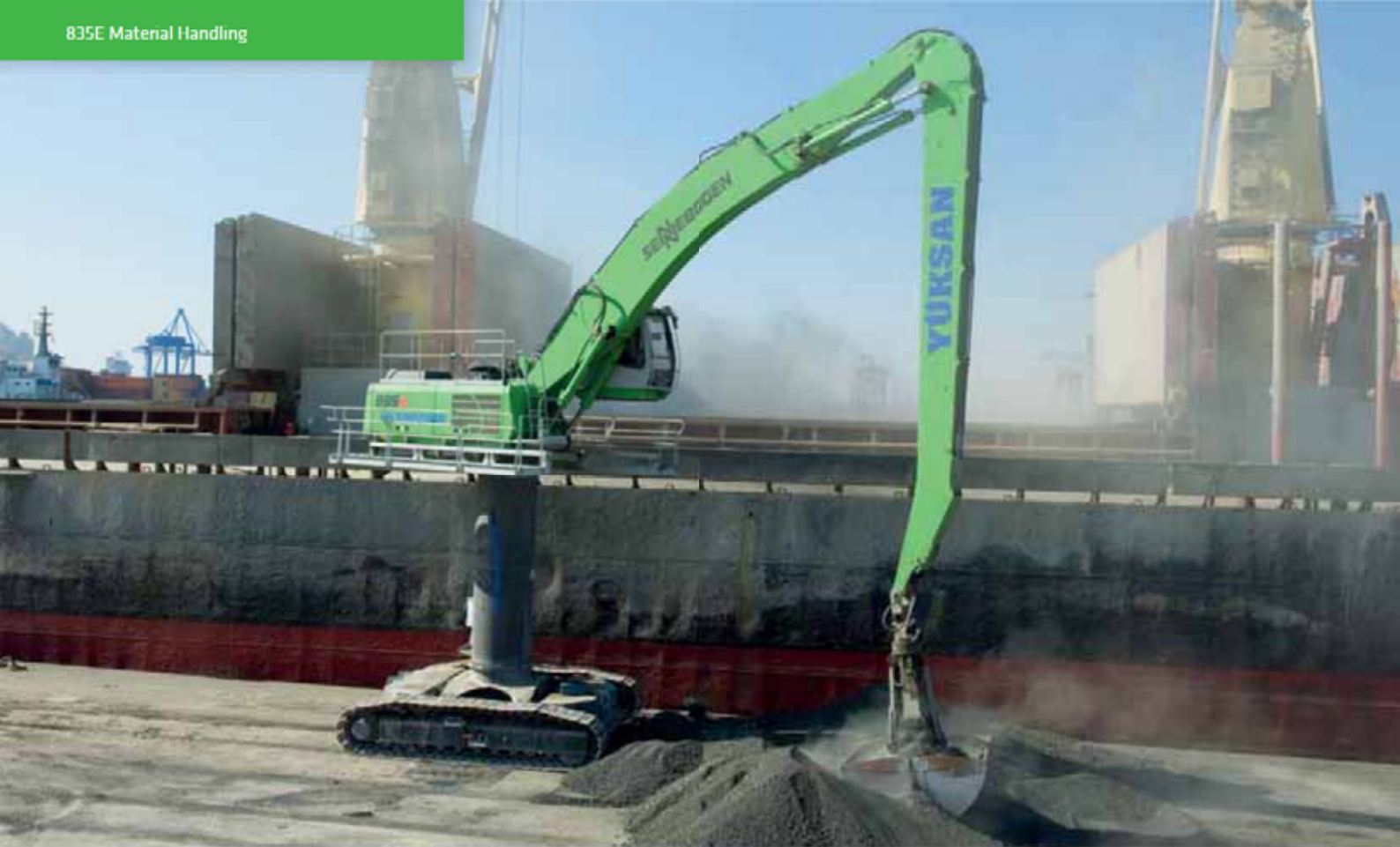
835 Crawler - 4,5 m pylon, B19-equipment with 3m 3 clamshell grab, loading ore; Turkey 835 Roupe - 4,5 m Pylon, Ausrüstung B19 mit 3m 3 Zwienschalengreifer, Erzverladung; Türkei
