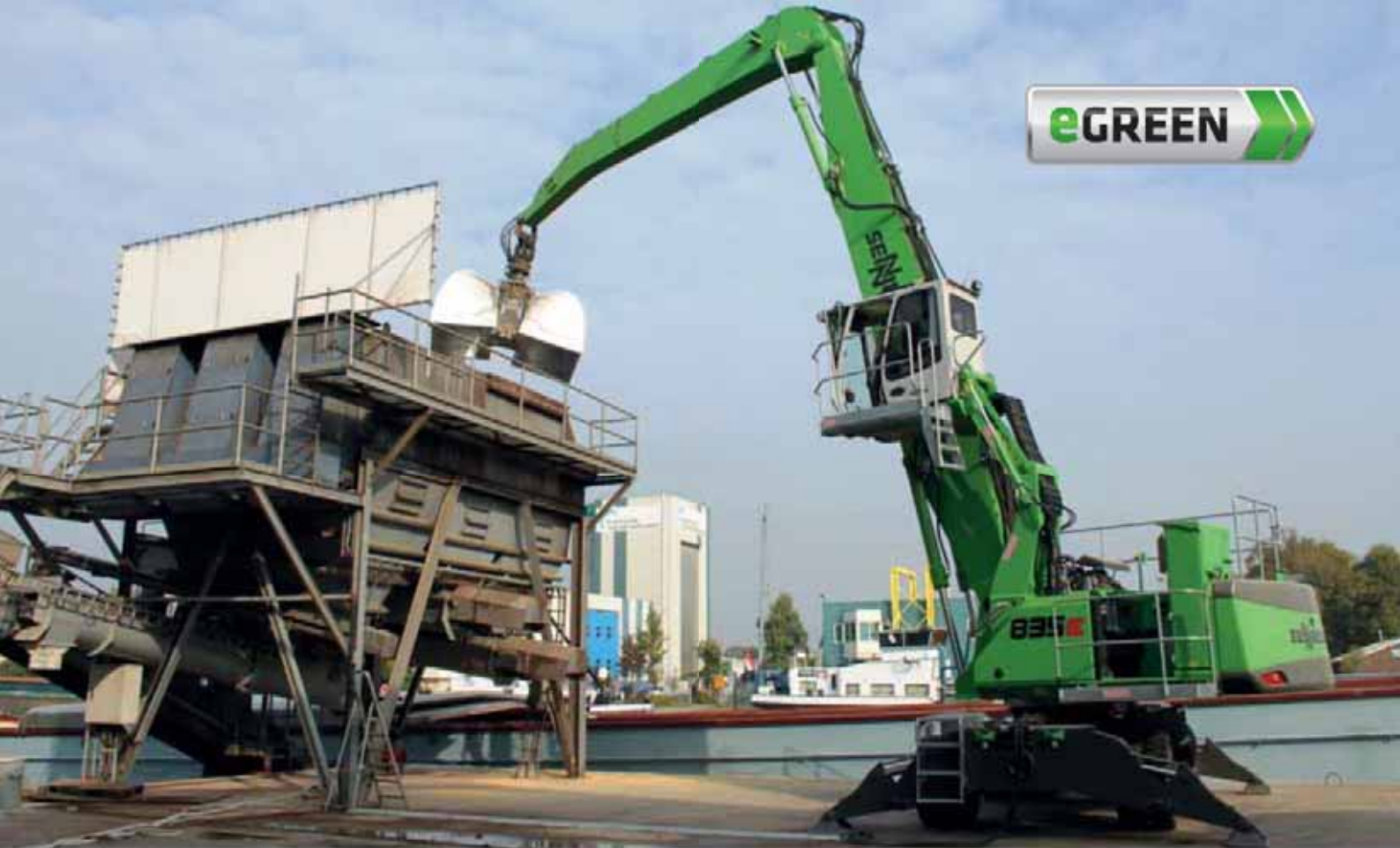
835 Mobile Electro - K18-equipment with clamshell grab, fodder handling; Netherlands 835 Mobil Elektro - Ausrüstung K18 mit Zweischalengreifer, Futtermittelumschlag; Niederlande
