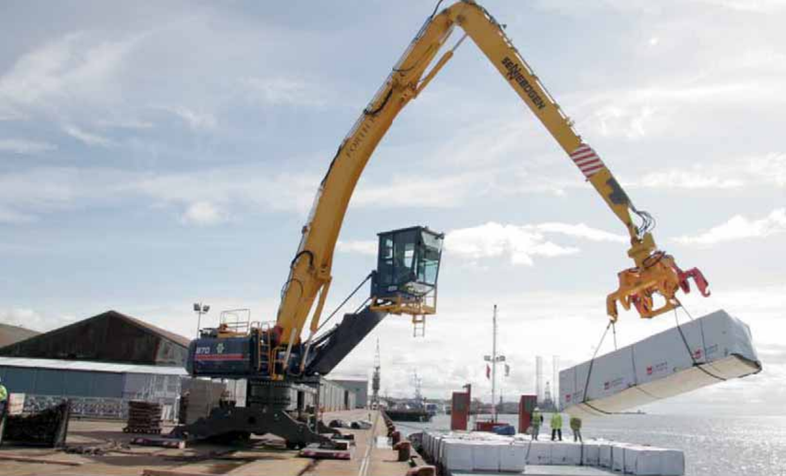
870 Mobile - 0,7 m pylon, B23-equipment with Multitool and timber spreader, pallet handling; Scotland 870 Mobil - 0,7 m Pylon, Ausrüstung B23 mit Multitool und Holzspreader, Holzpalettenverladung; Schottland
