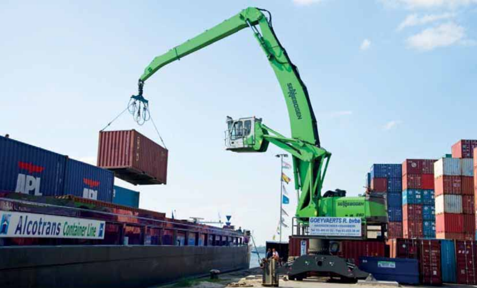
860 Mobile - 2 m pylon, B21-equipment, container handling with loading bar; Belgium 860 Mobil - 2 m Pylon, Ausrüstung B21, Containerumschlag mit Traverse; Belgien
