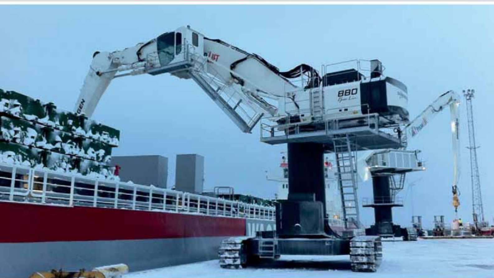
880 classic Crawler - reliable even at -22° F, electrical pre-heating of engine block, hydraulic oil and batteries, heated cylinder sleeves; Finland 880 classic Raupe - zuverlässig auch bei -30° C, elektrische Vorheizung von Motorblock, Hydrauliköl und Batterien, beheizte Zylinderhülsmanschetten, Finnland
