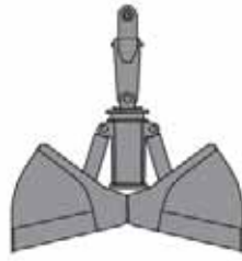
light bulk material Schüttgut leicht
