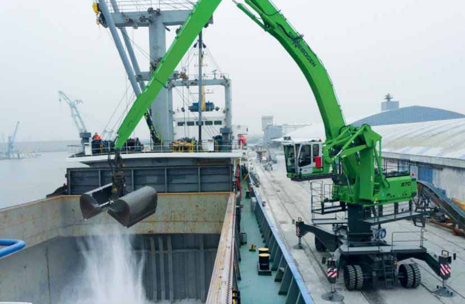
870 Mobile - 2 m pylon, extremely robust undercarriage, B21-equipment with 5 m³ clamshell grab, fertilizer handling; Belgium 870 Mobil - 2 m Pylon, extrem robuster Unterwagen, Ausrüstung B21 mit 5 m³ Zweischalengreifer, Düngemittelumschlag; Belgien
