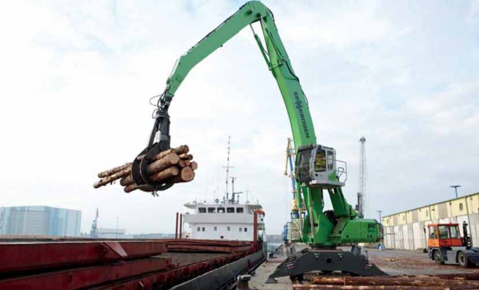
840 Mobile - B19-equipment, log handling; Germany 840 Mobil - Ausrüstung B19, Rundholzumschlag; Deutschland
