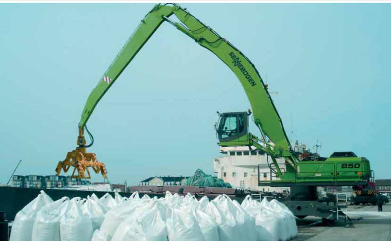
850 Mobile - 0,7 m pylon, B20-equipment, big bag-loading with loading frame; Russia 850 Mobil - 0,7 m Pylon, Ausrüstung B20, Big Bag-Verladung mit Hubtraverse; Russland
