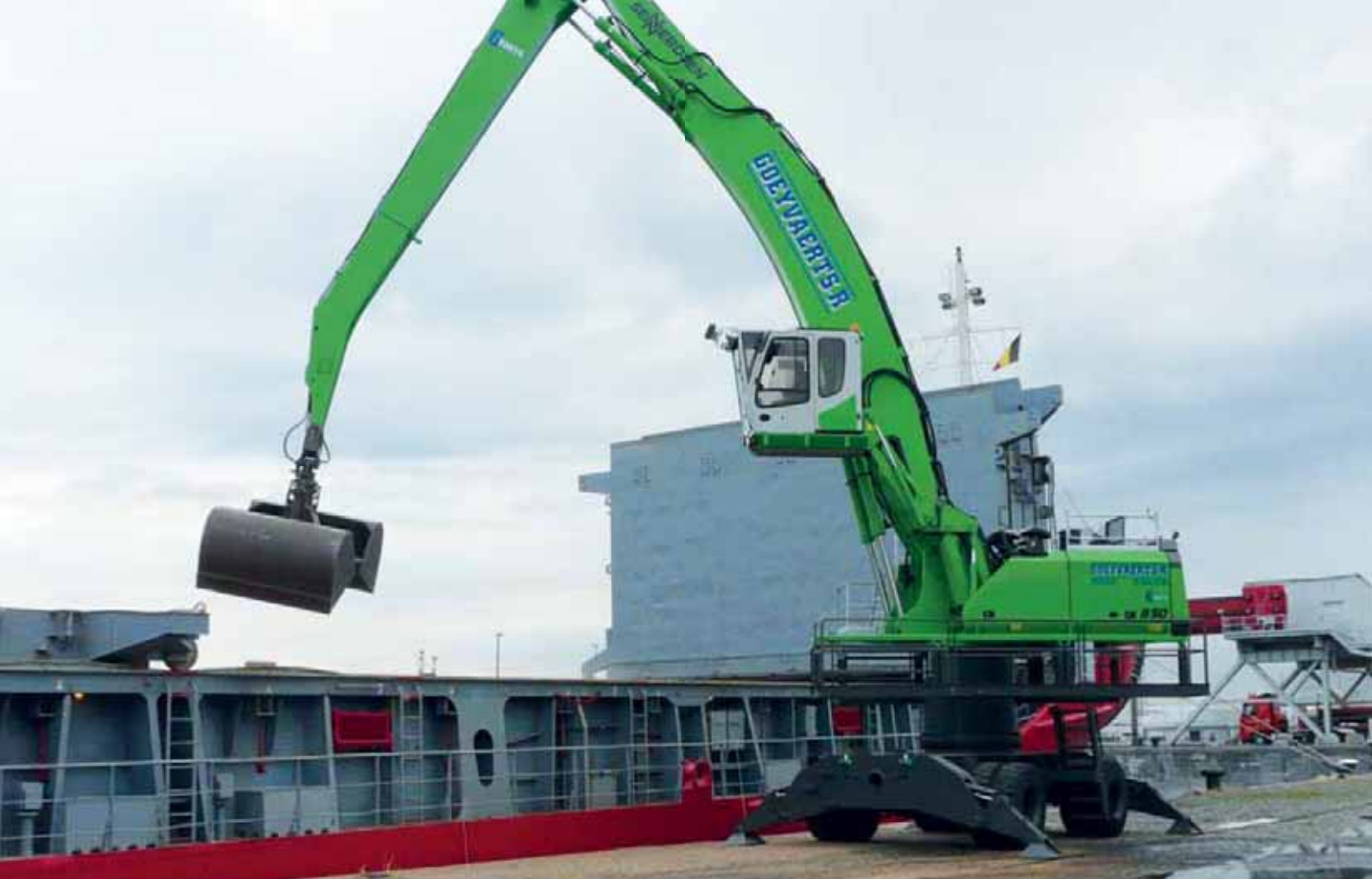
850 Mobile - B20-equipment with light bulk clamshell grab, grain handling; Belgium 850 Mobil - Ausrüstung B20 mit Leichtgut-Zwischalengreifer, Getreideumschlag, Belgien
