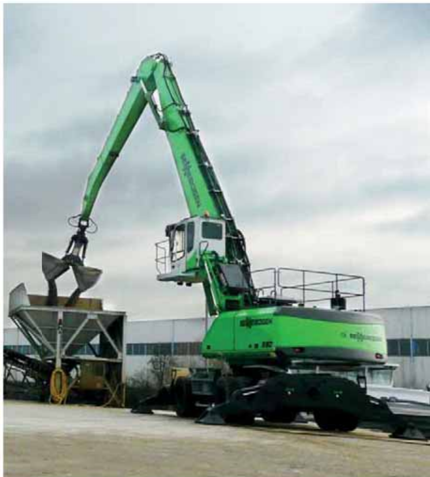
860 Mobile - K21-equipment with clamshell grab, sand and gravel handling; Netherlands 860 Mobil - Ausrüstung K21 mit Zweischalengreifer, Sand- und Kiesumschlag, Niederlande
