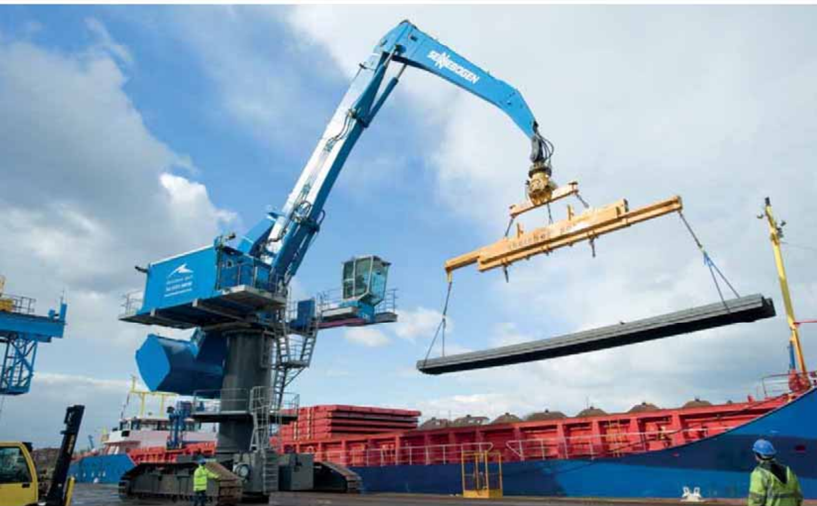
880 EQ Crawler - K30-equipment, loading of steel beams with beam-spreader; UK 880 EQ Raupe - Ausrüstung K30, Verladung von Stahlträgern mit Beam-Spreader, Großbritannien
