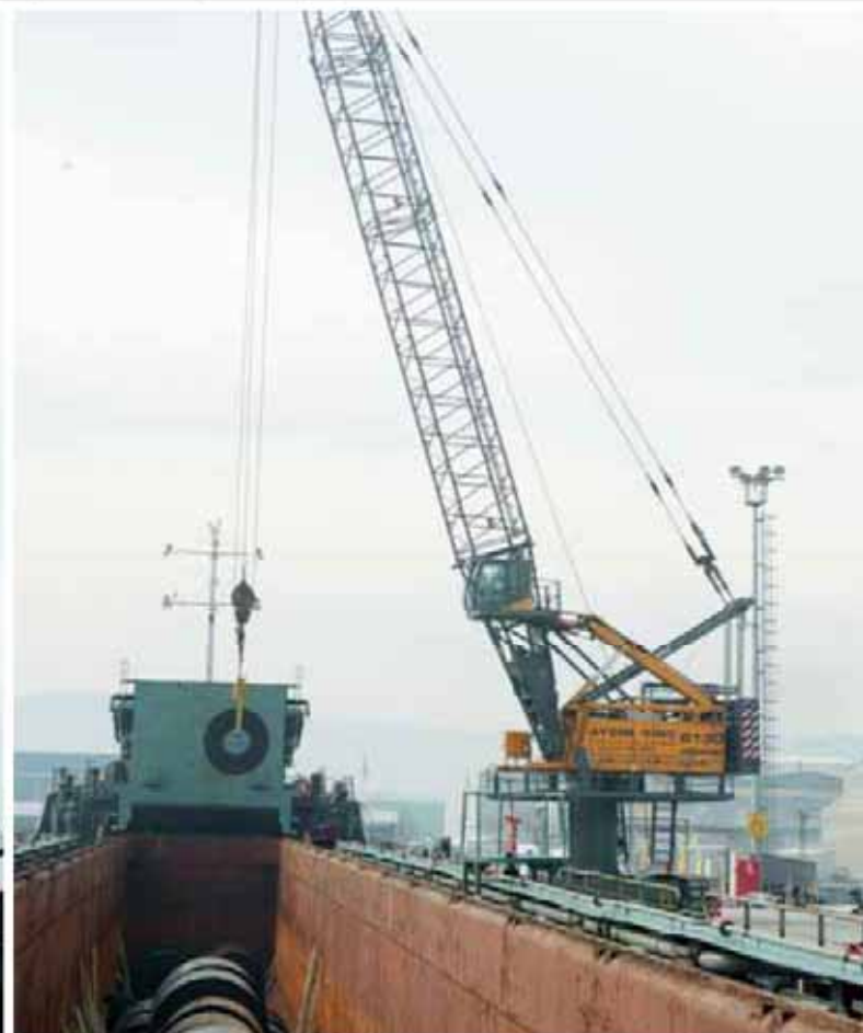
6130 HCC with 3 m pylon - 30 m boom length, steel coil handling in lifting mode with coil hook or bulk handling with electro grab; Turkey 6130 HCC mit 3 m Pylon - 30 m Auslegerlänge, Stahlcoilumschlag im Hakenbetrieb mit Coilhaken oder Schüttgutumschlag mit elektrischem Greifer, Türkei
