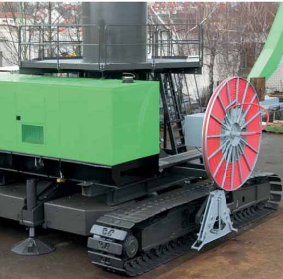
880 EQ Electro - extremely robust crawler undercarriage with power pack to freely move the machine 880 EQ Elektro - extrem stabiler Raupenunterwagen mit Power Pack zum freien Verfahren
