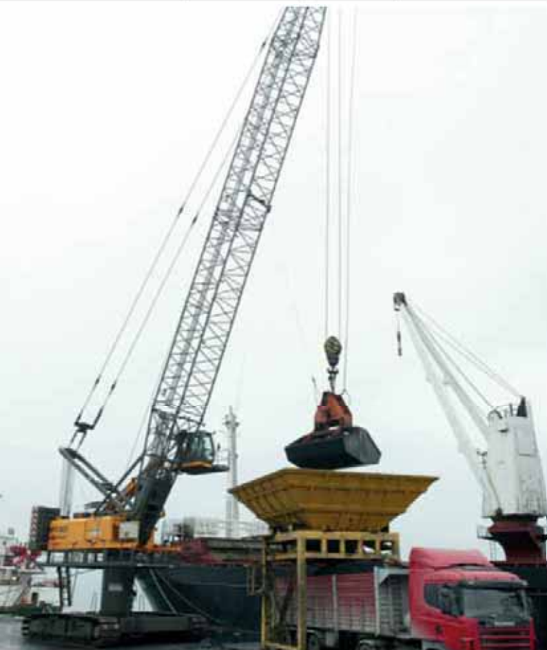
6130 HCC with 3 m pylon - 30 m boom length, steel coil handling in lifting mode with coil hook or bulk handling with electro grab; Turkey 6130 HCC mit 3 m Pylon - 30 m Auslegerlänge, Stahlcoilumschlag im Hakenbetrieb mit Coilhaken oder Schüttgutumschlag mit elektrischem Greifer, Türkei
