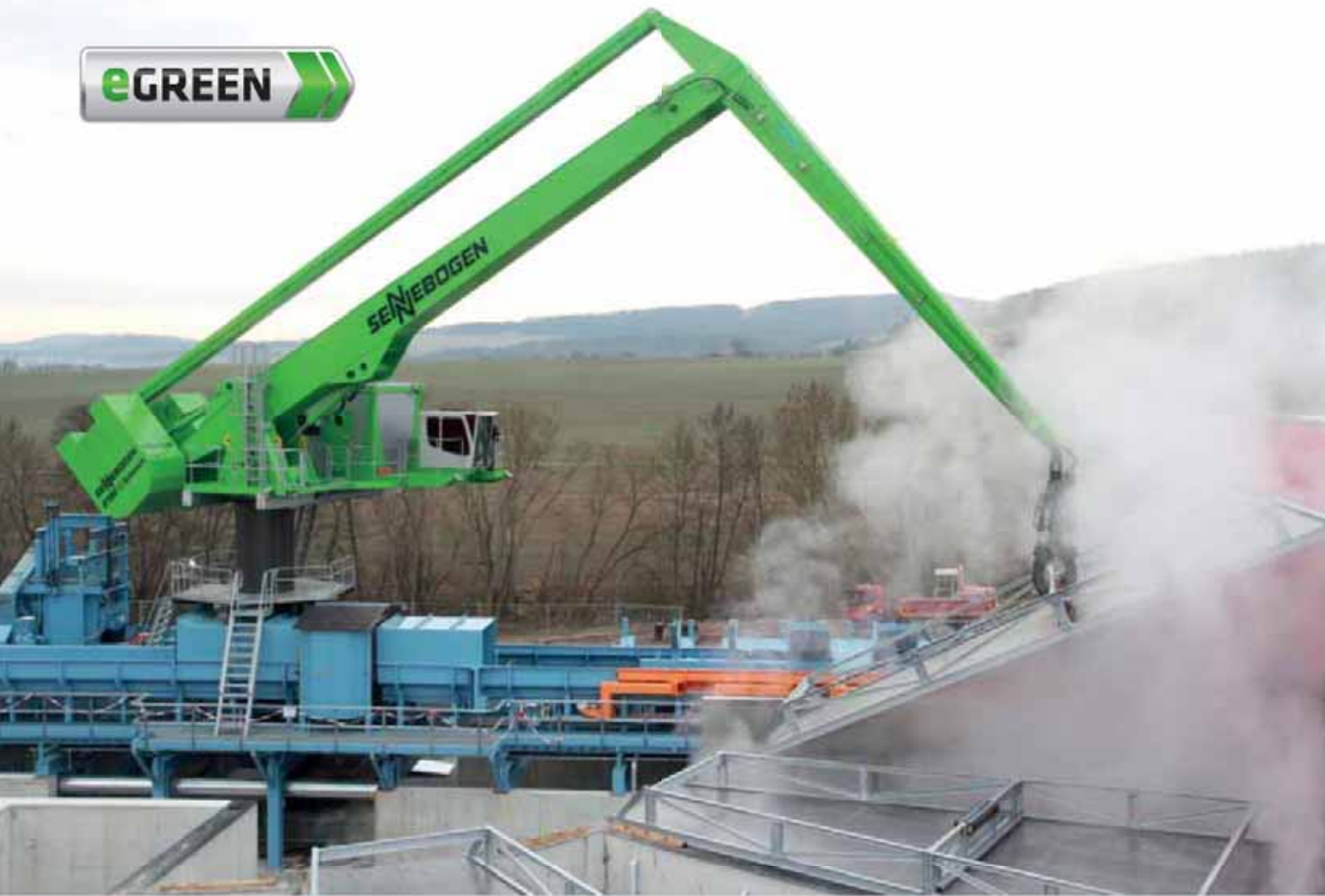
8130 EQ Electro - charging logwood to conditioning pools in veneer production, Germany 8130 EQ Elektro - Beschickung von Konditionierbecken mit Rundholz zur Furnierherstellung; Deutschland
