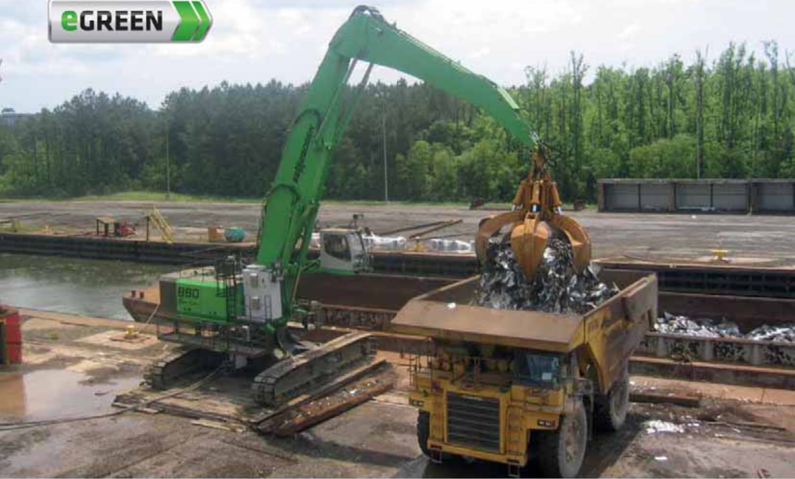
880 classic Crawler Electro - K20-equipment with orange peel grab, scrap handling; USA 880 classic Raupe Elektro - Ausrüstung K20 mit Mehrschalengreifer, Schrottschlag, USA
