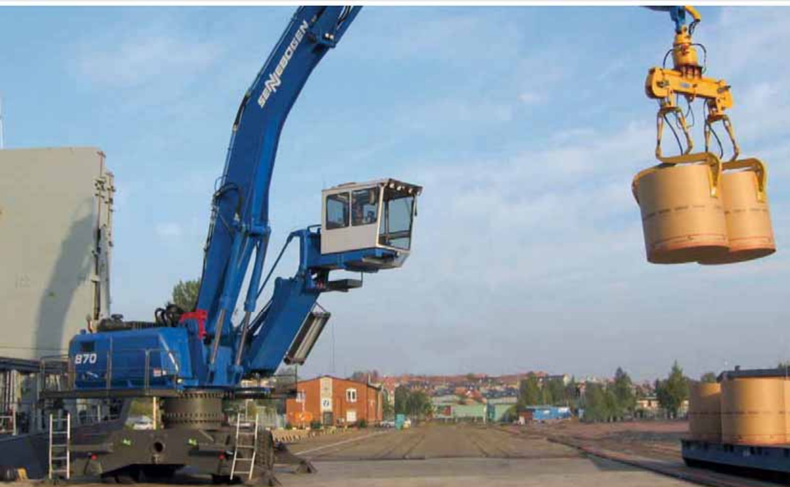
870 Mobile - 0,7 m pylon, B20-equipment with paper coil spreader; Sweden 870 Mobil - 0,7 m Pylon, Ausrüstung B20 mit Papiercoil-spreader; Schweden
