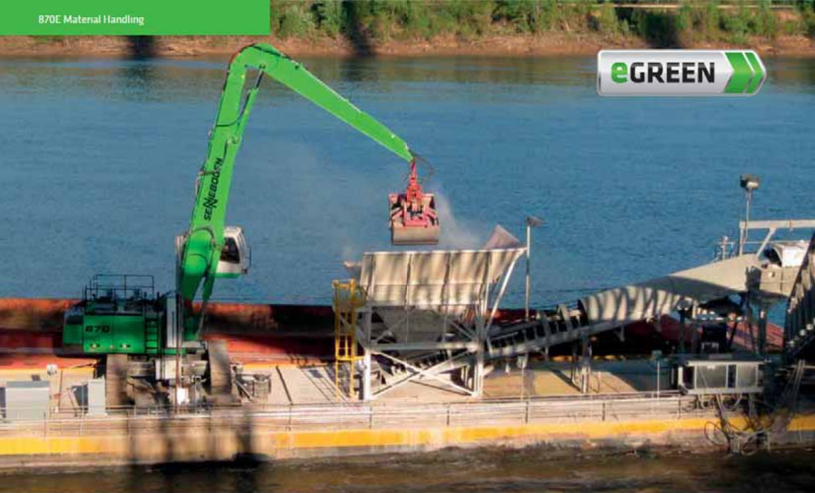
870 Crawler Electro - K20-equipment, clamshell grab, lime stone handling; USA 870 Raupe Elektro - Ausrüstung K20, Zweischalengreifer, Kalksteinnurrschlag; USA
