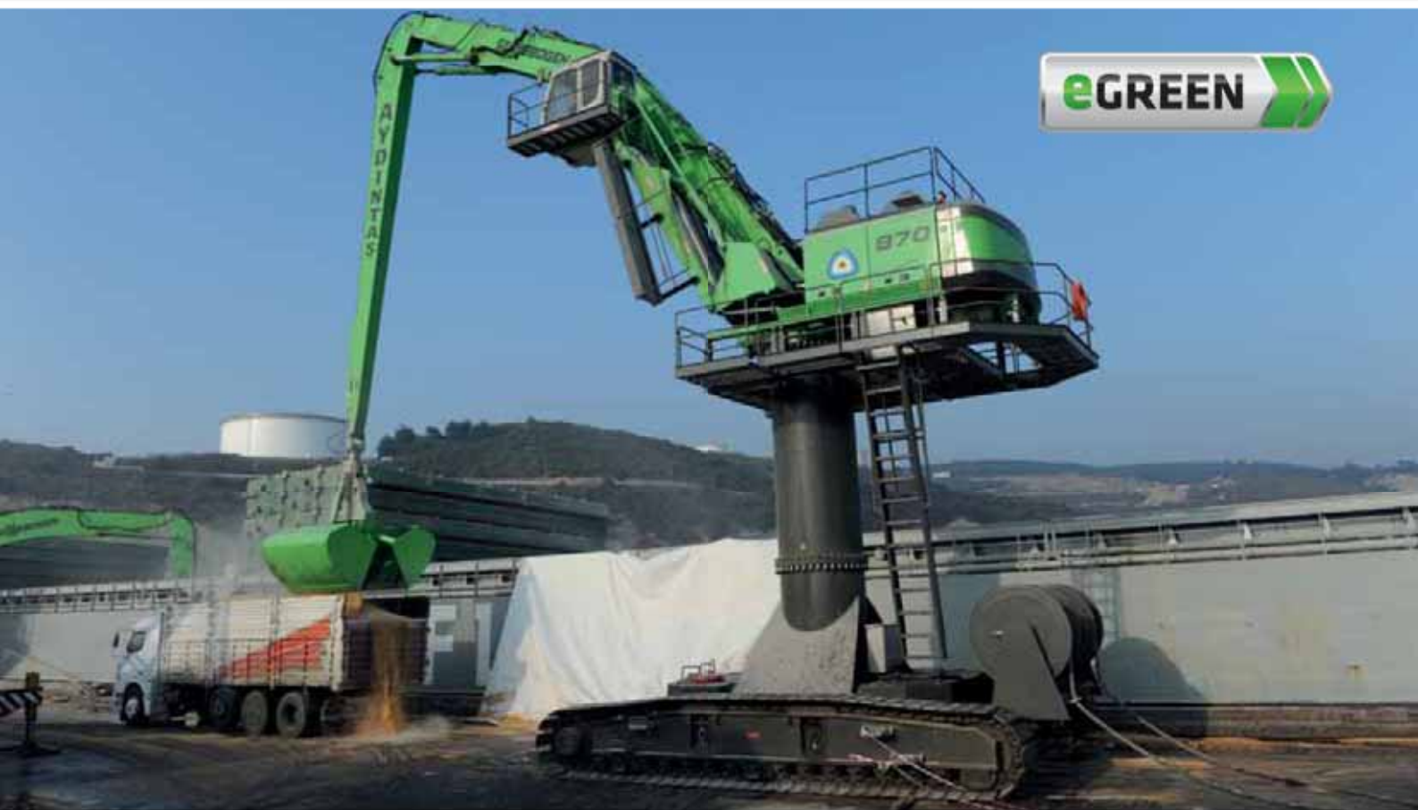
870 Crawler Electro - 3 m pylon, B23-equipment, light weight clamshell grab, grain handling; Turkey 870 Raupe Elektro - 3 m Pylon, Ausrüstung B23, Leichtgut-Zweischalengreifer, Getreideumschlag; Türkei
