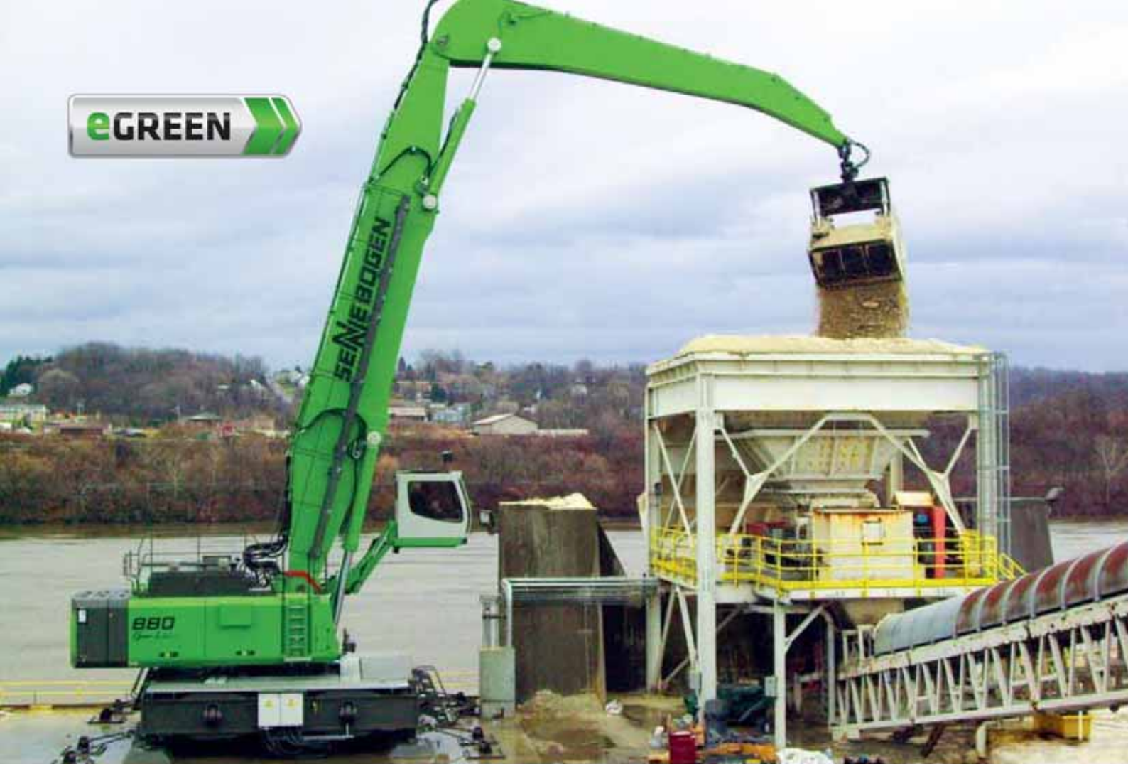
880 classic Electro - 4-point-pedestal, K20-equipment with 7 m 3 clamshell grab, gypsum handling; USA 880 classic Elektro - 4-Punkt Untergestell, Ausrüstung K20 mit 7 m 3 Zweischalengreifer, Gipsumschlag; USA
