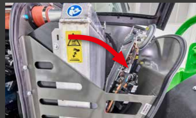
2 Très bon accès au radiateur grâce au condenseur de climatisation pivotant.
