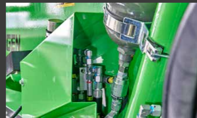
4 Les organes de sécurité et composants électriques importants sont protégés et accessibles de l'extérieur, même si le bras télescopique est abaissé.
