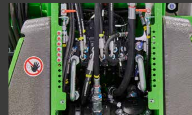
6 Accès idéal au bloc de commande principal, au réservoir d'huile hydraulique et au filtre de retour.
