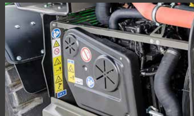
1 Accès facile à tous les points d'entretien grâce au moteur installé transversalement.
