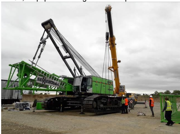
Assemblage des trains de chenilles et de la flèche à l'arrivée de la machine sur site d'exploitation
