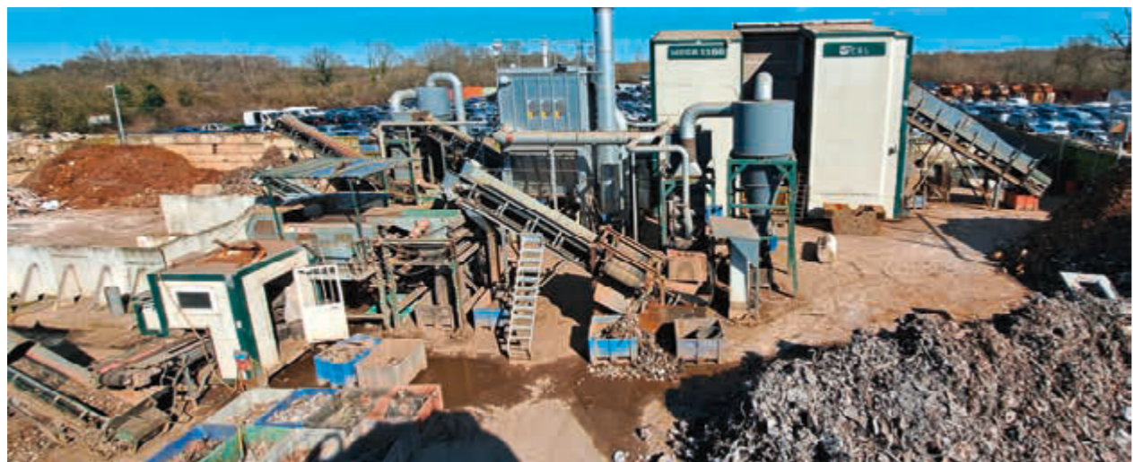
Depuis 2022, CRL Coutras exploite une ligne de broyage déployée à partir d'un broyeur à marteaux Panizzolo Mega 1100 de 500 ch.
