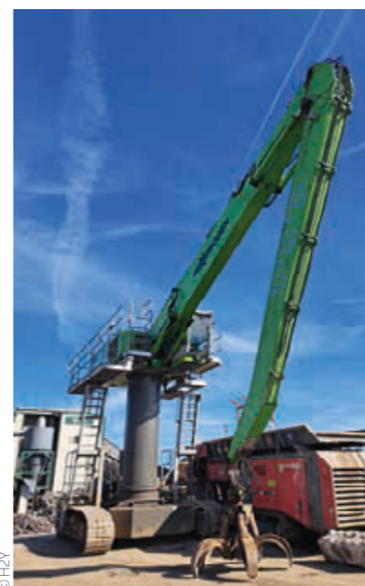
Chargée d'alimenter le broyeur, la pelle de manutention Sennebogen 835 affiche 20 m de portée. Son châssis monté sur pylône de 4,5 m est doté d'un enrouleur de câble (40 m) pour assurer l'alimentation de son moteur électrique de 200 kW.
