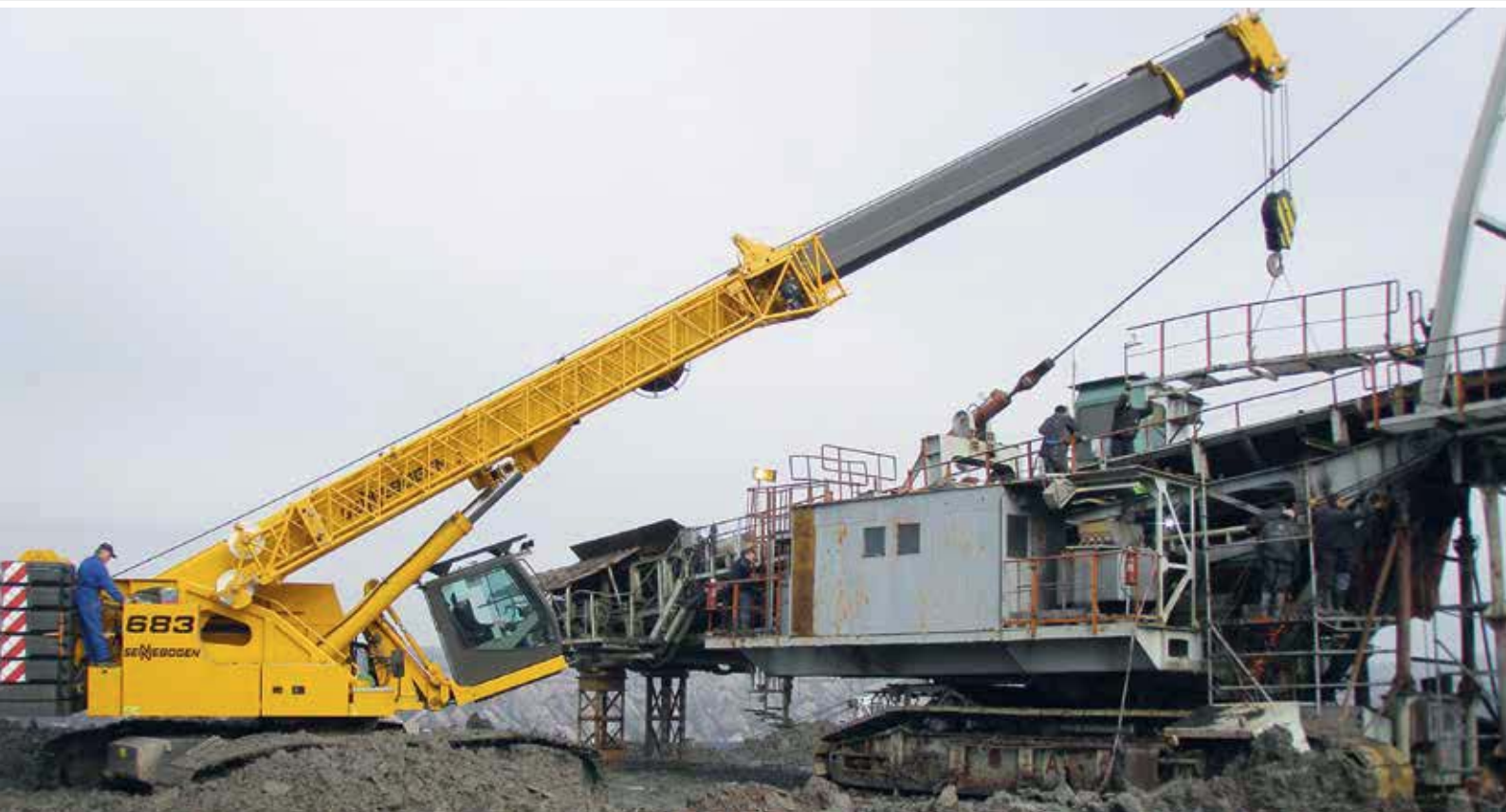
683 R - open-pit service crane on difficult terrain 683 R - Service-Kran im Tagebau auf schwierigem Boden
