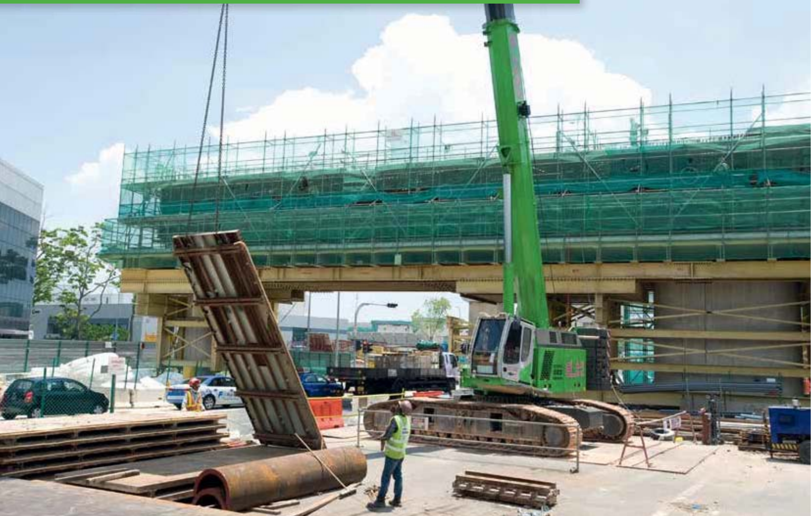
683 R - safety on narrow urban construction sites, with fast telescoping wind outriggers, no depositing; Singapore 683 R - Sicherheit auf engen Stadtbaustellen, bei Wind Ausleger schnell einteleskopiert, kein Ablegen; Singapur
