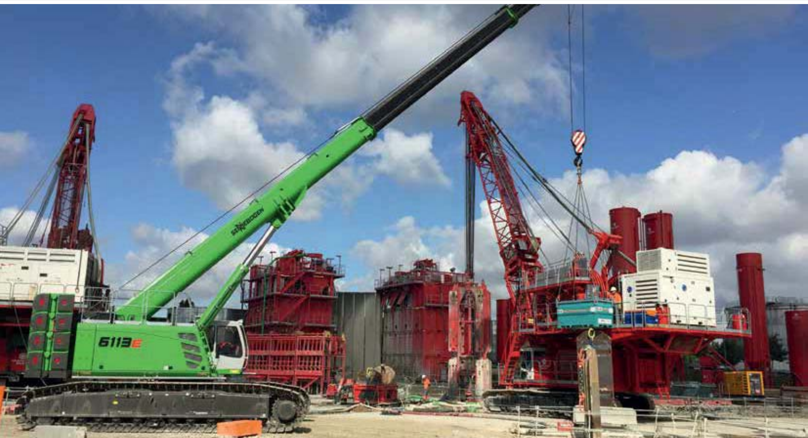
6113 R - high stability on any site surface with Star-Lifter broad gauge chassis; Germany 6113 R - hohe Standfestigkeit auf jedem Baustellenuntergrund mit Star-Lifter Breitspurunterwagen; Deutschland
