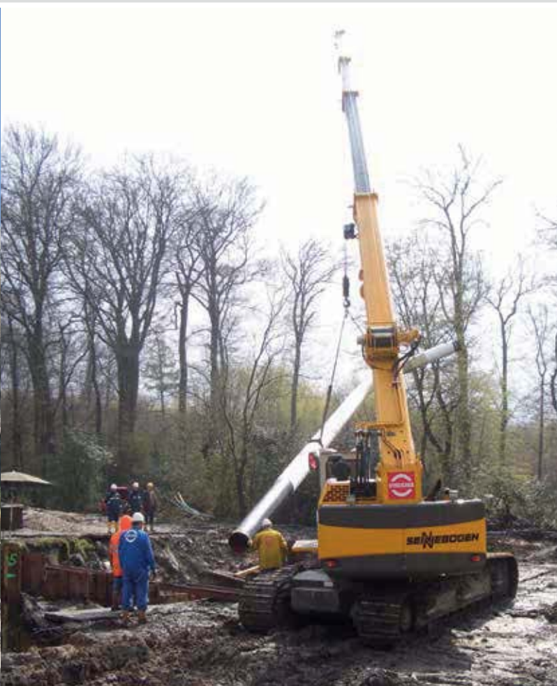
643 R - heavy loads on difficult terrain; Germany 643 R - Verfahren mit Last auf schwierigem Terrain; Deutschland
