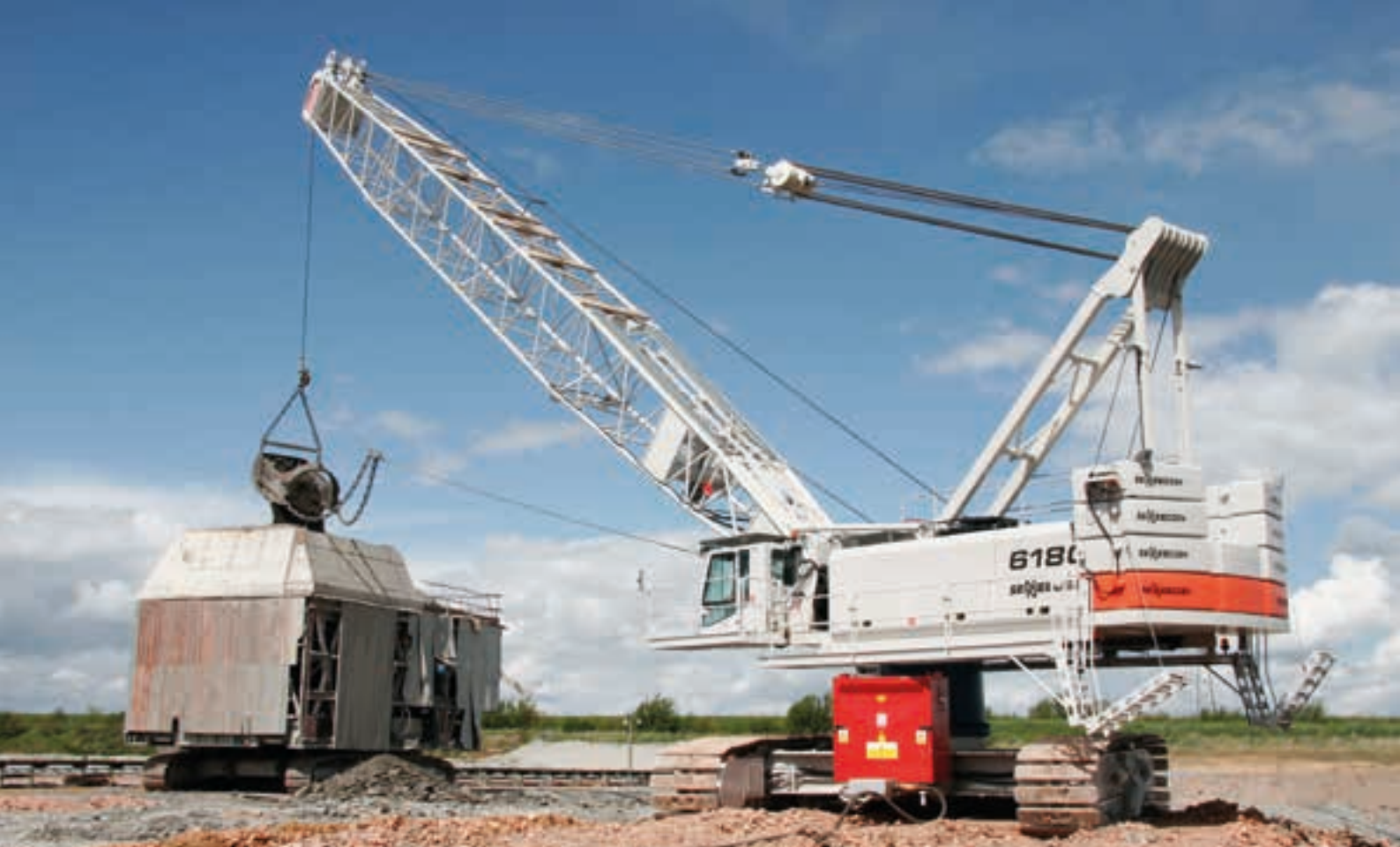
6180 HD - Dragline operation with electric engine; UK 6180 HD - Schleppschaufeleinsatz mit Elektromotor; Großbritannien
