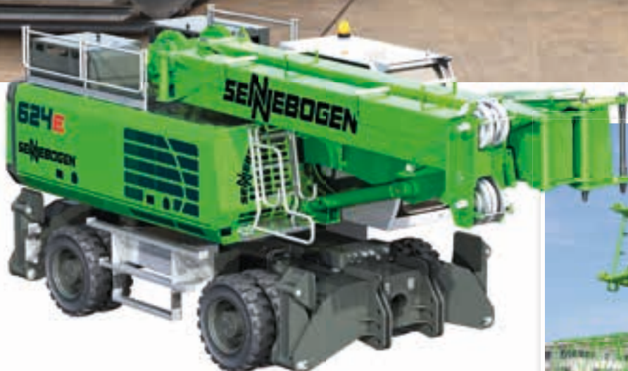
624 E: Foldable booms for transport 624 E: Für den Transport abklappbarer Ausleger
