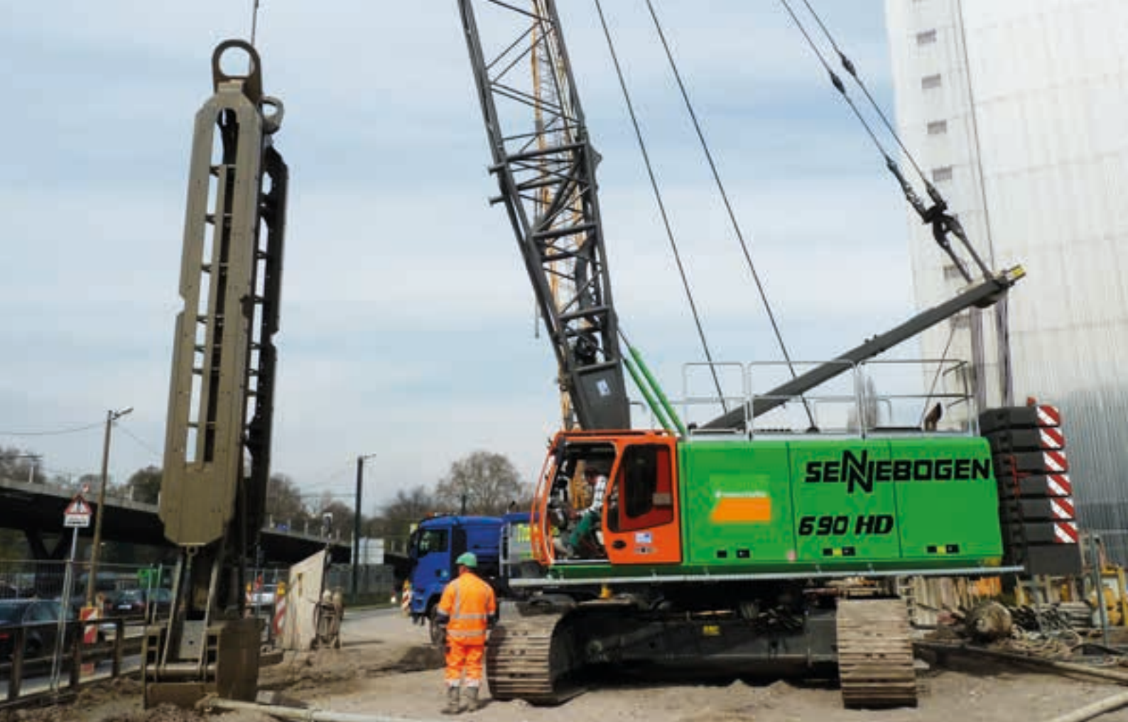
690 HD – Foundation with diaphragm wall grab; Germany 690 HD – Tiefbau mit Schlitzwandgreifer; Deutschland
