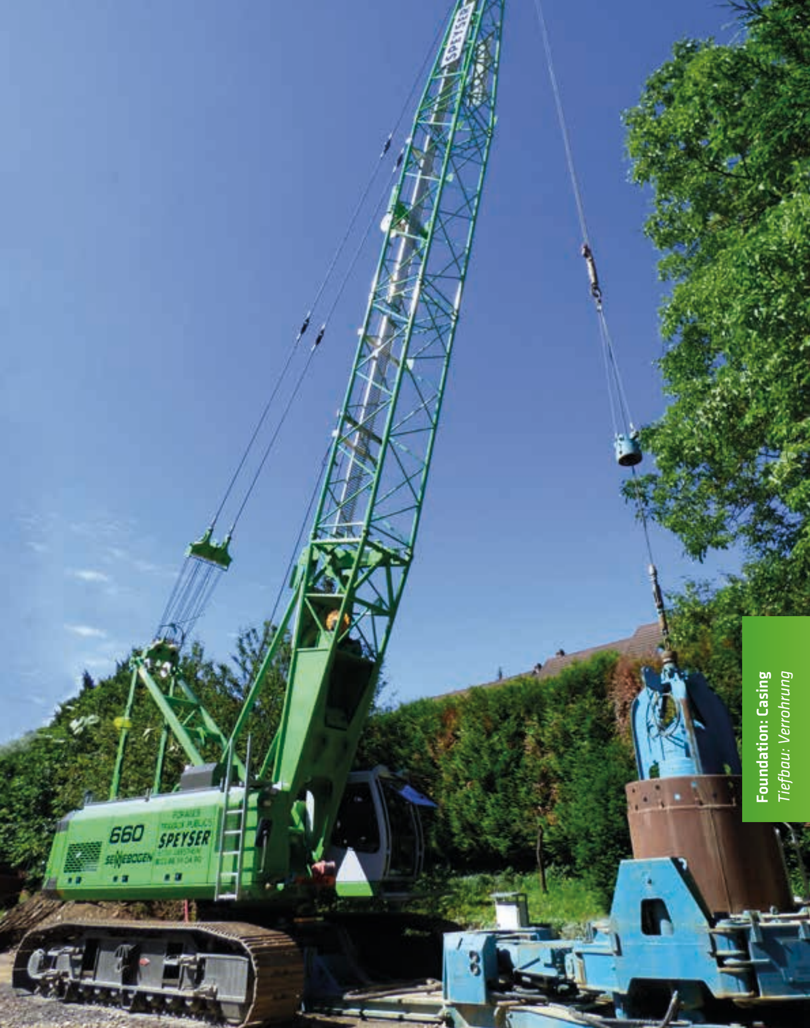
660 HD – Well digging with casing oscillator; France 660 HD – Brunnenbau mit Verrohrungsmaschine; Frankreich
