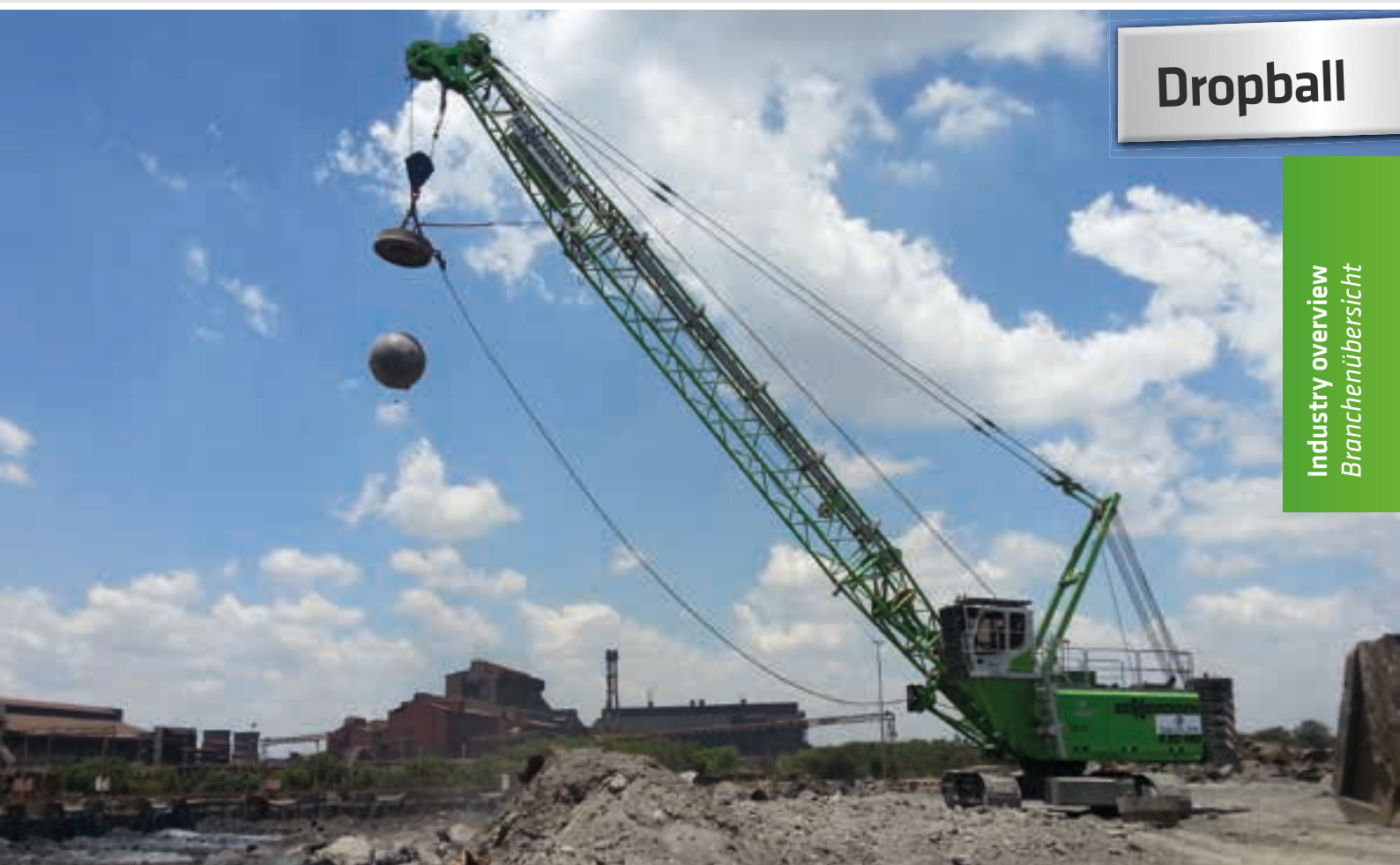
690 HD - Slag recycling with dropball; South Africa 690 HD – Schlackezerkleinerung mit Dropball; Südafrika
