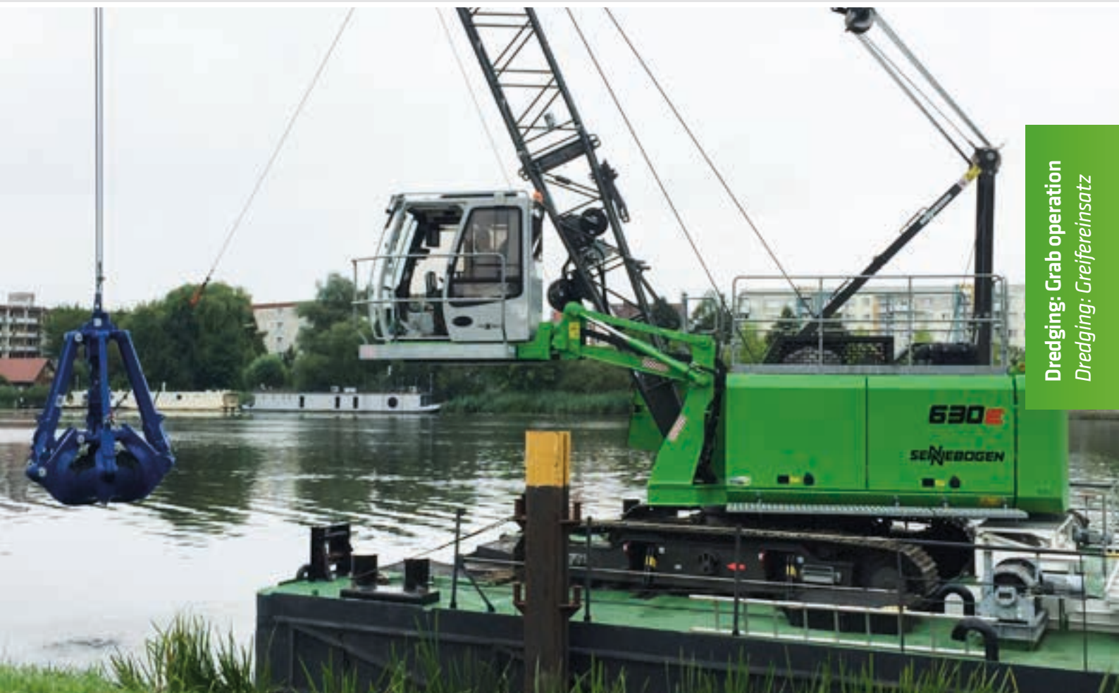
630 E – Dredging works for hydro construction with orange peel grab, cab can be elevated; Germany 630 E – Dredgingearbeit im Wasserbau mit Mehrschalengreifer, Kabinenerhöhung; Deutschland
