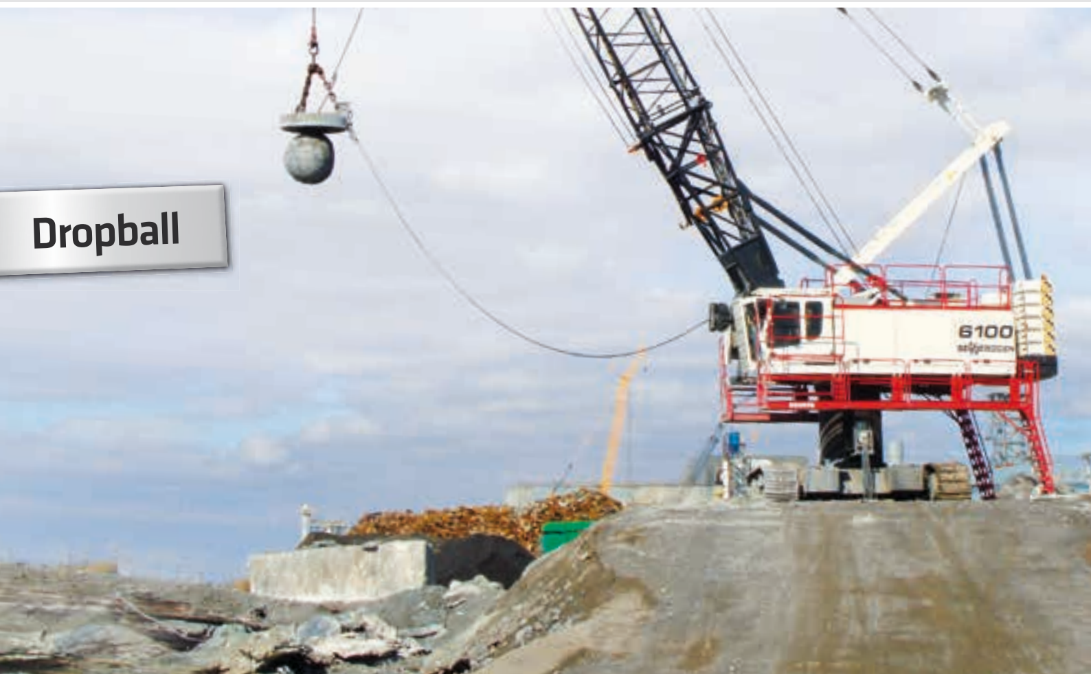
6100 HD - with electro-hydraulic drive, slag crushing with magnet plate; USA 6100 HD - mit elektrohydraulischem Antrieb, Schlackezerkleinerung mit Magnetplatte; USA
