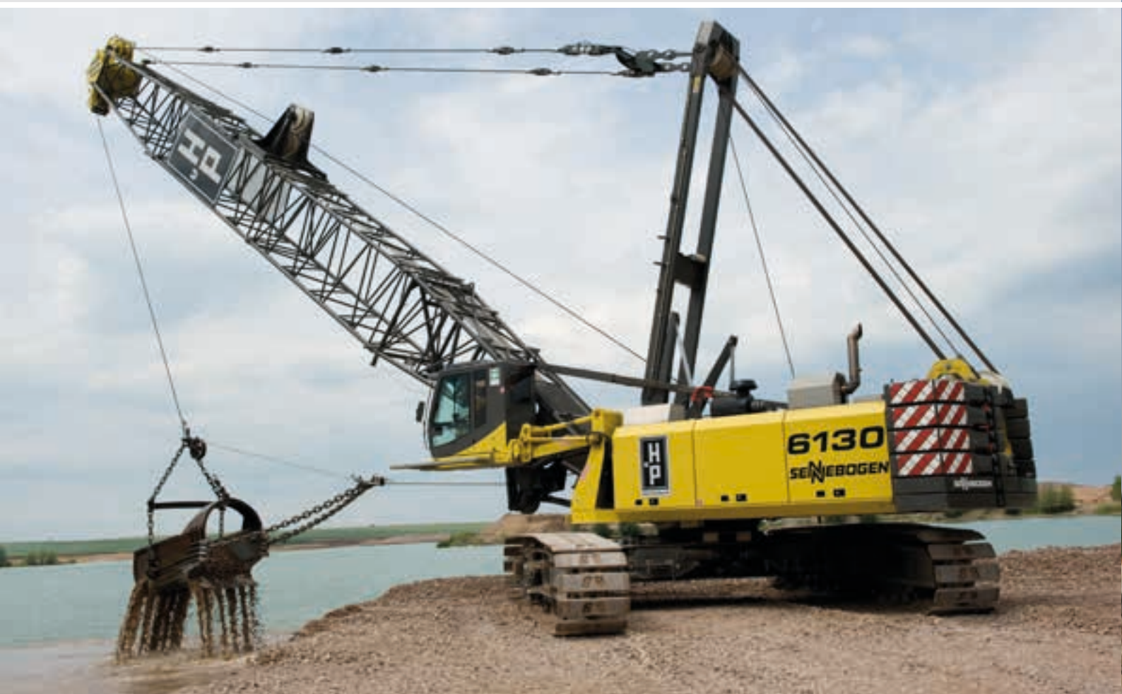
6130 HD – Gravel quarrying with dragline bucket; Germany 6130 HD – Kiesgewinnung mit Schleppschaufel; Deutschland
