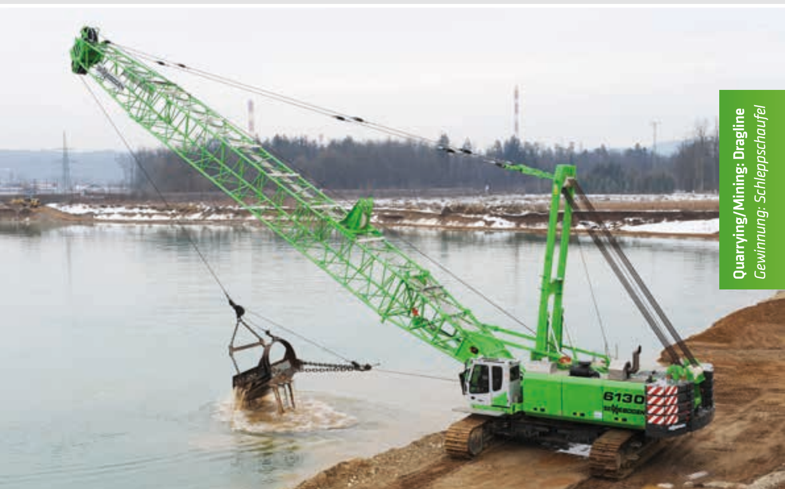
6130 HD – Gravel quarrying with dragline bucket; Austria 6130 HD – Kiesgewinnung mit Schleppschaufel; Österreich
