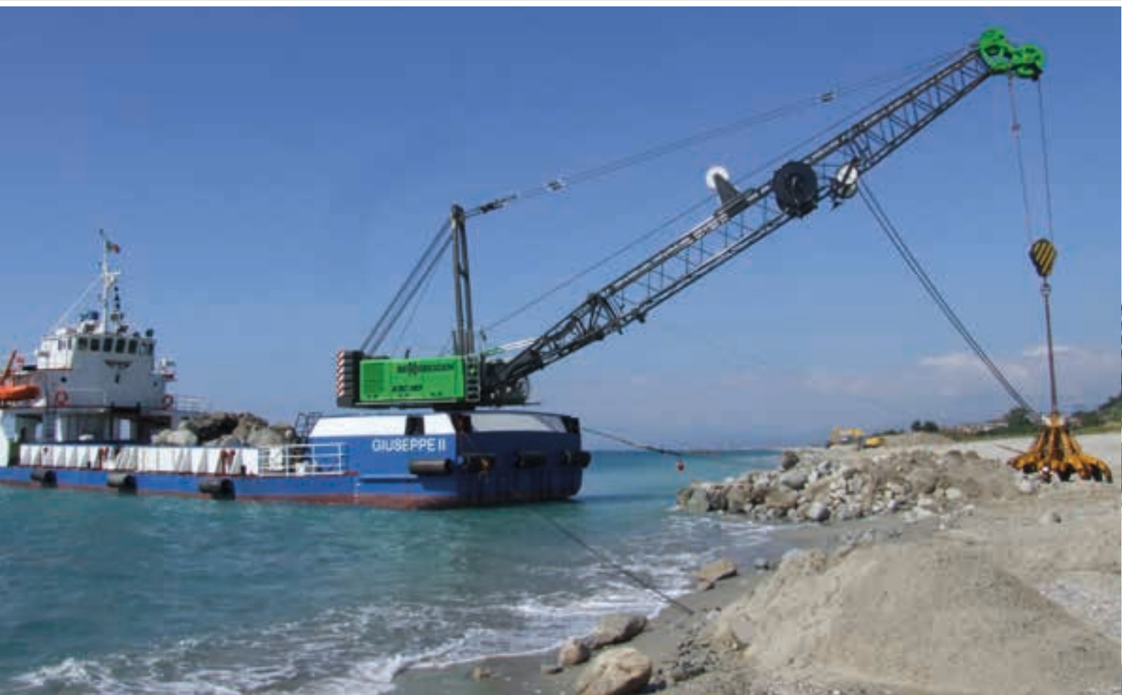
690 HD – Grab operation for coastal protection; Italy 690 HD – Greifereinsatz zur Küstenbefestigung; Italien
