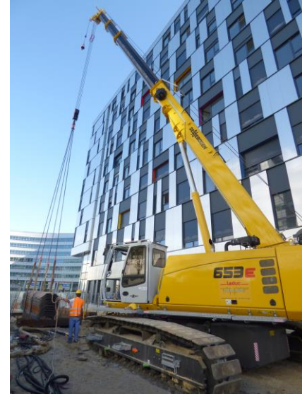
La 653 se déplace et télescope sa flèche en charge, sur 360°.
