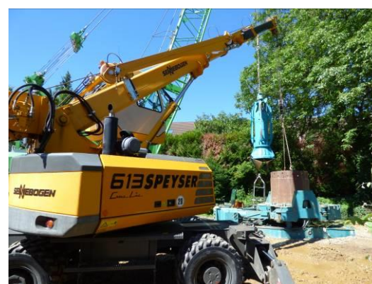
La grue télescopique SENNEBOGEN 613M est l'outil de manutention idéal sur des chantiers exigü en milieu urbain
