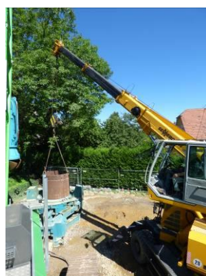
La grue télescopique SENNEBOGEN 613M est l'outil de manutention idéal sur des chantiers exigü en milieu urbain
