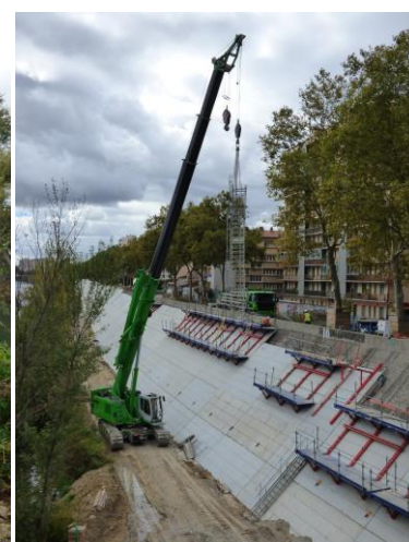
Déplacement en charge, télescopage de la flèche en charge, tableau de charge sur 360°, y compris chenilles rétractées ; les performances uniques des grues SENNEBOGEN se sont révélées des atouts indispensables pour ce chantier très spécifique.
